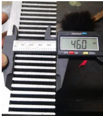
Figura 81. Medida del disipador: Altura de Aletas, 46mm y Ancho de Aletas, 2.6mm
