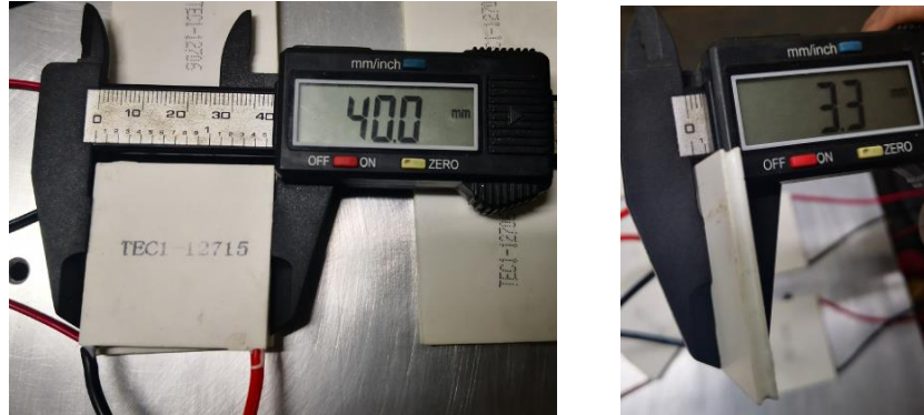
Figura 77. Dimensiones de la celda Peltier 40x40mm y 3.3mm de espesor
