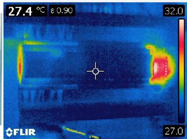
Figura 93. Termo grama del micro PLC y el convertor A/mA
