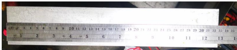
Figura 78. Medida del disipador: Base, 33cm
