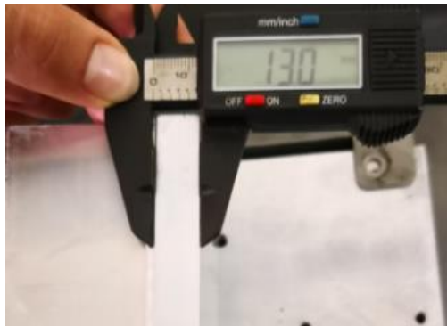
Figura 84. Medida del disipador: Espesor de Núcleo Central, 13 mm
