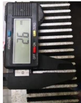
Figura 81. Medida del disipador: Altura de Aletas, 46mm y Ancho de Aletas, 2.6mm
