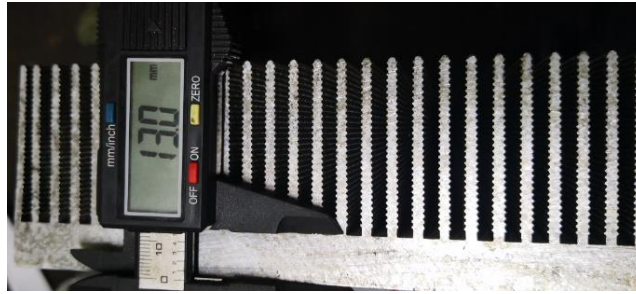
Figura 80. Medida del disipador: Espesor de Núcleo Central, 13mm
