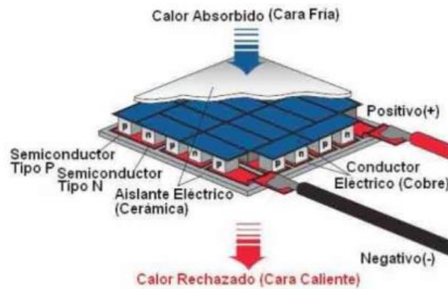
Figura 5. Componentes de una celda peltier
