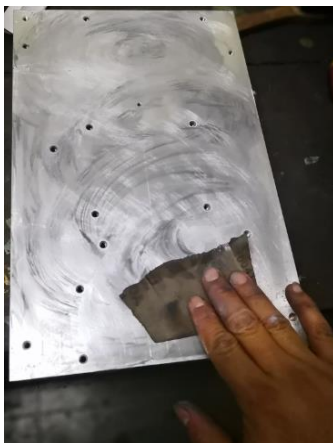
Figura 82. Preparación de Superficie
