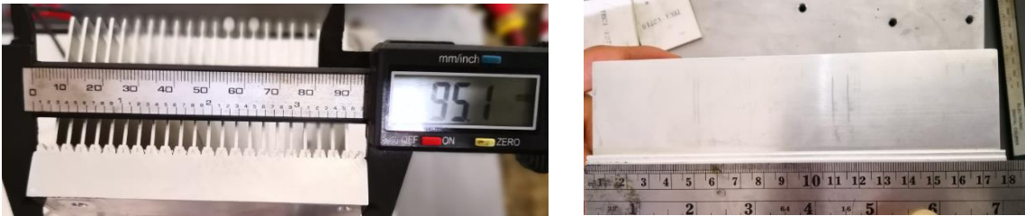
Figura 83. Medida del disipador: Ancho, 9.5 cm y Base, 18cm
