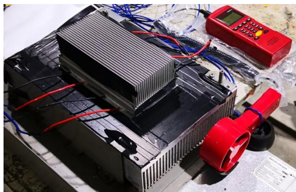
Figura 88. Modulo termoelectrico preparado para realizar ensayos de funcionamiento
