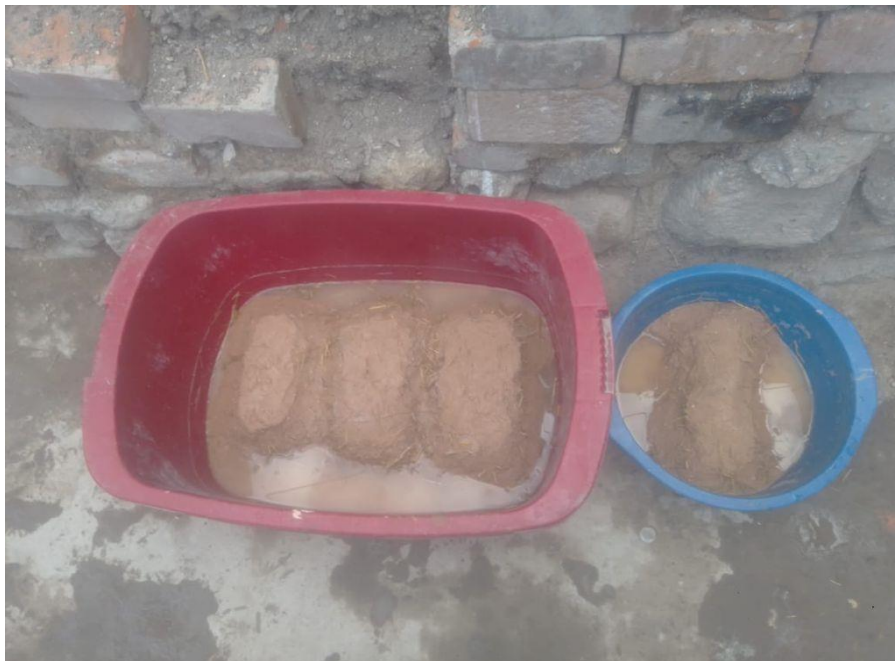
FOTOGRAFÍA 6: Ensayo de Absorción
