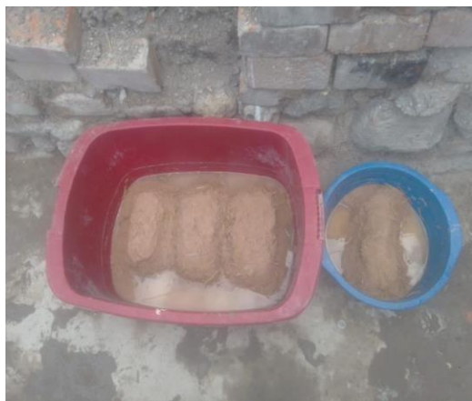
Figura 29: Ensayo de Absorción Fuente: Elaboración propia
