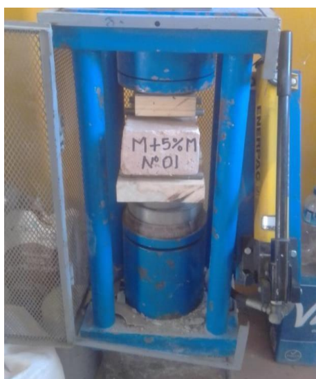
Figura 21: Ensayo de Flexión Fuente: Elaboración propia
