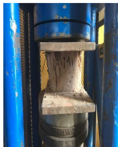
Figura 15: Ensayo de compresión Fuente: Elaboración propia
