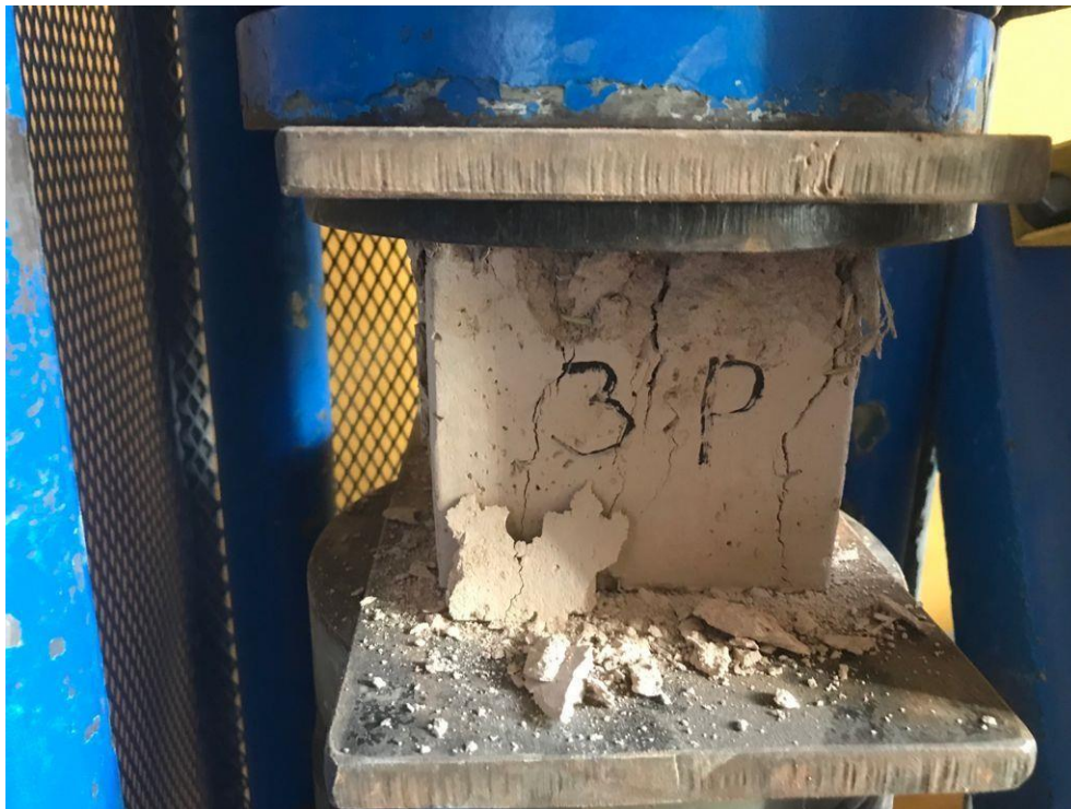
FOTOGRAFÍA 4: Rotura de especímenes (COMPRESIÓN)
