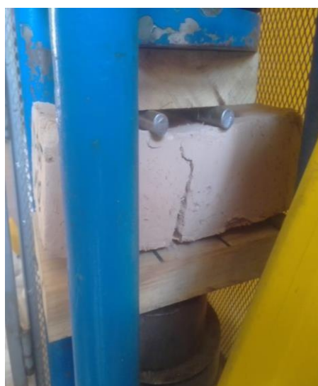
Figura 22: Ensayo de Flexión Fuente: Elaboración propia
