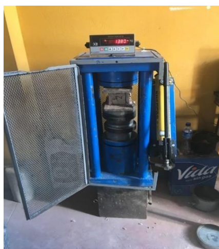
Figura 14: Ensayo de compresión Fuente: Elaboración propia
