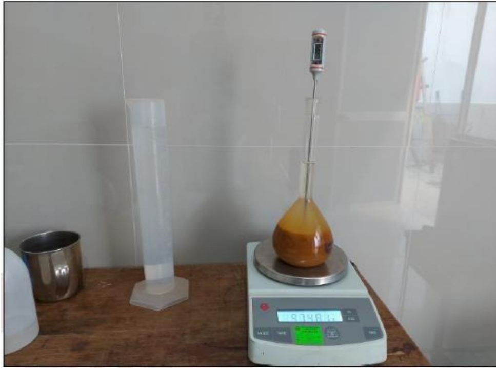
Figura 12. Personal técnico realizando el ensayo de gravedad específica.
