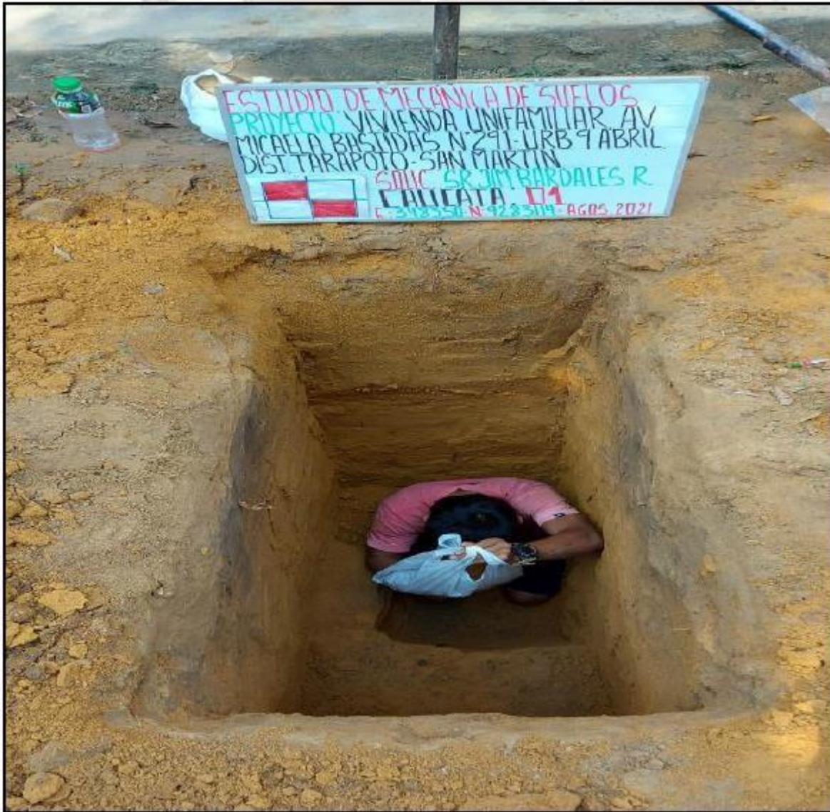
Figura 9. Extracción de muestras para los ensayos de laboratorio.
