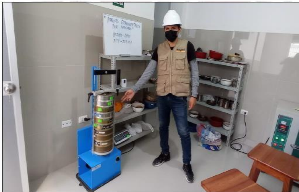
Figura 11. Análisis granulométrico por el método de tamizado
