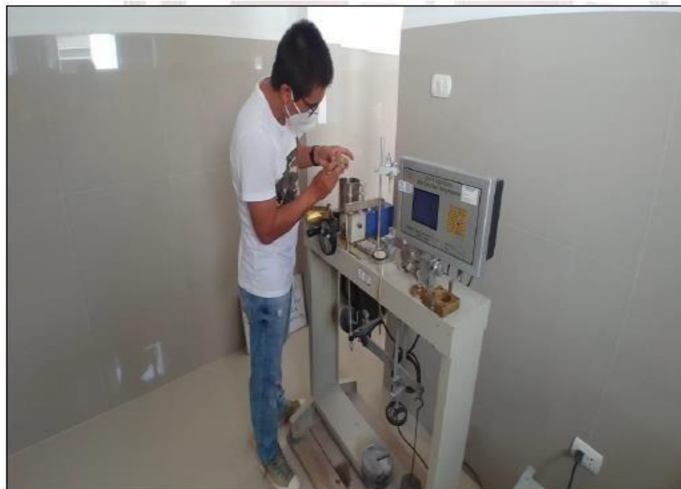
Figura 13. Se observa al personal técnico realizando el ensayo de corte directo residual
