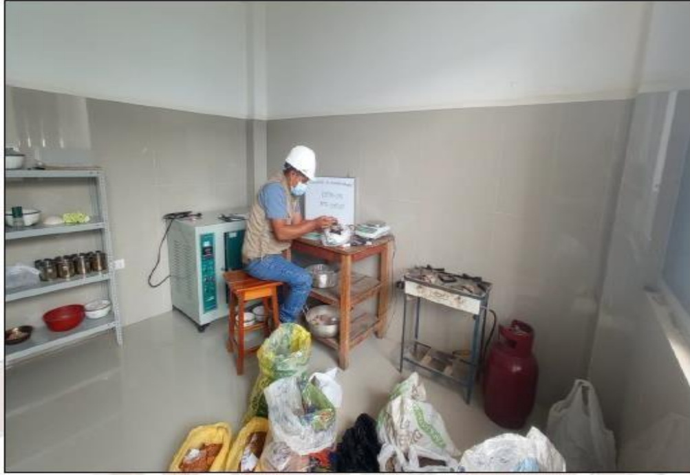
Figura 10. Personal realizando el ensayo de porcentaje de humedad natural
