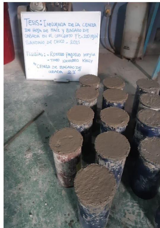
Figura 15: Elaboración de probetas cilíndricas
