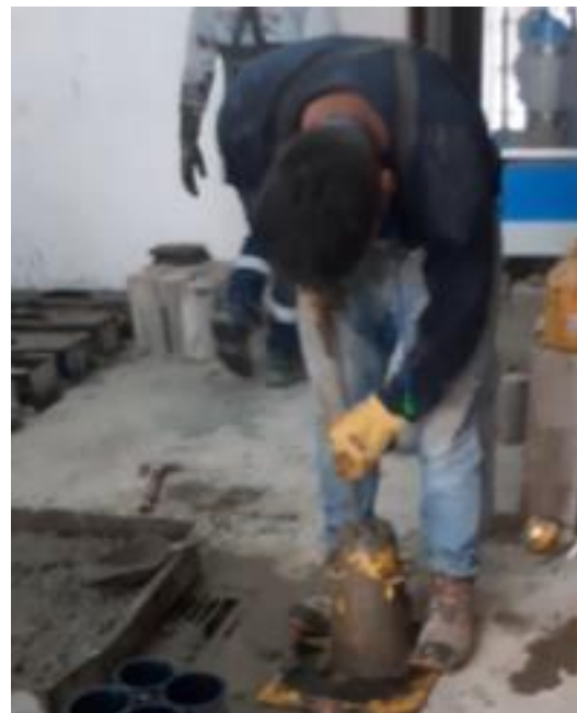
Figura 11: Compactado por cada capa con la varilla de acero
