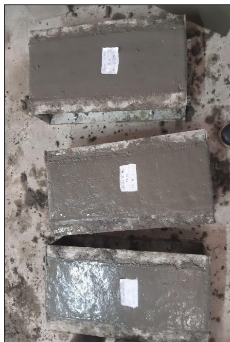
Elaboración de vigas prismáticas
