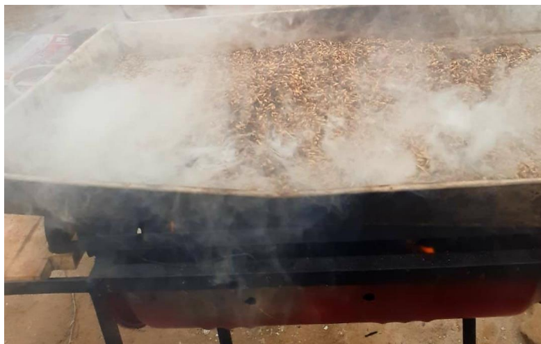
Figura 7: Incineración del bagazo de cebada
