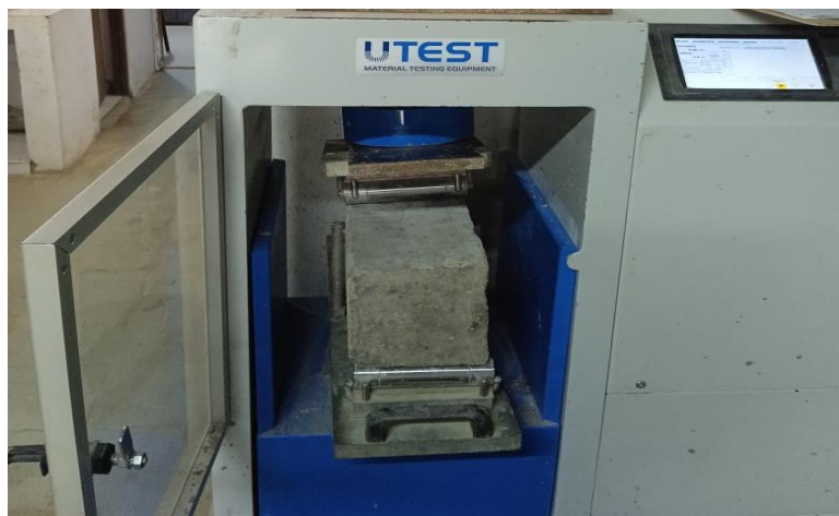
Figura 23: Ensayo de resistencia a la flexión del diseño patrón a los 28 días.
