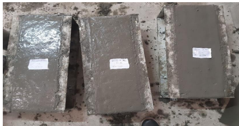
Figura 22: Vigas de concreto del patrón, y los distintos porcentajes de CHM y CBC.
