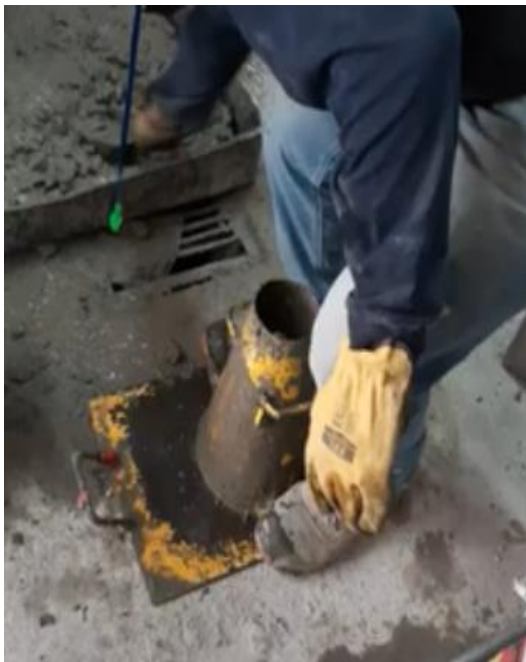
Figura 10: Llenado del cono Abrams
