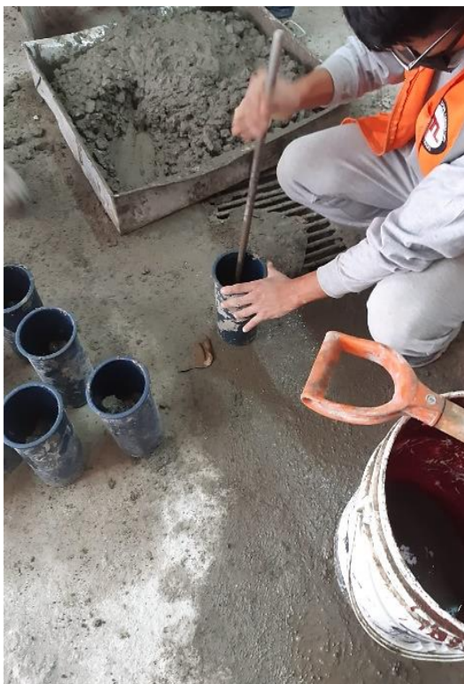
Figura 14: Elaborado de las probetas cilíndricas de acuerdo a la NTP 339.183
