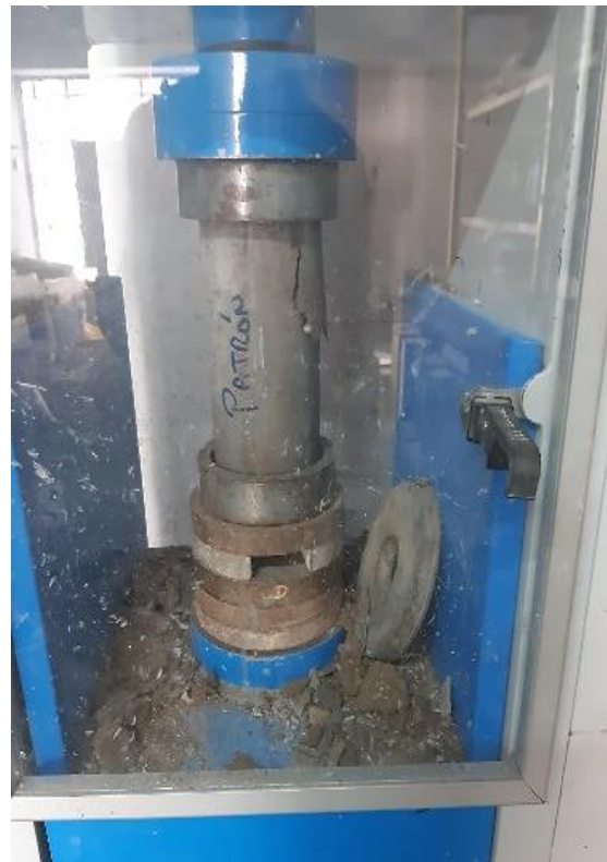
Figura 17: Fractura diagonal Modo V, según la NTP 339.034
