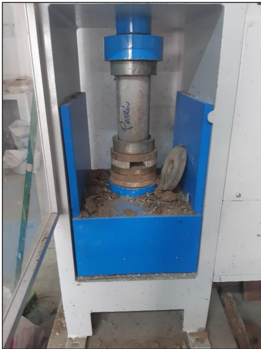
Ensayo de Resistencia a Compresión
