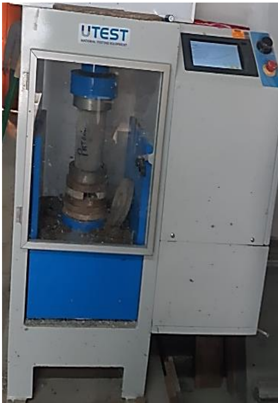
Figura 16: Colocado de la probeta en la compresora
