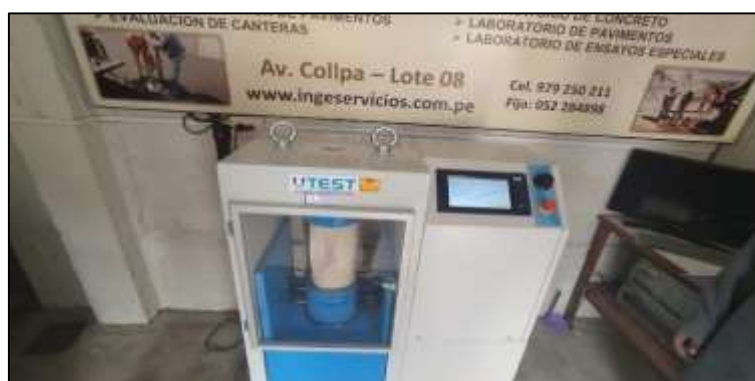
Figura 11: Resistencia a la compresión
