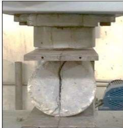
Figura 5 – Rotura del ensayo de tracción indirecta
