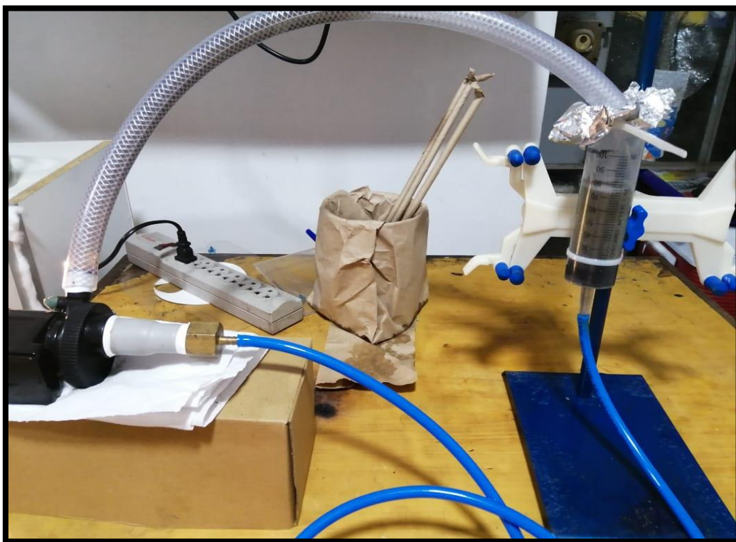
Anexo 40. Filtro en funcionamiento con la membrana de 6g
