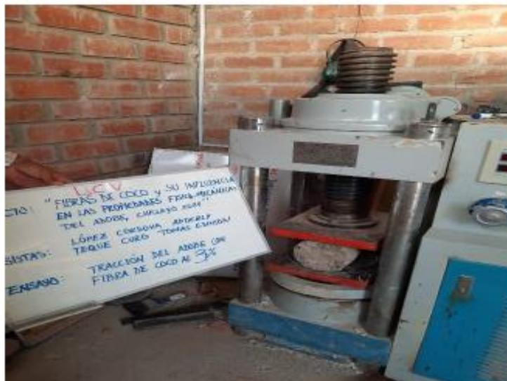
Fotografía N° 05. Compresión longitudinal de cada una de las probetas de la muestra patrón (3% de fibras de coco) de adobe.
