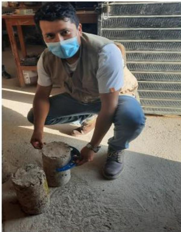
Fotografía N° 01. Dimensionamiento del diámetro de la probeta de adobe.
