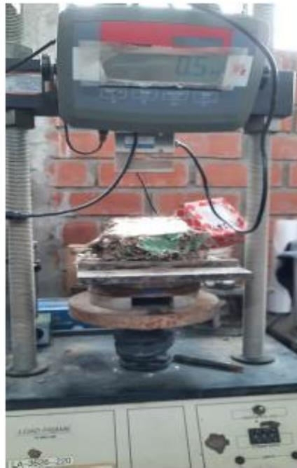
Fotografía N° 04: compresión de muestra de adobe hasta su punto máximo de soporte
