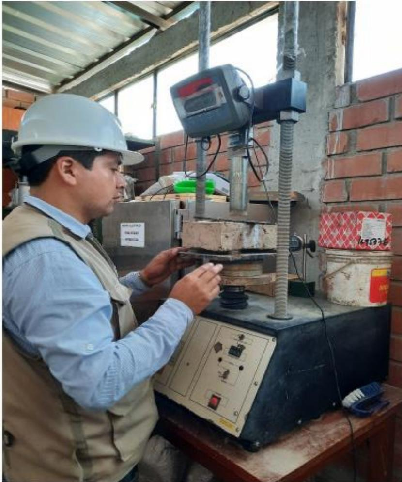
Fotografía N°02. Ensayo a flexión de la Muestra IV del adobe patrón.
