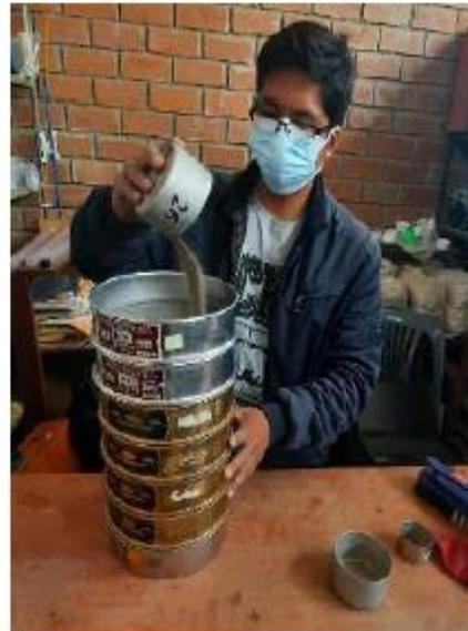
Fotografía N° 04. Secado del material al horno a  $110 \pm 5^{\circ}\text{C}$ , transcurrido 24h, el material se hace pasar por las mallas N° 10, 20, 40, 60, 140, 200.
