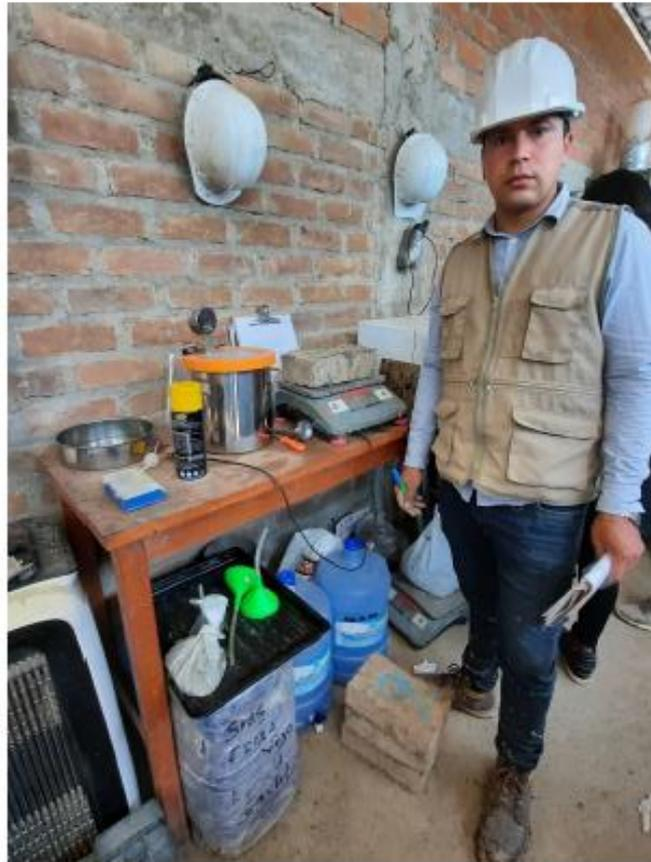
Fotografía N°01. Peso de las unidades de adobes seco antes del ensayo.
