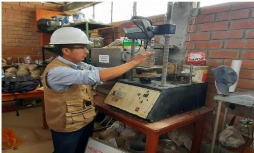
Fotografía N° 01: se realiza el dimensionamiento de cada muestra de adobe a ensayar.
