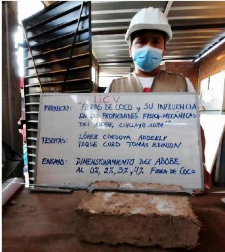
Fotografía N°02. Dimensionamiento de las unidades de adobes con fibras de coco al 0%, 2%, 3% y 4%.
