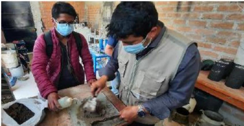
Fotografía N° 06. Con una porción de muestra significativa, se le adhiere agua destilada y sobre una superficie plana se mezcla hasta formar una material homogénea.
