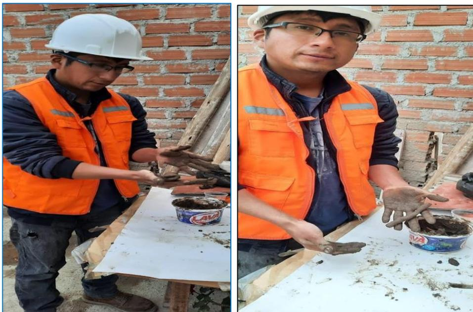
**Figura N° 06:** Prueba de cinta de barro
