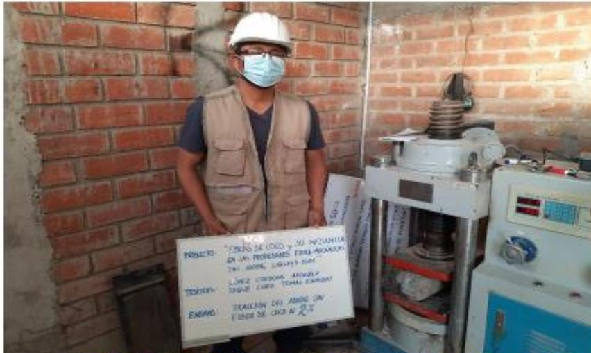
Fotografía N° 04. Compresión longitudinal de cada una de las probetas de la muestra patrón (2% de fibras de coco) de adobe.
