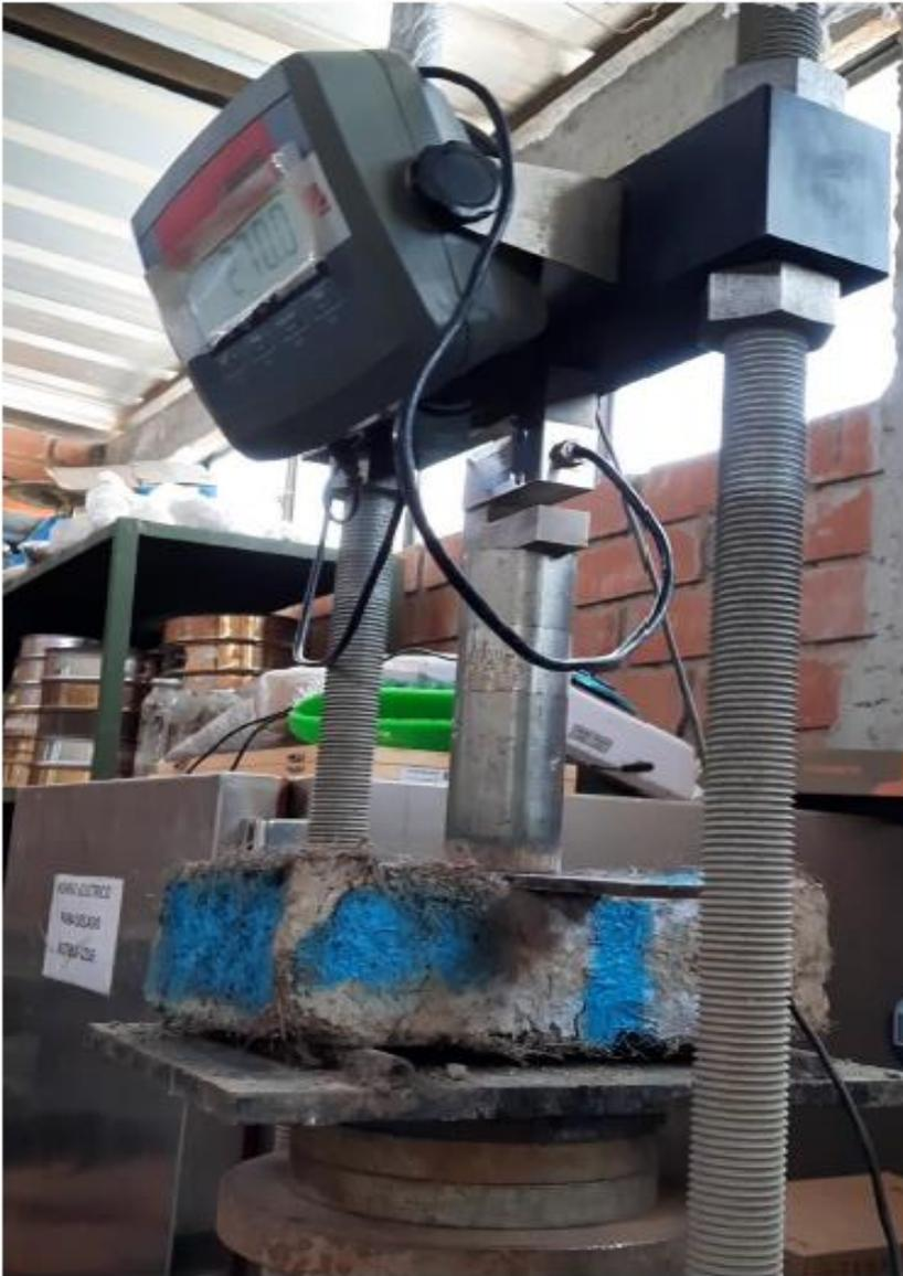
Fotografía N°04. Ensayo de la muestra de adobe con incorporación de fibra de coco al 3%
