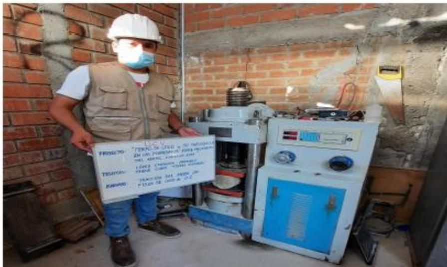
Fotografía N° 03. Compresión longitudinal de cada una de las probetas de la muestra patrón (0% de fibras de coco) de adobe.
