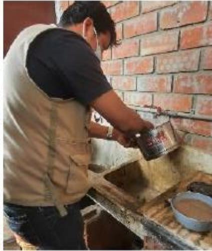
Fotografía N° 03. Peso de tara + muestra seca y posterior lavado del material, haciendo uso de una malla N° 200.
