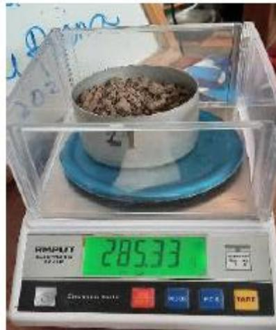
Fotografía N° 02. Muestra sometida al horno a  $110 \pm 5^\circ\text{C}$  y transcurrido 24h se pesó el material para el cálculo del porcentaje de humedad.
