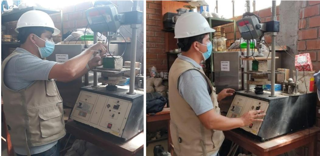
**ANEXO 27:** Ensayo de resistencia a la compresión
