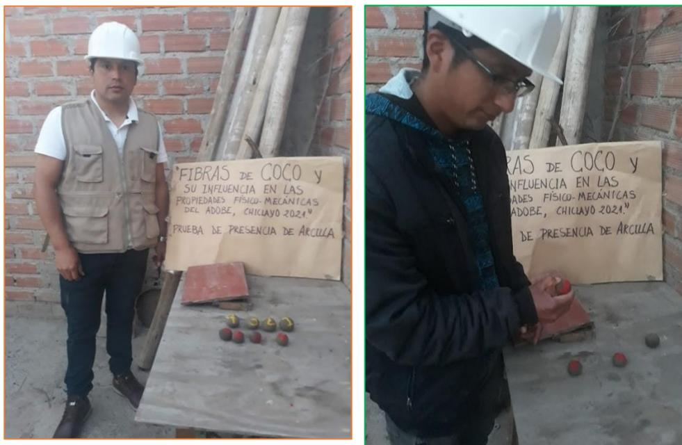
**Figura Nº 08:** Prueba presencia de arcilla después de 48 horas de secado.
