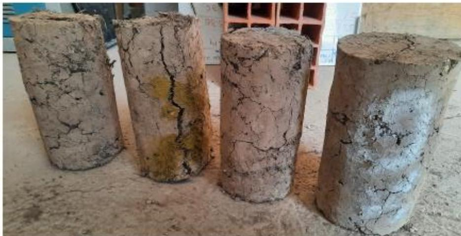
Fotografía N° 07. Resultado de los ensayos a tracción.
