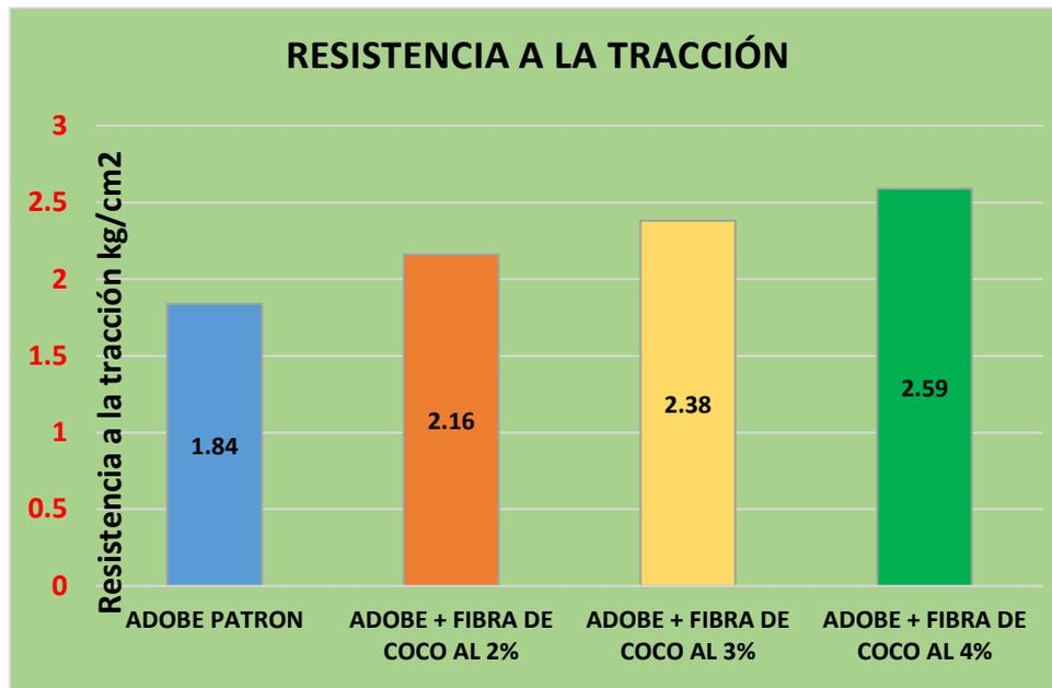
**Figura N° 23:** Resistencia a la tracción
