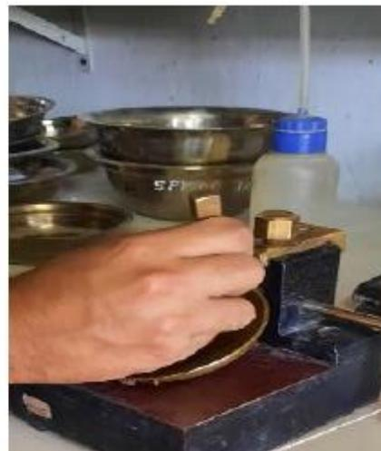
Fotografía N° 08. Transcurrido las 24h de reposo, se toma una porción para la copa casagrande para moldear con la espátula, para luego ranurar a la mitad.
