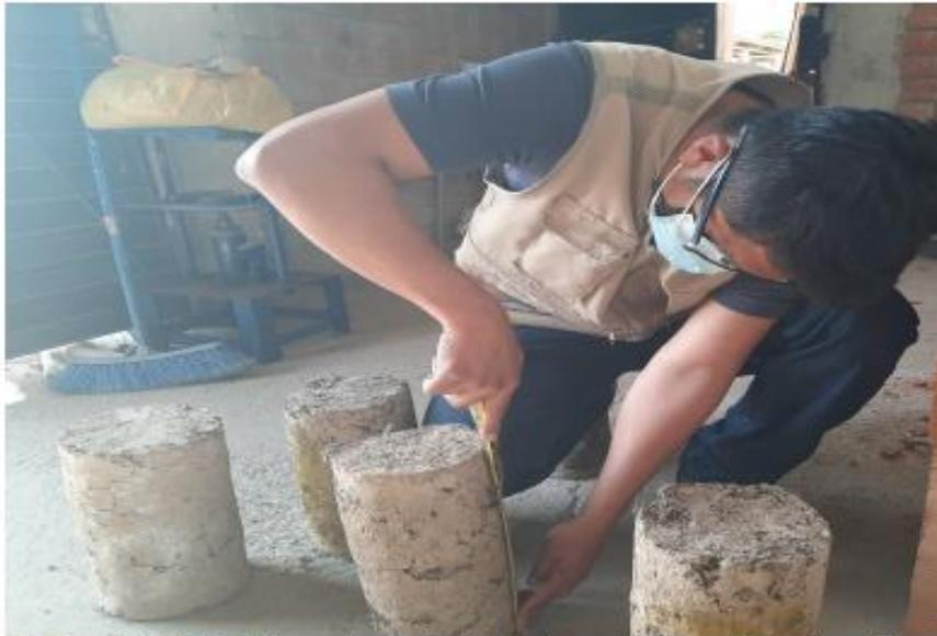
Fotografía N° 02. Dimensionamiento del largo de la probeta de adobe.
