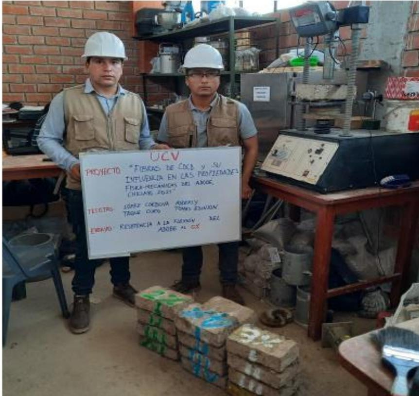
Fotografía N°01. Unidades de adobes con fibras de coco al 0%, 2%, 3% y 4%, para ensayar a flexión.
