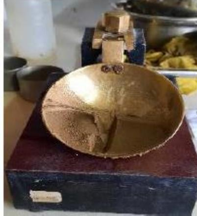
Fotografía N° 09. Se realiza el conteo de los golpes (varian entre los 15 a 35 golpes) , hasta que el material llega a unirse.
