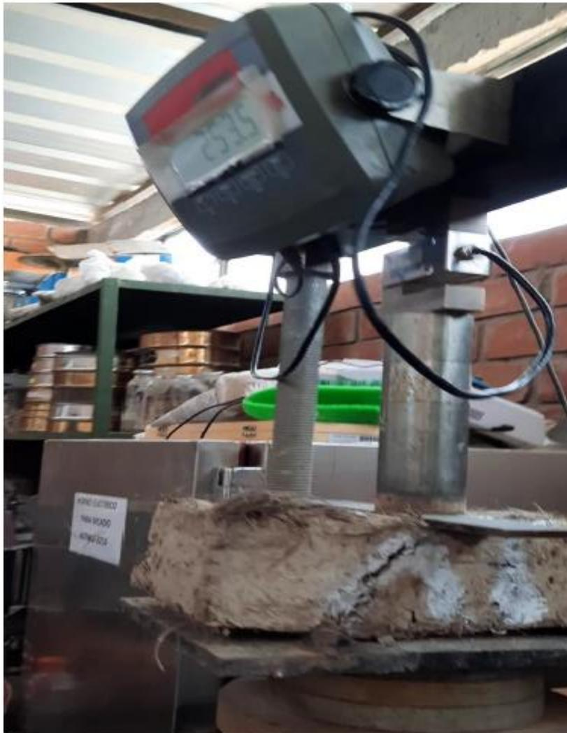
Fotografía N°03. Fuerza ultima a flexión de la muestra patrón IV en el instante de la falla.
