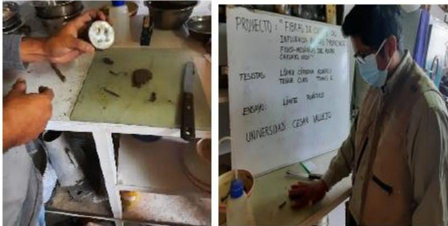
Fotografía N° 11. Con el material que se utilizó para el límite líquido se toma porciones en forma de hilos y con los dedos sobre el soporte hacer hilos hasta de 3mm de diámetro, con la notoriedad de que se tenga fisuras, para luego llevarlas al horno durante 24h y luego pesarlos.
