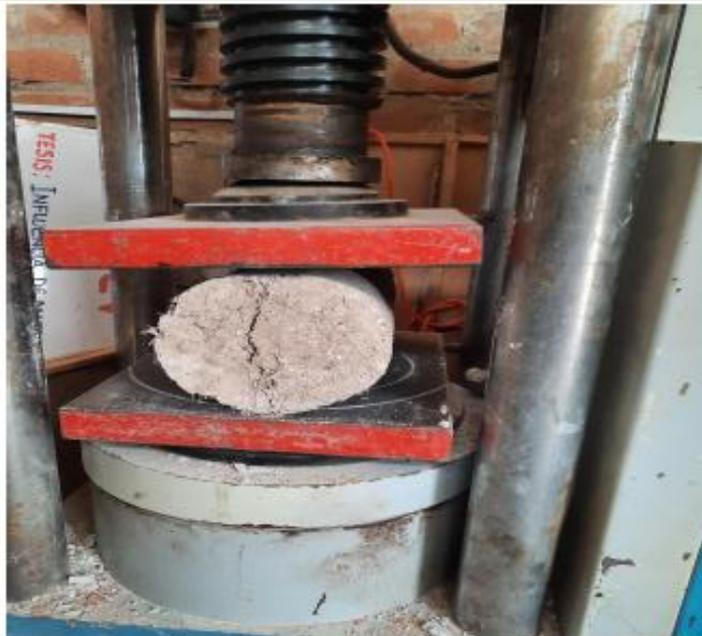
Fotografía N° 06. Muestra después de la compresión, fisuramiento en la parte central de abajo hacia arriba.
