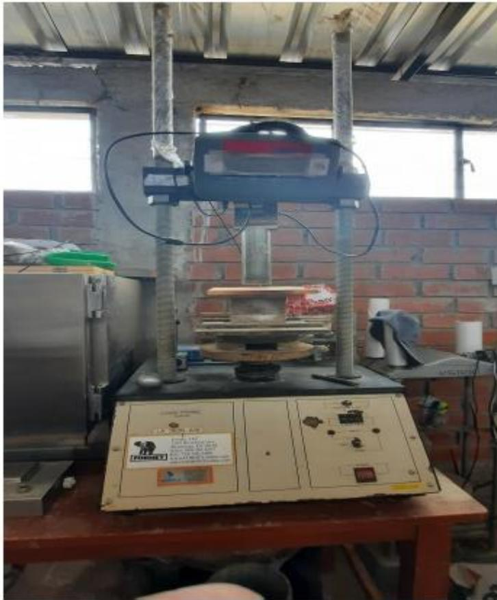
Fotografía N° 02: aplicación de la fuerza de compresión de las muestras de adobe con fibra de coco al 0%, y verificar la fuerza máxima aplicada hasta la rotura.
