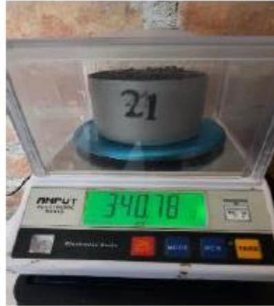
Fotografía N° 01. Peso de la tara vacía y peso de tara + muestra natural antes de someterlo a temperatura en el horno.
