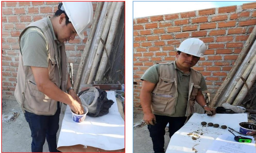
**Figura Nº 07:** Elaboración de las bolitas para realizar la prueba de presencia de arcilla
