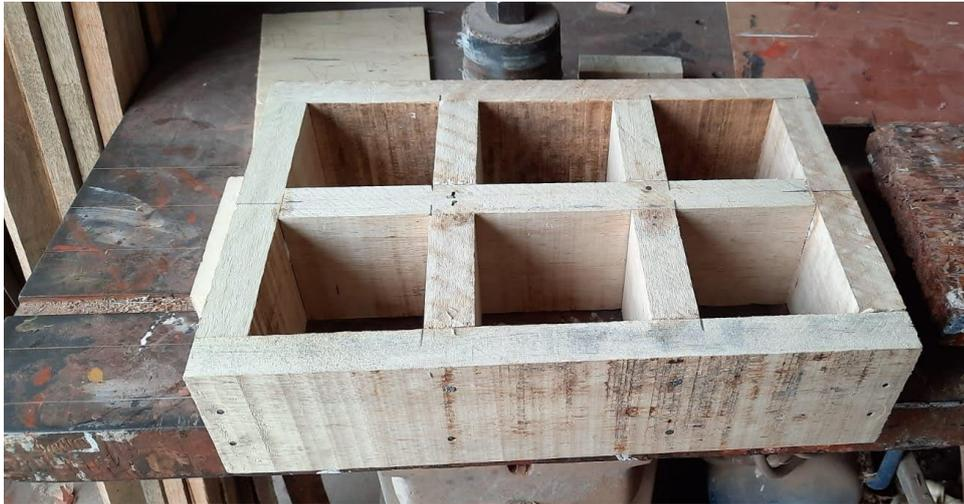
**Figura N° 10:** Fabricación moldes de los cubos de 10.2cmx 10.2cmx10.2cm
