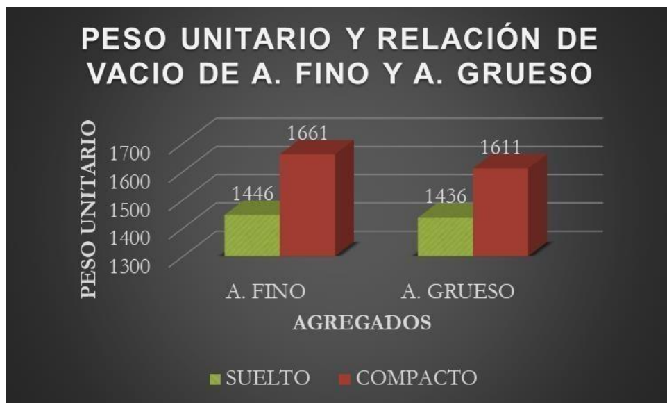
Figura N° 12 Peso unitario y relación de vacío de A. fino y A. grueso
