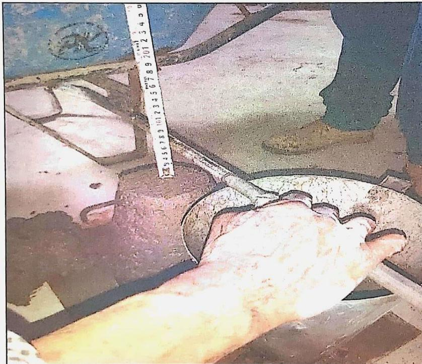
Realización de medición del ensayo de asentamiento "SLUMP" de 3" a 4" HORMIGÓN (CONCRETO). Método de ensayo para la medición del asentamiento del concreto de cemento Portland - NTP 339.035 - 2009.
