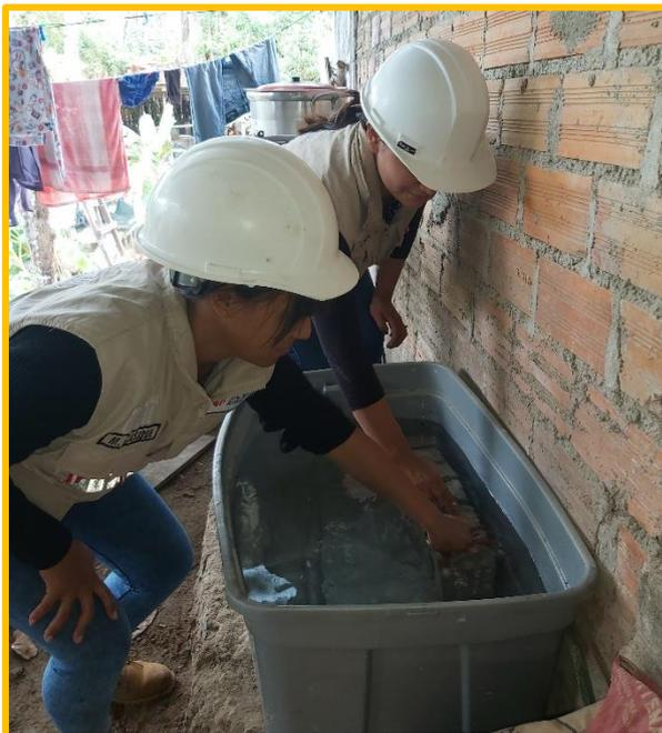
**FOTOGRAFÍA N° 8:** Curado de concreto en periodos de 7, 14 y 28 días.
