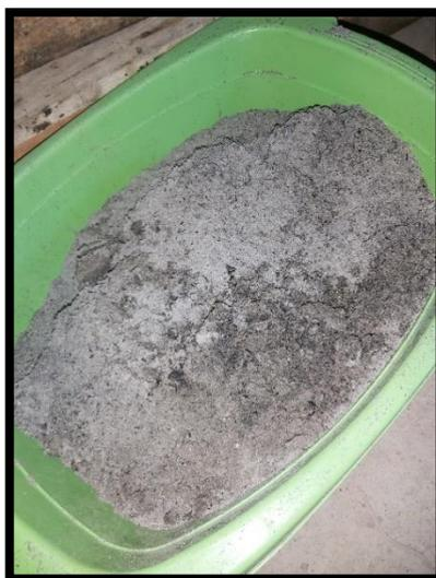
**Figura N° 6:** Ceniza procesada después de la incineración adecuada del bagazo de la caña de azúcar.
