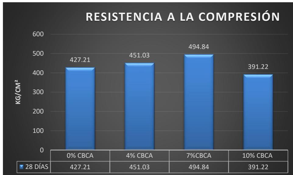
**Figura N° 12:** Resumen de resultados a los 28 días de los adoquines sometidos a esfuerzos de compresión con diseño  $f'c=380 \text{ kg/cm}^2$  y en proporciones de CBCA incorporadas al concreto, medidas en  $\text{kg/cm}^2$ .
