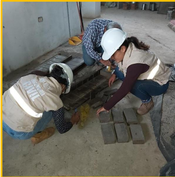
**FOTOGRAFÍA N° 7:** Desencofrado de adoquines con adición de ceniza de caña de azúcar al 4%, 7% y 10%.
