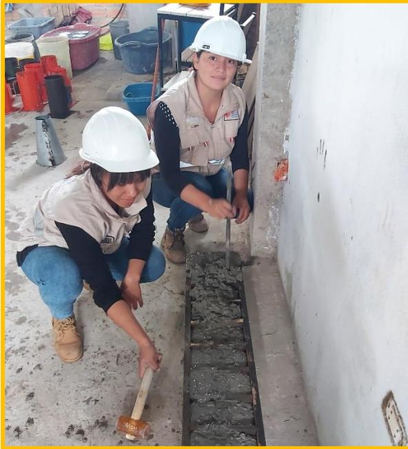
**FOTOGRAFÍA N° 5:** Se observa el proceso de vaciado y de concreto para adoquines con adición de ceniza de caña de azúcar.
