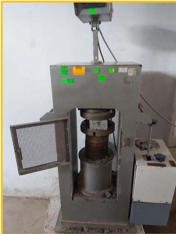
**FOTOGRAFÍA N° 10:** Rotura de espécimen a los 28 días de curado.
