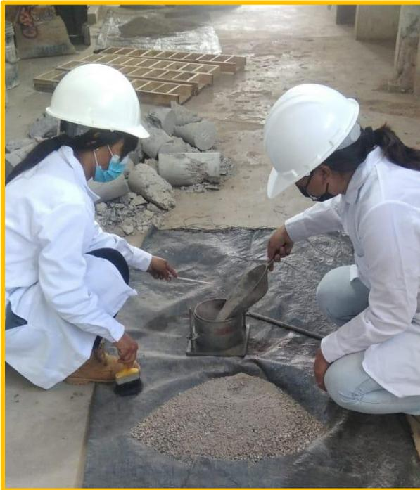
**FOTOGRAFÍA N° 1:** Se observa el proceso para ensayos de los materiales, donde se está realizando el peso unitario suelto y compactado.
