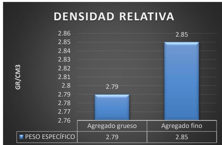
**Figura N° 8:** Peso específico de agregados.
