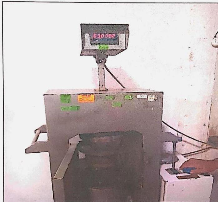
Realización de ensayo normalizado para la determinación de la resistencia a la compresión del concreto, NTP 339:034 - 2008
