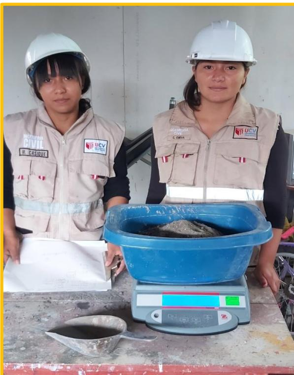
**FOTOGRAFÍA N° 2:** Peso de los materiales para diseño de mezcla  $f'c=380 \text{ kg/cm}^2$ .
