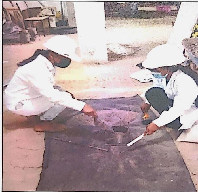
Proceso de ensayo de peso volumétrico suelto y peso volumétrico compactado NTP-400.017-2011 (Agregados) Método de Ensayo Para Determinar El Peso Unitario Del Agregado.
