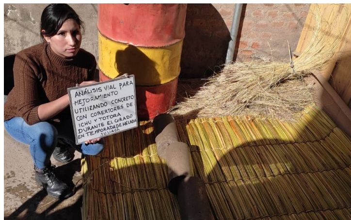
VISTA 16: Concreto expuesto a intemperie cubierto con totora
