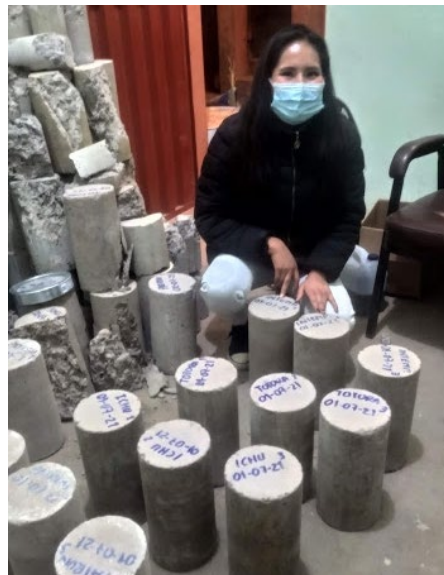
Figura 16. Briquetas a los 14 días de curado
