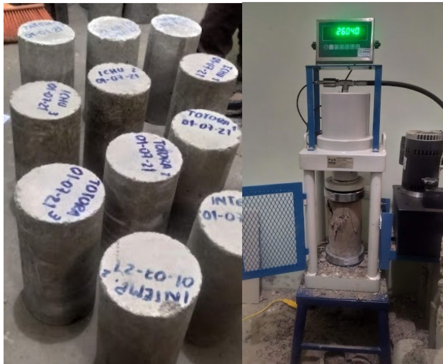
VISTA 19: Resistencia a la compresión a los 14 días de curado
