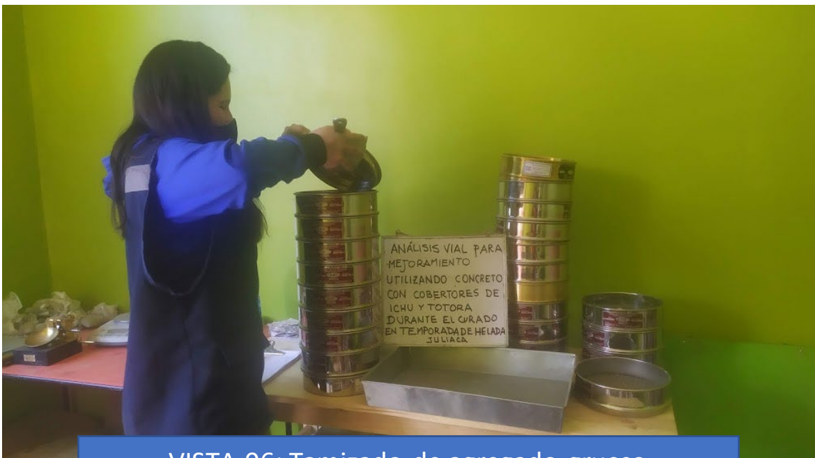
VISTA 06: Tamizado de agregado grueso
