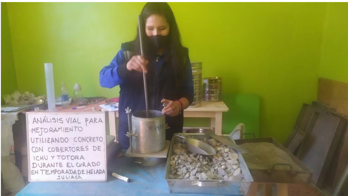
VISTA 12: Varillado del agregado grueso
