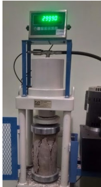
Figura 17. Rotura de concreto, curado a los 14 días
