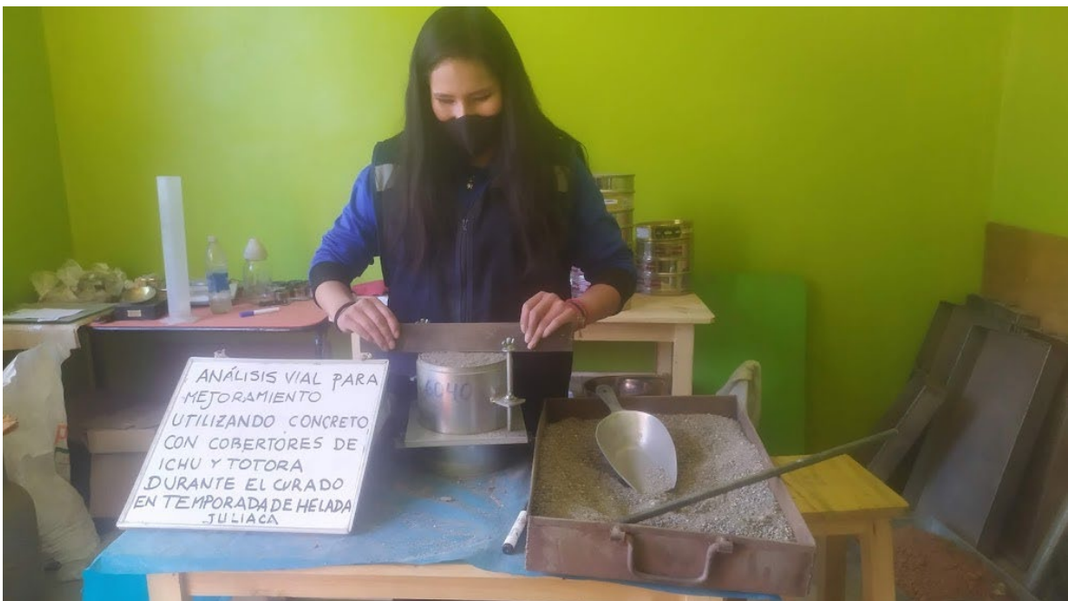
VISTA 14: Nivelado del agregado fino
