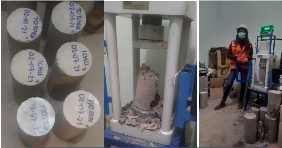
VISTA 18: Rotura de briquetas a los 07 días
