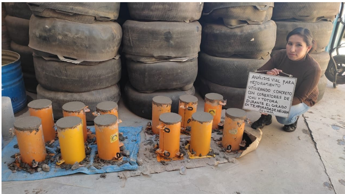
Figura 8. Vaciado de concreto en moldes de 6" x 12"
