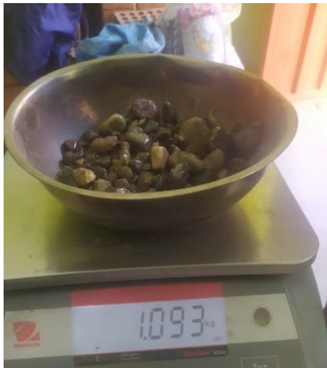
VISTA 10: Peso de agregado grueso saturado
