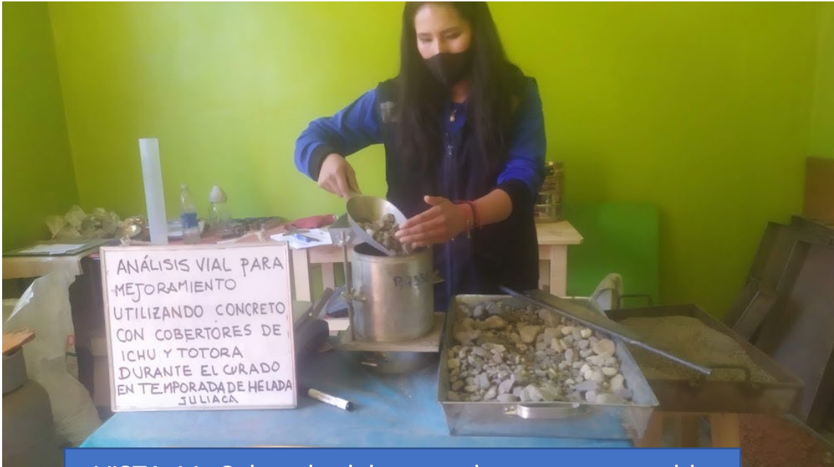
VISTA 11: Colocado del agregado grueso en molde
