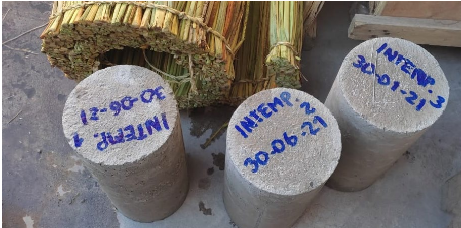
VISTA 15: Concreto expuesto a intemperie
