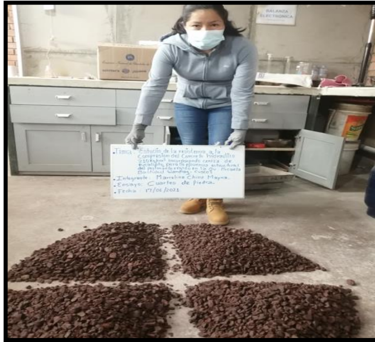
Cuarteo del agregado grueso.
