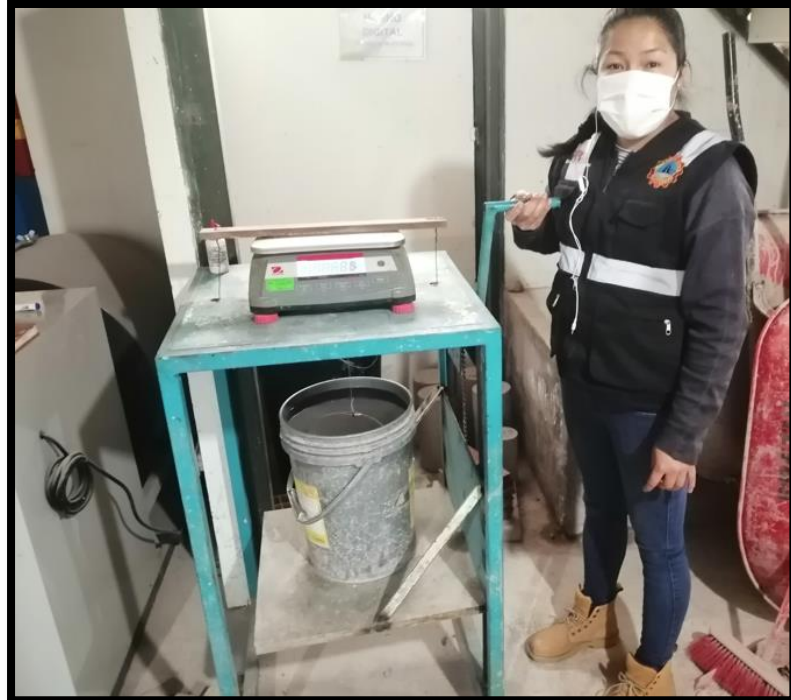
Peso específico agregado grueso.
