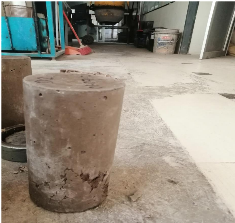
Rotura de probetas cilíndricas (7 días)
