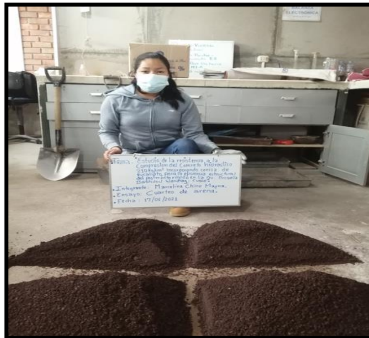
Cuarteo del agregado fino.
