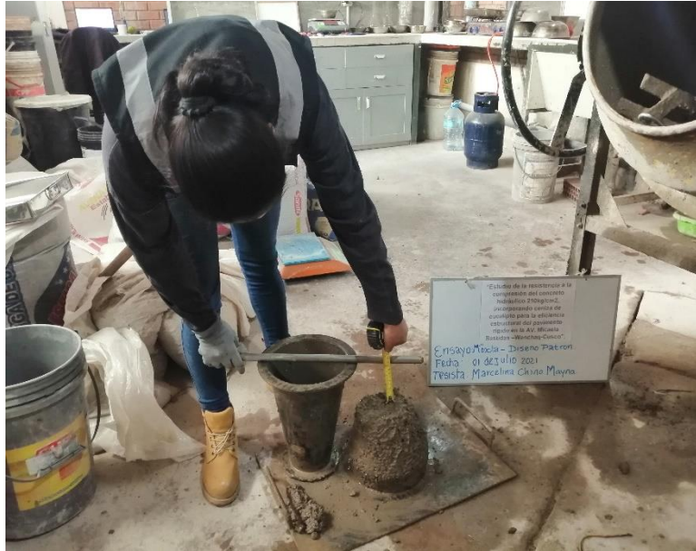
Ensayo de cono de Abrams.
