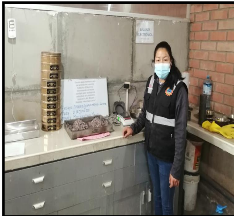
Análisis granulométrico agregado
