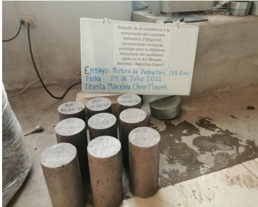
Rotura de probetas cilíndricas (28 días)
