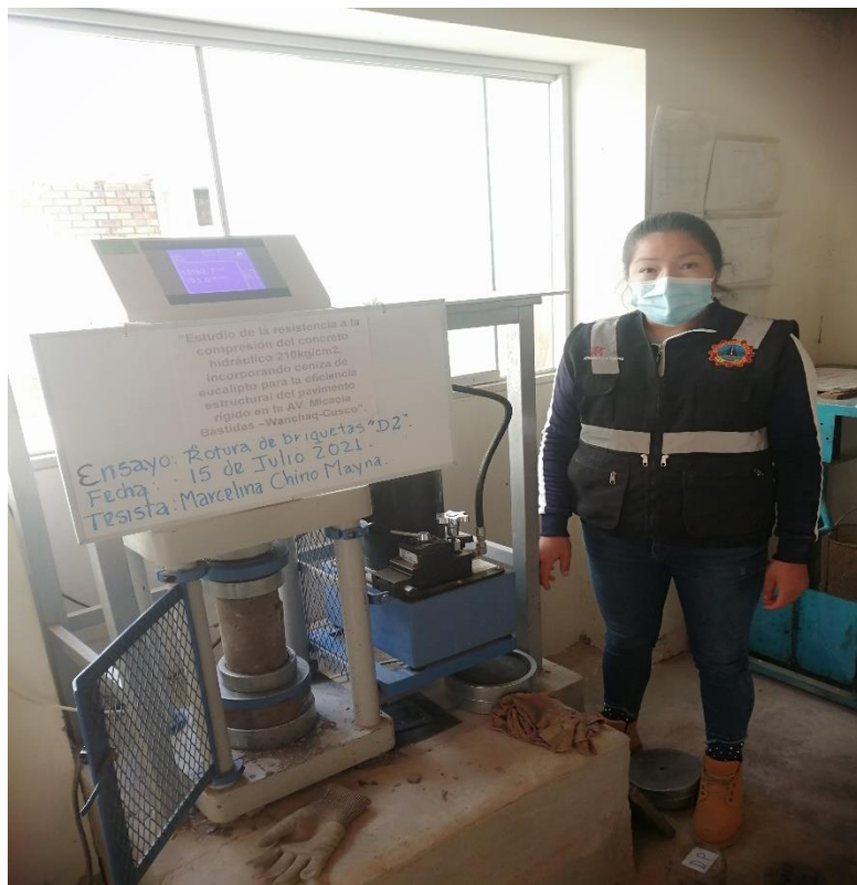
Rotura de probetas cilíndricas D2 (14 días)
