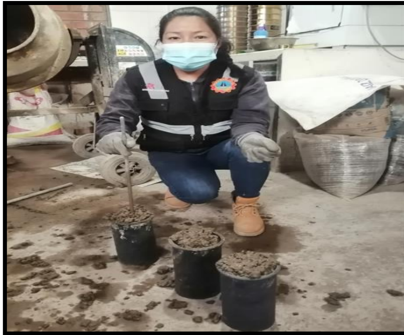
Vaciado de concreto en probetas cilíndricas.
