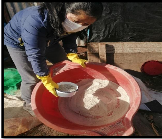
Figura 17: Tamizado de la ceniza de eucalipto.
