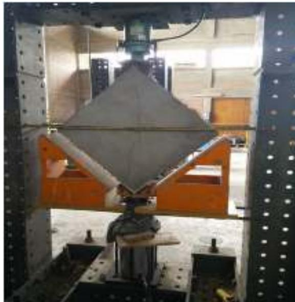
**Figura 12.** *Ensayo de muretes con malla de electrosoldada*
