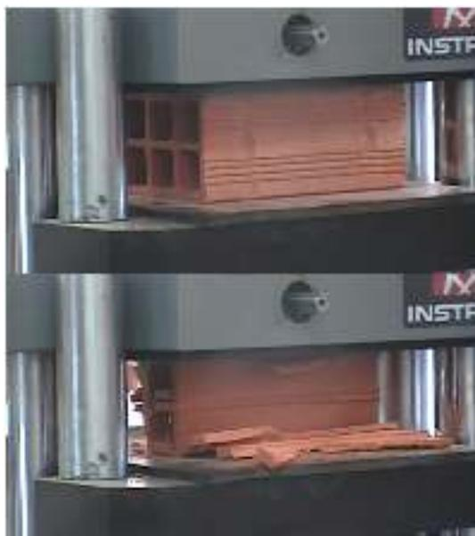
Figura 9. Ensayo de compresión axial en unidades de albañilería
