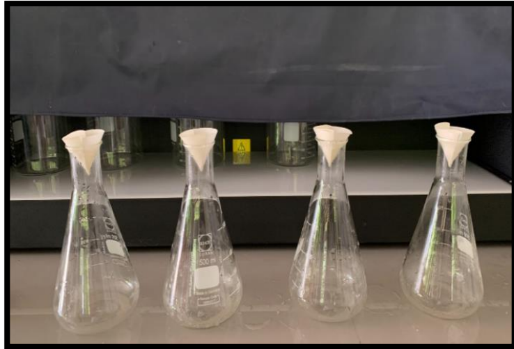
Figura 10: Filtración del agua, para determinación de sólidos disueltos totales
