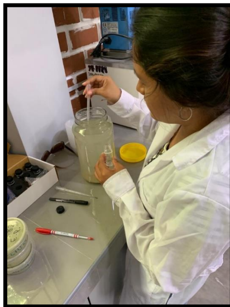
Figura 23: Toma de muestra de agua para medición de turbidez final
