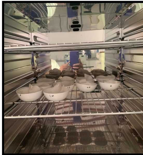
Figura 27: Muestras puestas a 130 °C en la estufa de laboratorio para terminación de sólidos disueltos totales
