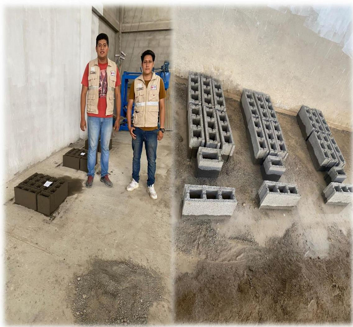
**Figura 19.** Bloques al 1%. 2% y 3% y bloques en etapa de curado en piscina.
