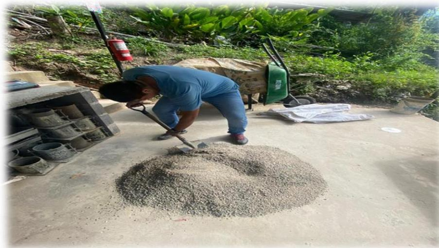
**Figura 3.** Proceso de selección del Agregado Fino para el secado y obtención del contenido de humedad.
