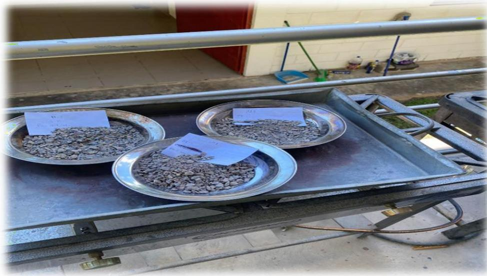
**Figura 6.** Secado del material y Granulometría del Agregado
