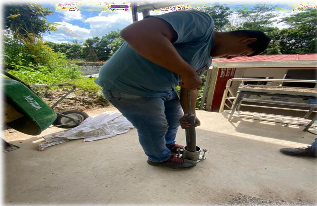
**Figura 13.** Enrazamiento del proctor y realización de 19 golpes por capa.
