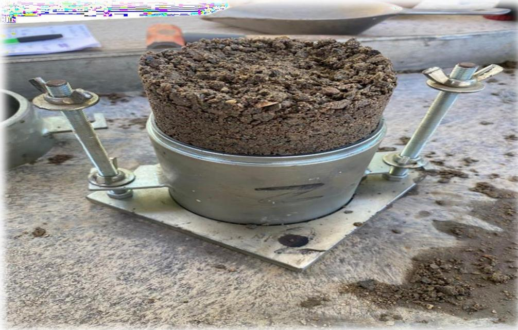
**Figura 12.** Se realiza el enrazamiento del proctor y realización de 19 golpes por capa.
