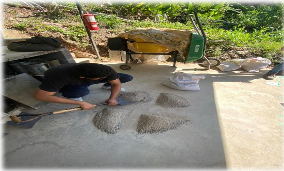
**Figura 4 .** Proceso de selección del Agregado Fino con el método del Cuarteo y el proceso de secado del Agregado Fino.
