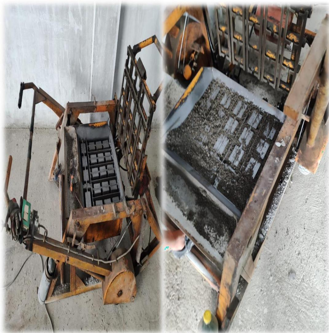
**Figura 17.** Maquina vipro ponedora donde se realiza el llenado en la máquina.
