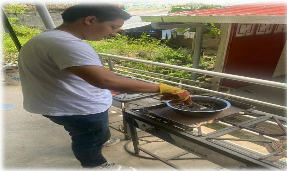
**Figura 5 .** Proceso de selección del Agregado Fino con el método del Cuarteo y el proceso de secado del Agregado Fino.
