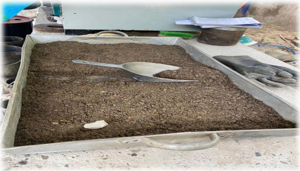
**Figura 10.** Cuarteo de la muestra y se realiza Ensayo Proctor
