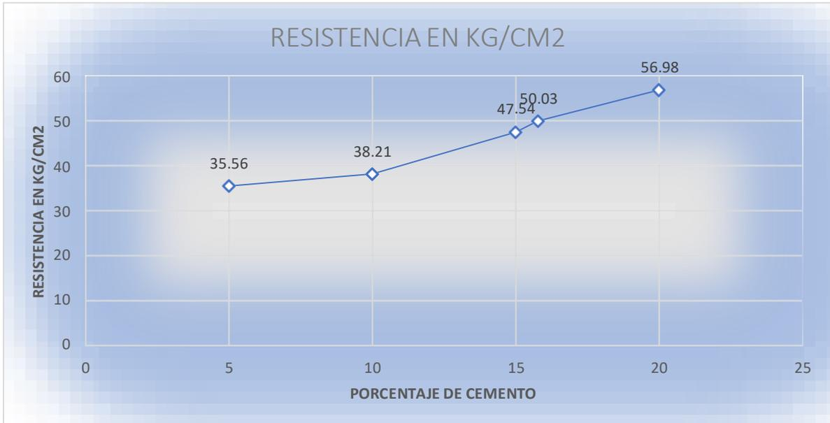
**Figura 1.** Diseño de mezcla óptima para mejorar resistencia a la compresión
