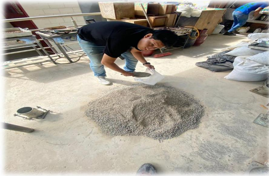
**Figura 2.** Proceso de selección del Agregado Fino para el secado y obtención del contenido de humedad.
