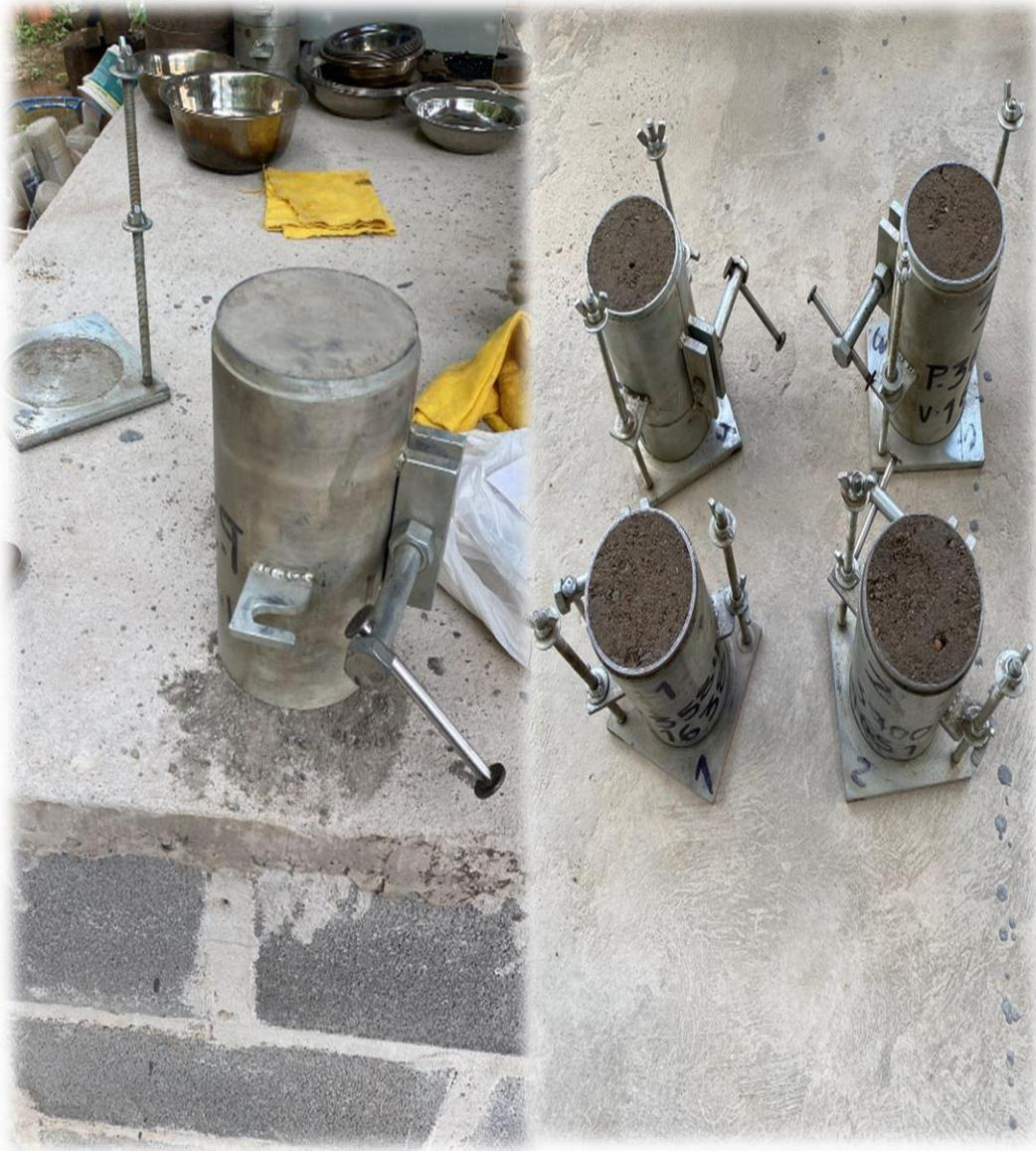
**Figura 1.** Enrazamiento proctor\_Ensayo Proctor Modificado.
