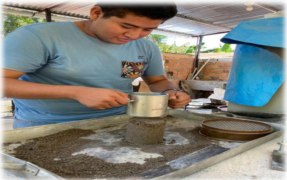
**Figura 11.** Cuarteo de la muestra y se realiza Ensayo Proctor
