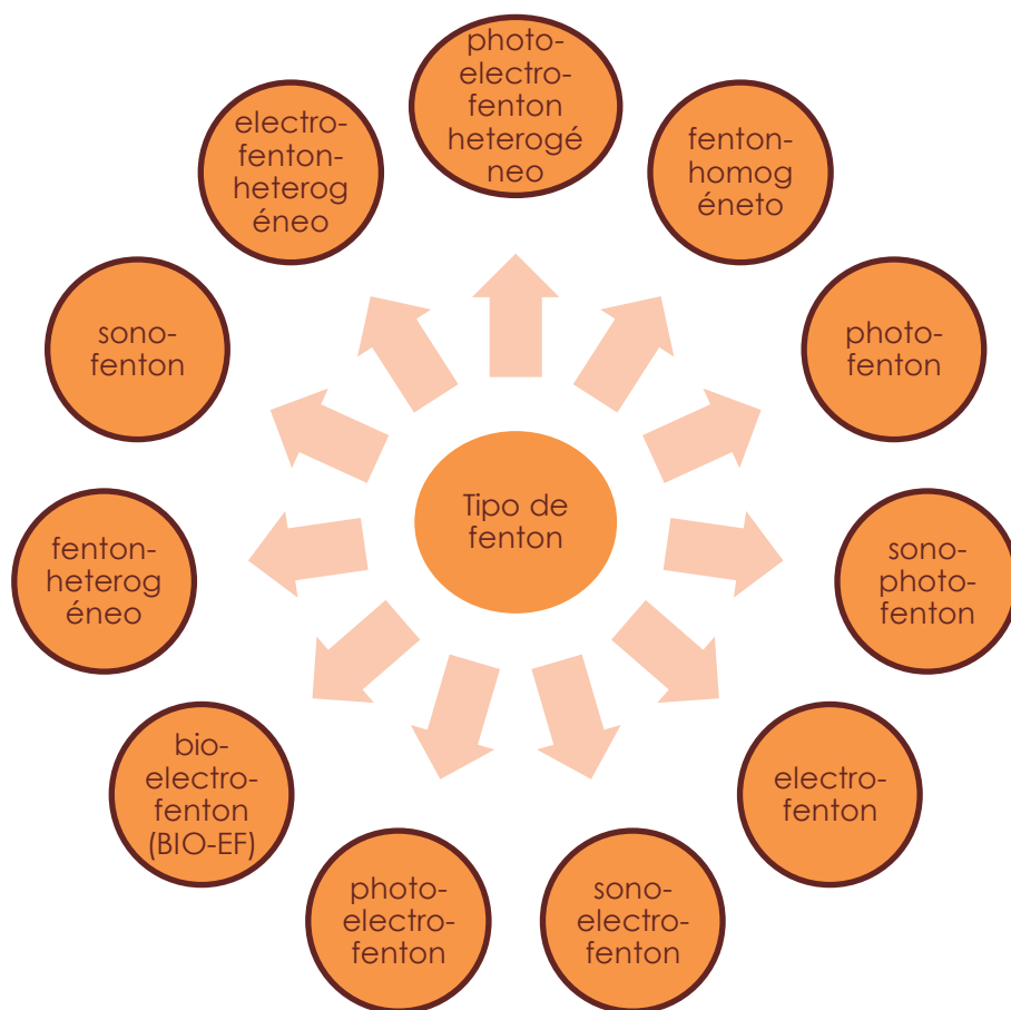
Figura 4: Tipos de fenton para tratamiento de aguas residuales industriales Fuente: Curo y Mendoza (2020).
