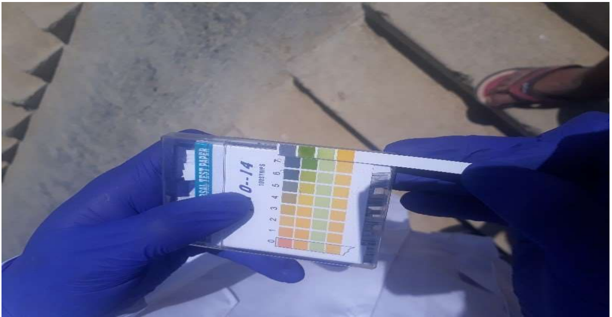
Medición de pH en campo Elaboración propia
