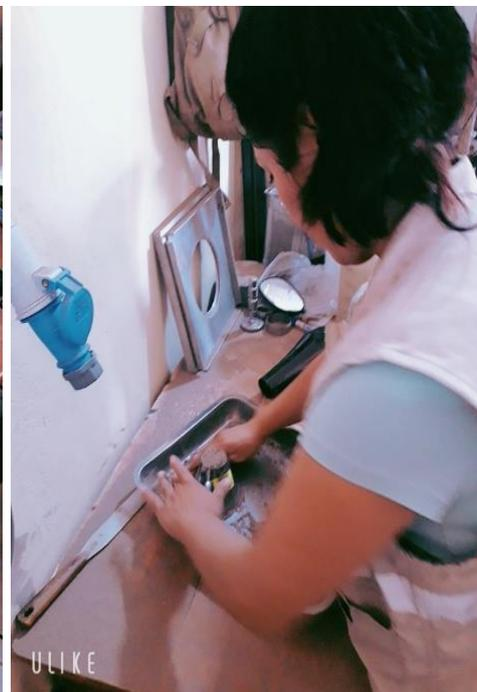
Fotografía N°15. Proceso del peso específico del agregado + la fiola.
