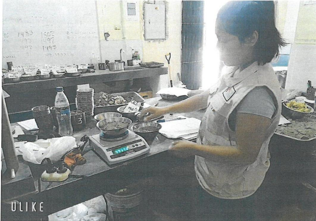
Fotografía N° 05. Tarado del peso del material más el molde, para determinar el contenido de humedad natural.
