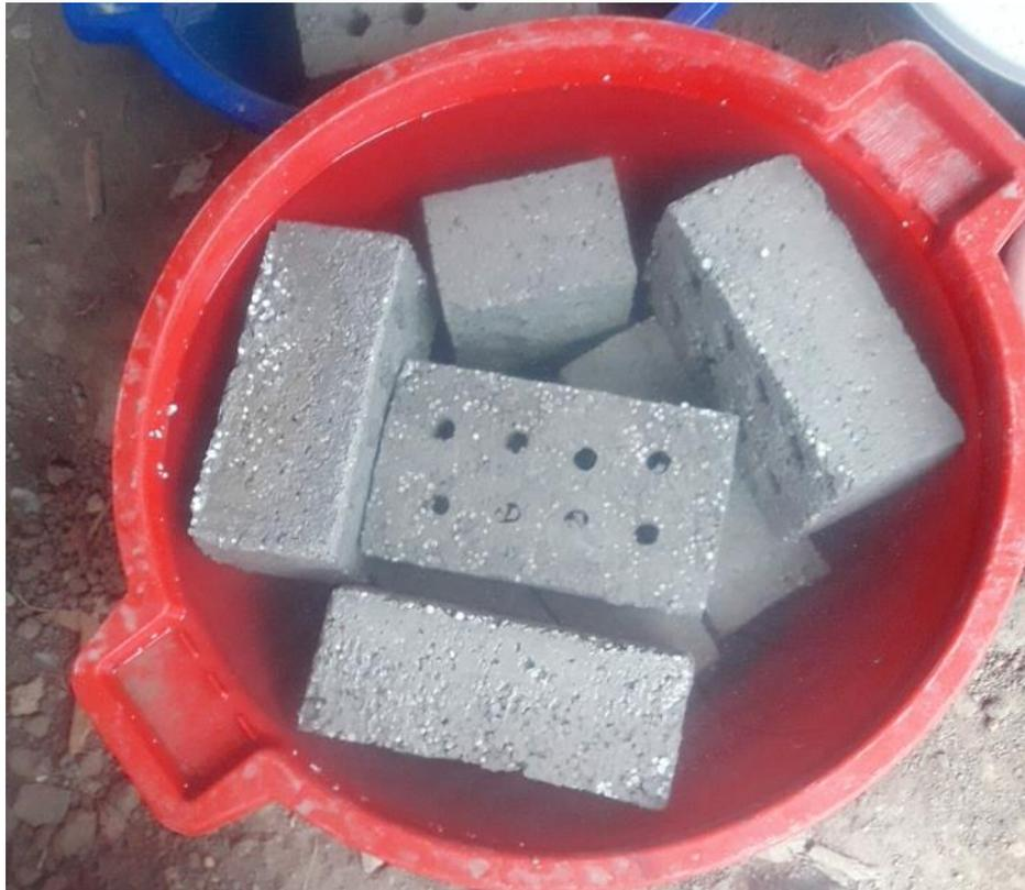
Fotografía N°32. Pesado del ladrillo de concreto, después de las 24h dejado en agua
