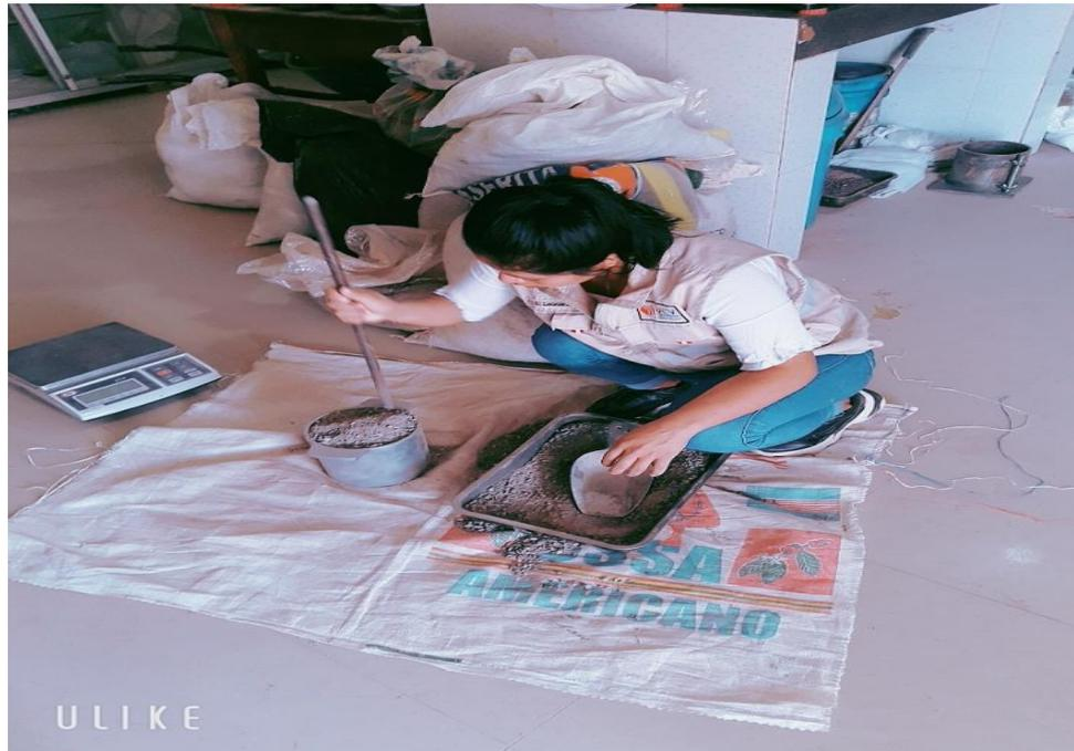
Fotografía N°18. Peso del material más el molde unitario suelto y compactado de los agregados.
