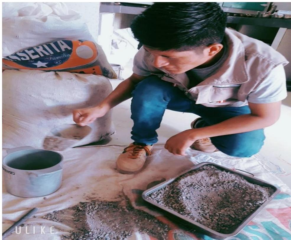
Fotografía N°17. Apisonado por capas de agregado en el molde, para el peso unitario compactado.
