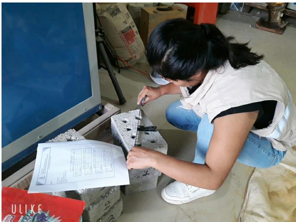
Fotografía N°29 y 30. Ensayo de variación dimensional
