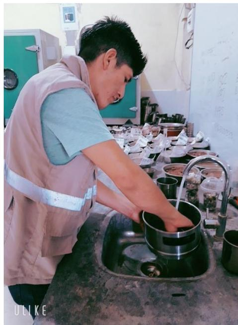
Fotografía N°10 y 11. Análisis granulométrico del agregado por tamizado.
