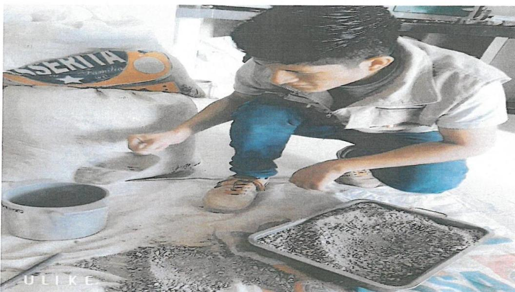
Fotografía N° 15. Apisonado por capas de agregado en el molde, para el peso unitario compactado.
