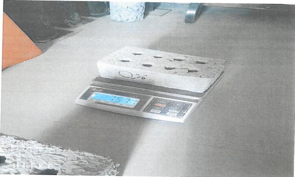
Fotografía N° 04. Preparación de los ladrillos para ser colocada a la prensa hidráulica y proceder con el ensayo de resistencia a compresión.
