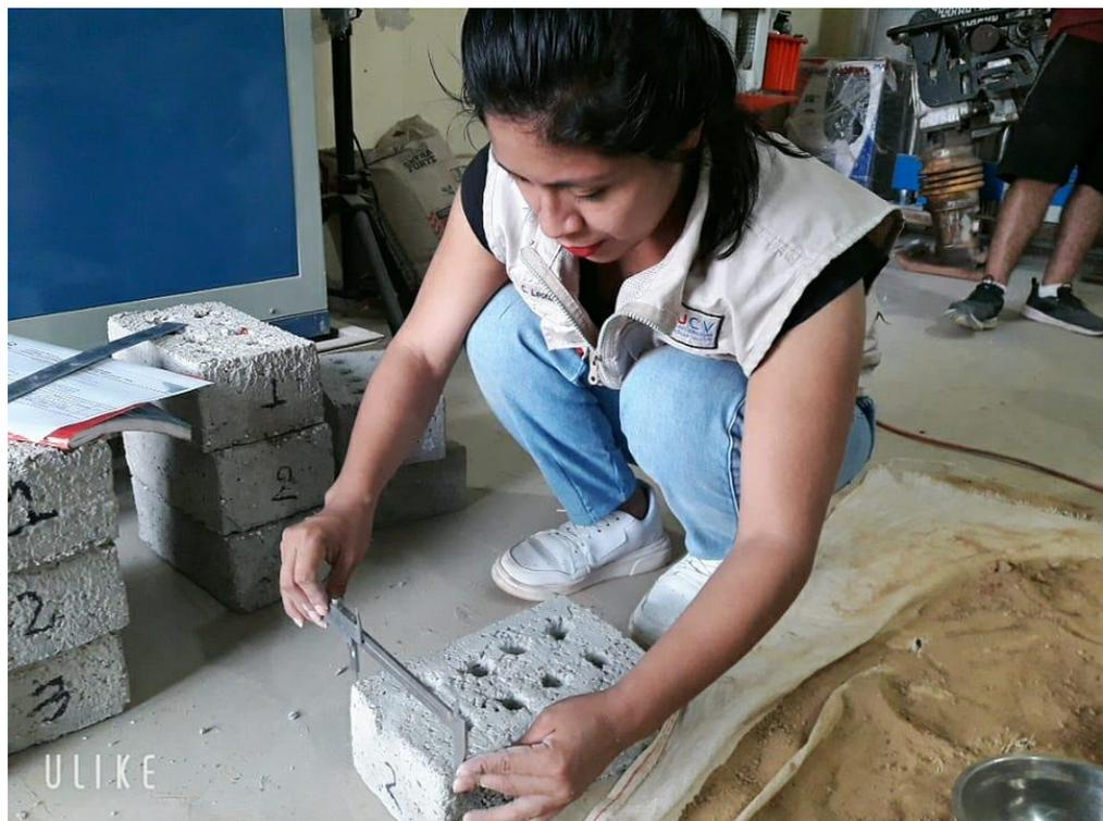
Fotografía N°31. Ensayo de absorción de los ladrillos de concreto
