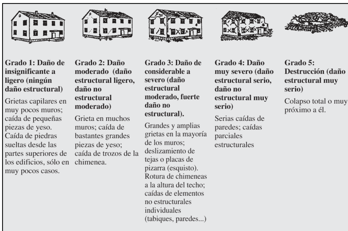
Figura 1 Grados de daño en una edificación
