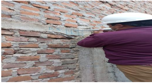
Ensayo de esclerometría P-3 (Viga)
