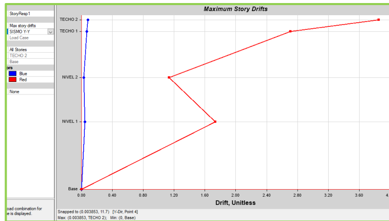
Figura N°26: Deriva de entrespiso en el eje Y-Y
