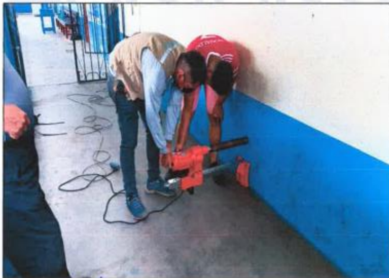
SE OBSERVA EXTRACCION DE TESTIGOS DIAMANTADOS EN OBRA
