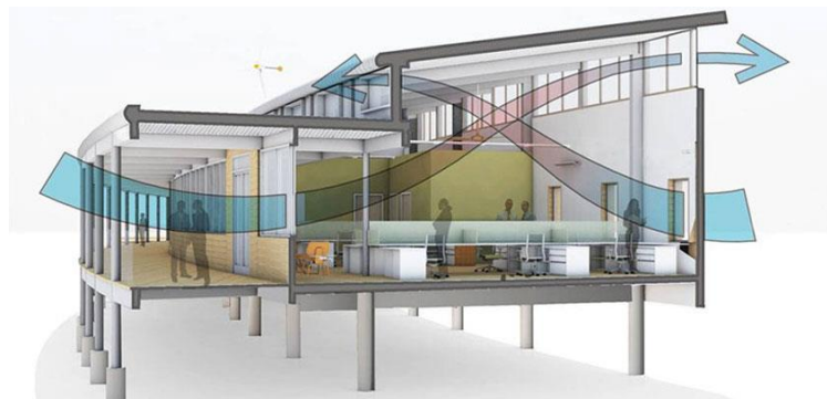
Figura 17. Acondicionamiento Ambiental – Sistema de ventilación natural.
