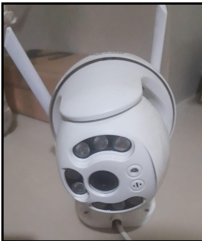
Figura 19. Cámara filmadora para conteo vehicular
