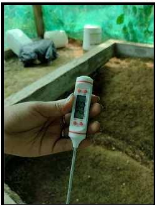
Foto: T1-b; temperatura del tratamiento con ácido bórico (500 g), suero de leche (1 L), microorganismos (3 L), sangre (10 L).
