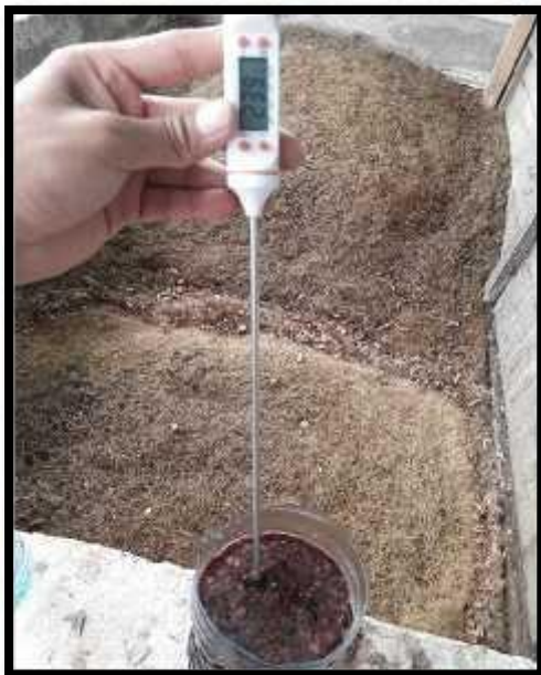
Foto: T2-b; temperatura del tratamiento con ácido bórico (500 g), suero de leche (1 L), microorganismos (3 L) y sangre (10 L).
