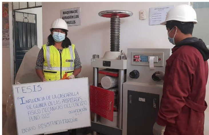
Fotografía 8: Ensayo de la resistencia a la tracción del concreto con 0.2% de cascarilla de quinua
