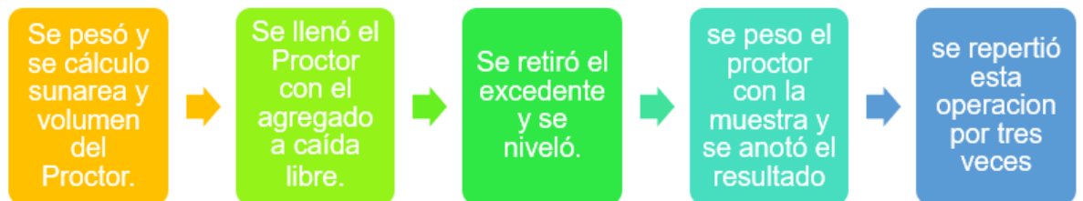
Figura 24. Procedimiento peso unitario suelto
