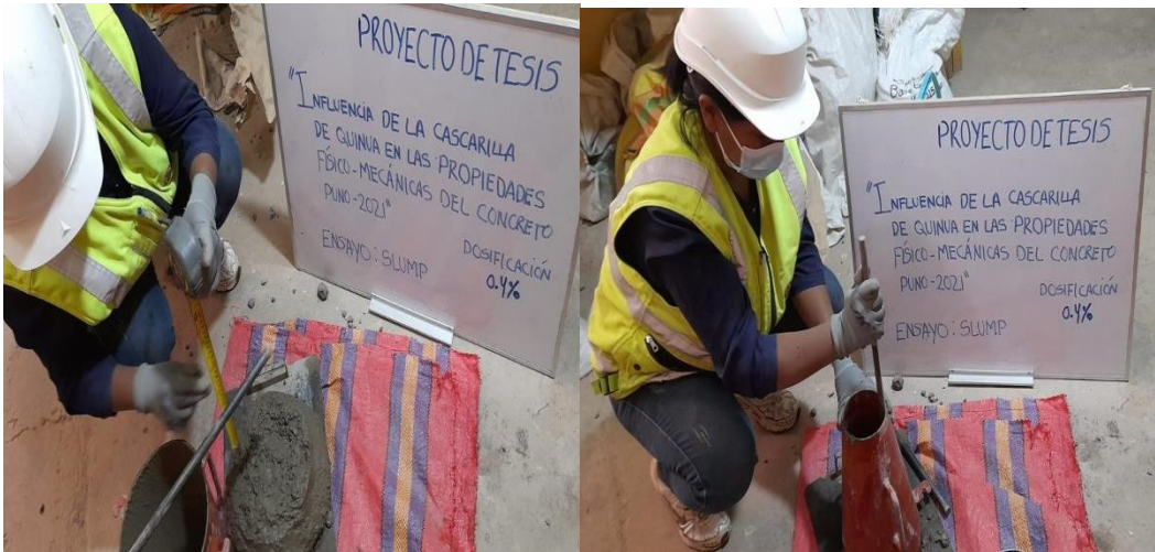
Figura 34. Ensayo de slump del concreto en estado fresco.
