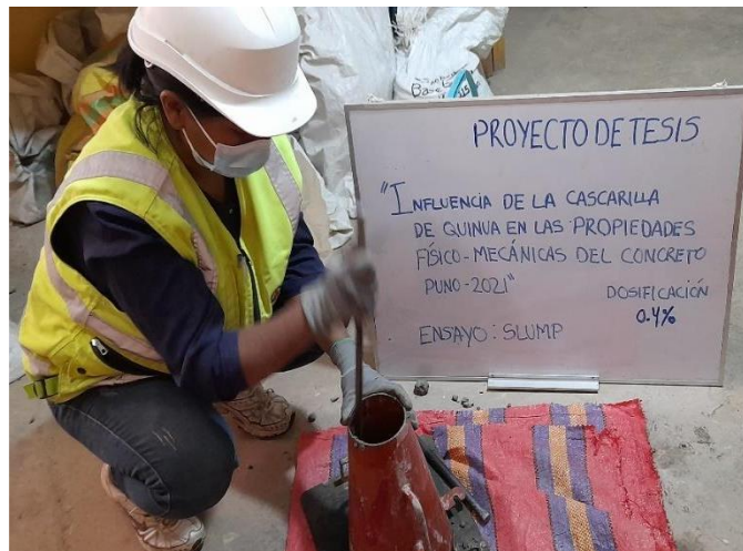
Fotografía 4: Varillado del cono de abrams - SLUMP
