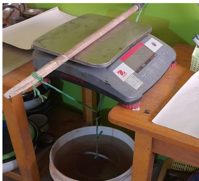
Figura 27. Agregado grueso en la canastilla mecánica sumergido en agua
