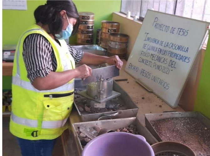
Fotografía 3: Nivelación de Proctor – ensayo de pesos unitarios
