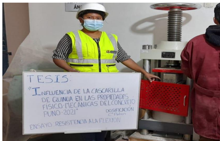
Fotografía 10: Ensayo de la resistencia a la flexión del concreto patrón
