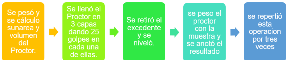
Figura 25. Procedimiento peso unitario varillado
