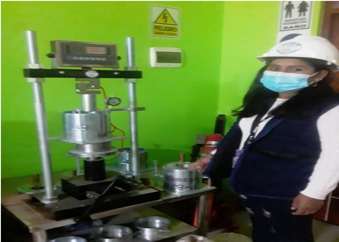
Figura 44. Elaboración del ensayo CBR
