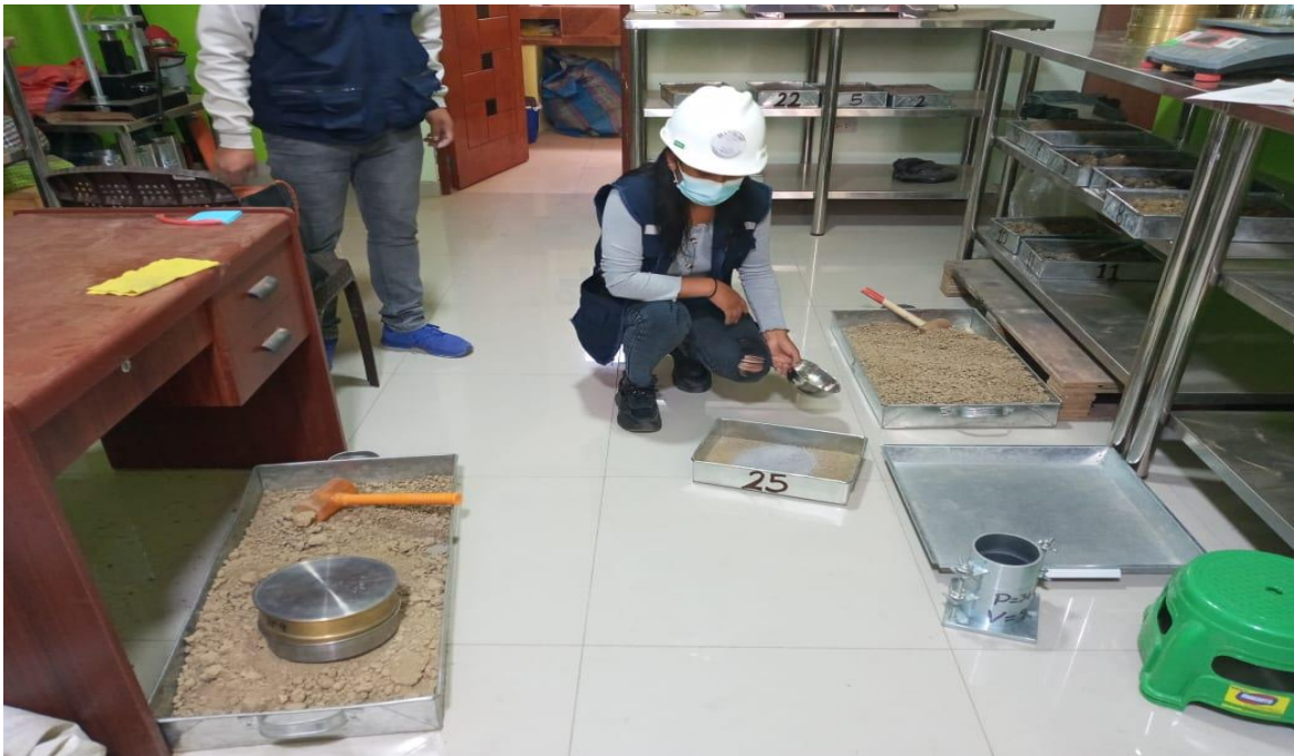
Figura 41. Elaboración de los tratamientos para los ensayos respectivos (Proctor modificado)
