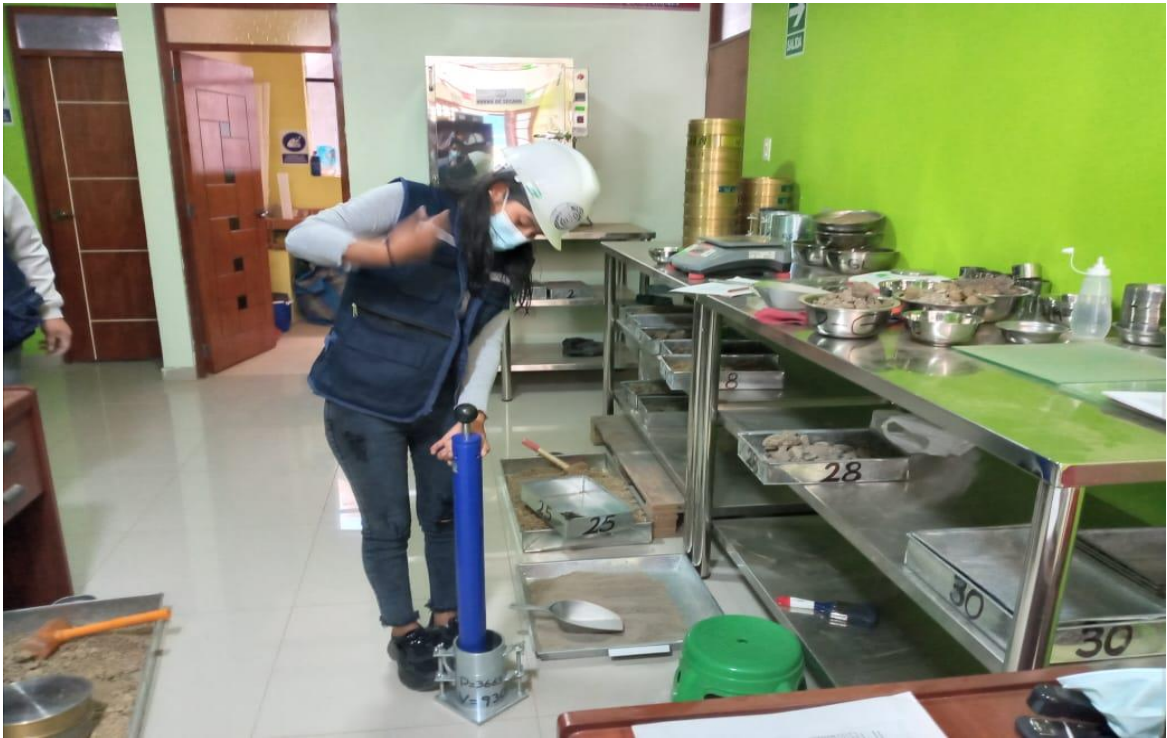
Figura 42. Elaboración de ensayo Proctor modificado en el laboratorio
