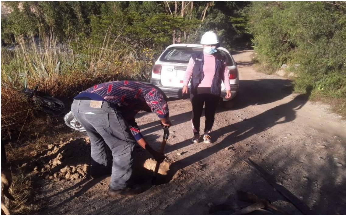
Figura 33. Obtención de muestra de suelo a través de la elaboración de calicata.
