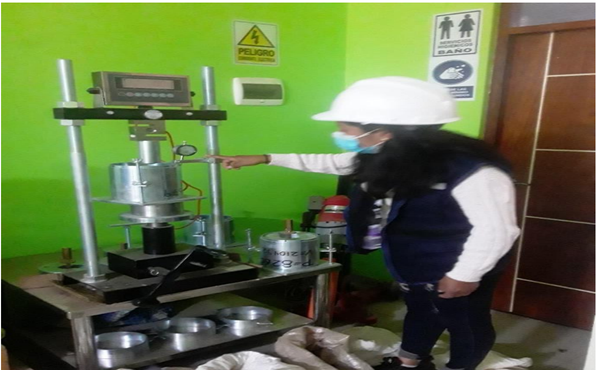
Figura 45. Inspeccionando el ensayo CBR
