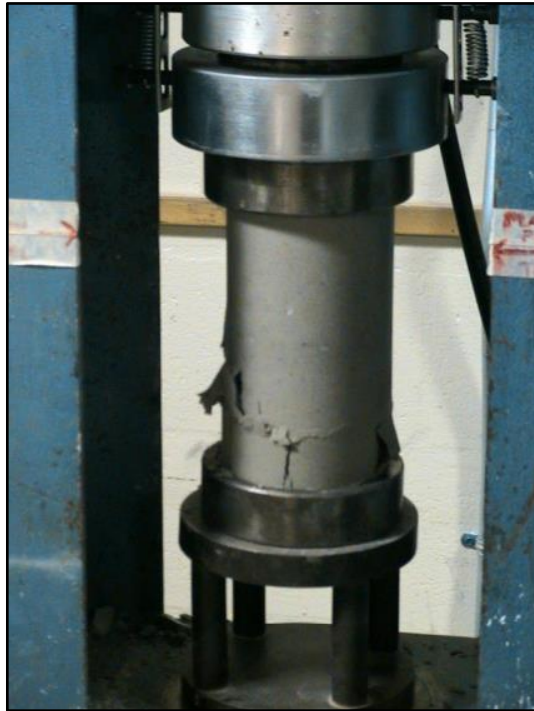
Figura 3. Ensayo a la compresión del concreto.
