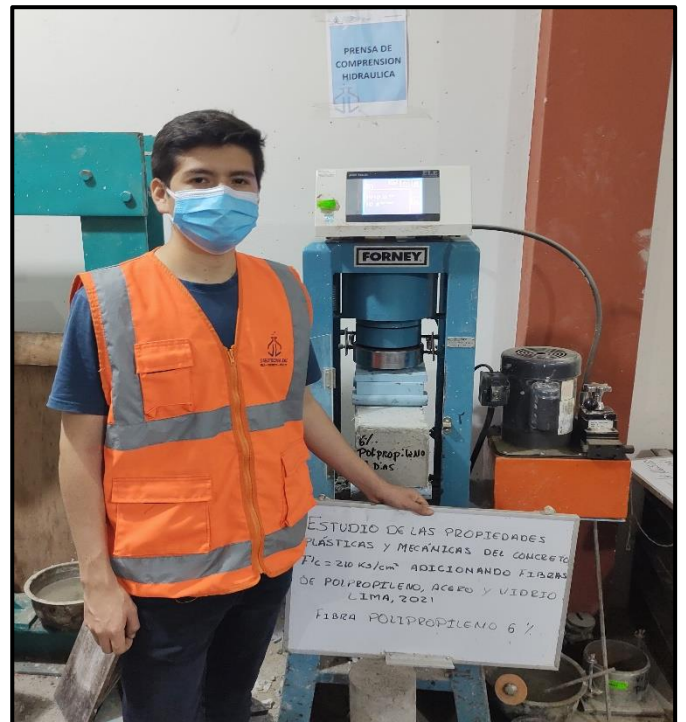
Fotografía 12. Ensayo de resistencia a flexión del concreto con adición de 6% de fibras de polipropileno, a la edad de 7 días
