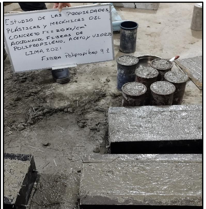
Fotografía 7 y 8 Elaboración de probetas de concreto con adición de 6 y 9 % de fibras de polipropileno
