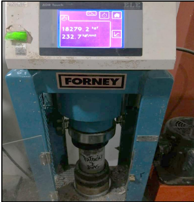
Fotografía 13. Ensayo de resistencia a compresión del concreto patrón, a la edad de 7 días
