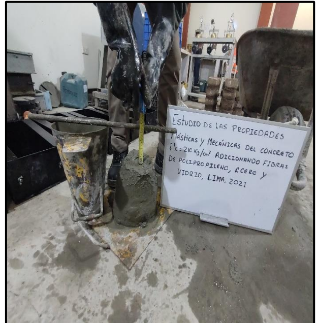
Fotografía 2. Asentamiento del concreto patrón
