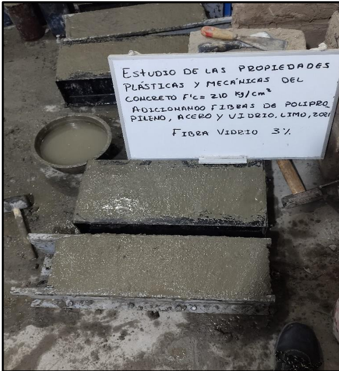
Fotografía 9. Elaboración de probetas de concreto con adición de 3% de fibras de vidrio
