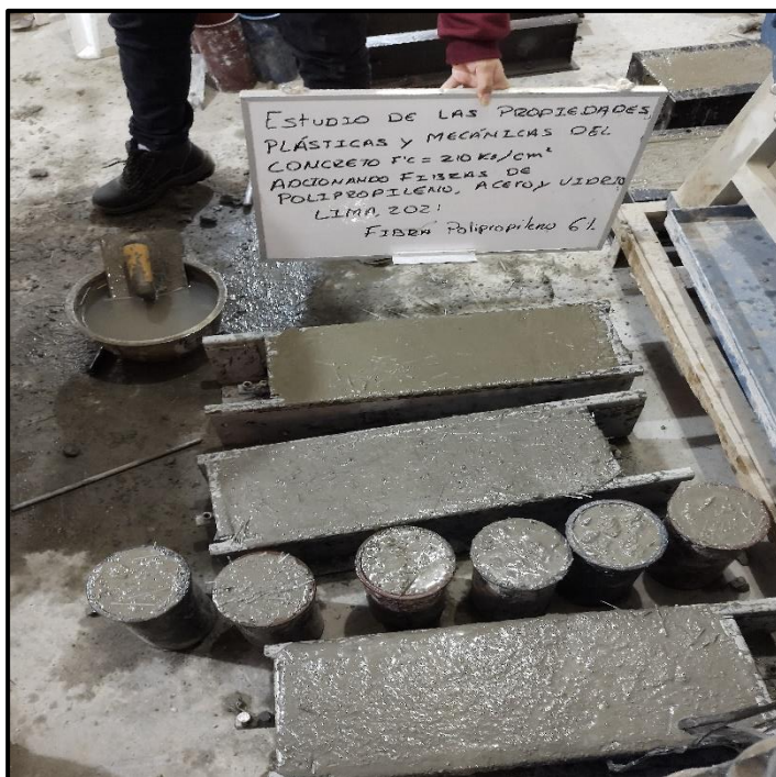
Fotografía 7 y 8 Elaboración de probetas de concreto con adición de 6 y 9 % de fibras de polipropileno
