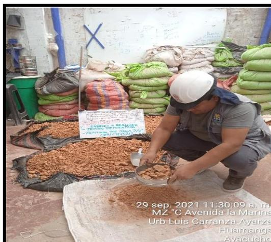
Figura 13. Tendido de muestras y tamizado por malla 3/4"
