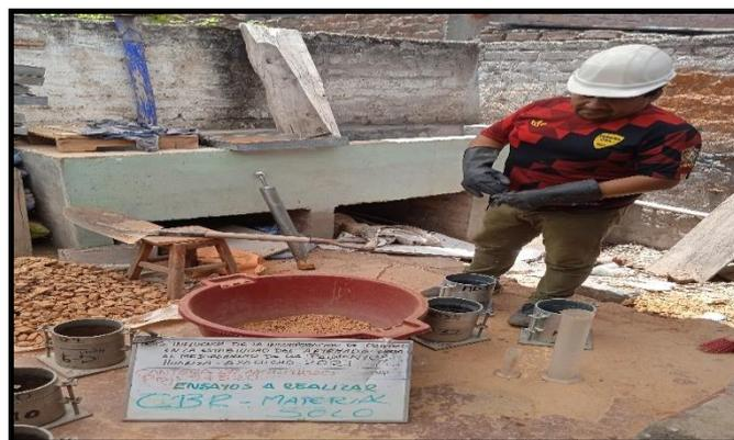
Figura 33. Llenado con material afirmado en probetas para ensayo CBR.
