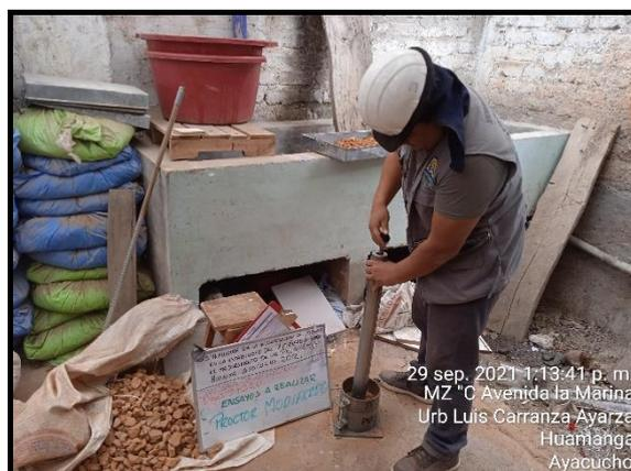
Figura 29. Compactación en probeta para Proctor modificado
