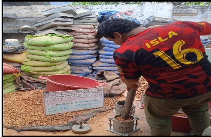
Figura 34. Compactación de afirmado en moldes para ensayo CBR.
