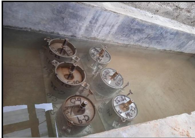
Figura 35. Reposo de moldes en agua – ensayo CBR
