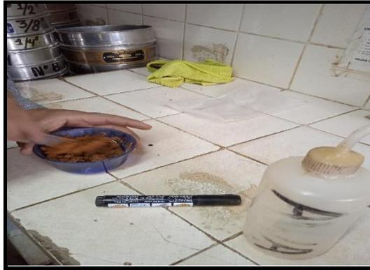
Figura 25. Mezcla de agua destilada y material afirmado para límite plástico
