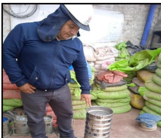
Figura 14. Tamices para el ensayo de granulometría
