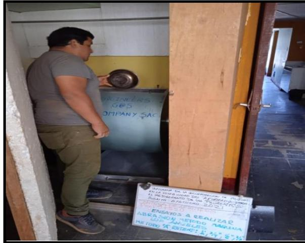
Figura 19. Material tamizado añadido a máquina de los ángeles
