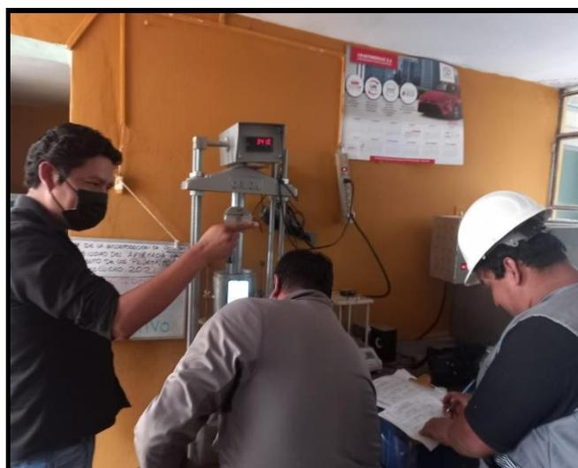
Figura 36. Aplicación de carga con prensa CBR
