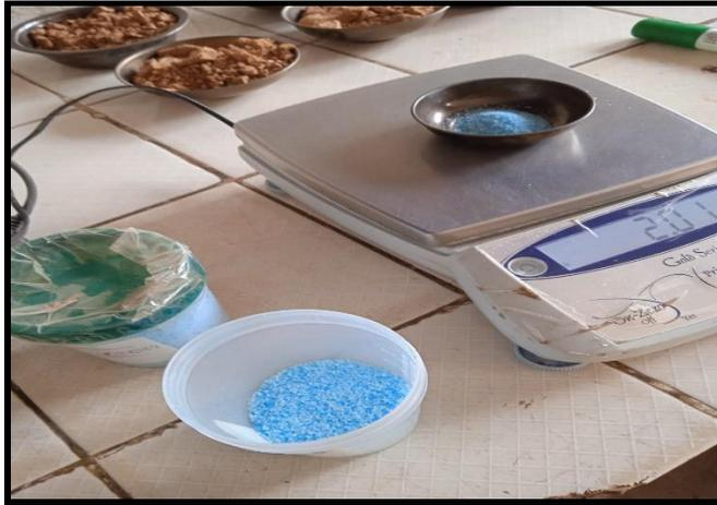
Figura 39. Peso de aditivo PolyCom con sus respectivas dosificaciones
