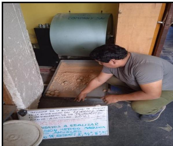
Figura 21. Retiro de material triturado
