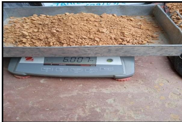
Figura 28. Peso de material para Proctor modificado
