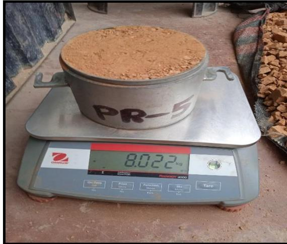
Figura 30. Peso de material compactado en 5 capas – Proctor modificado
