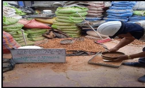
Figura 22. Tamizado para realizar límite líquido y límite plástico
