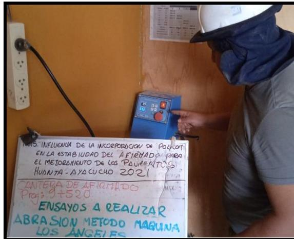
Figura 20. Encendido de máquina de los ángeles
