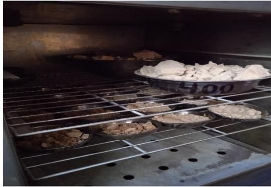
Figura 15. Material de granulometría en el horno
