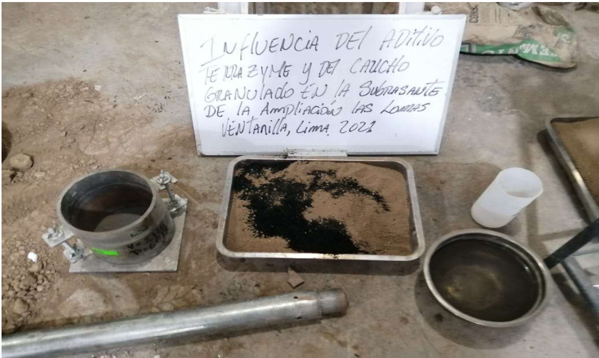
Figura N°26: Muestra patrón con caucho granulado y herramientas para ensayo de Proctor modificado
