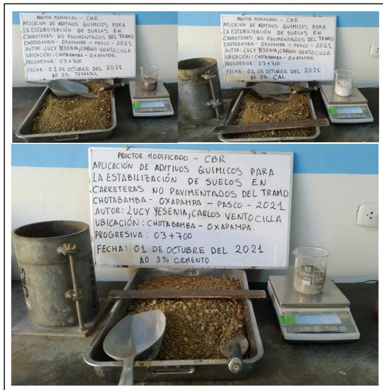
Figura 13: ensayo de la muestra M-1 realizado en Laboratorio con la adición de aditivos químicos
