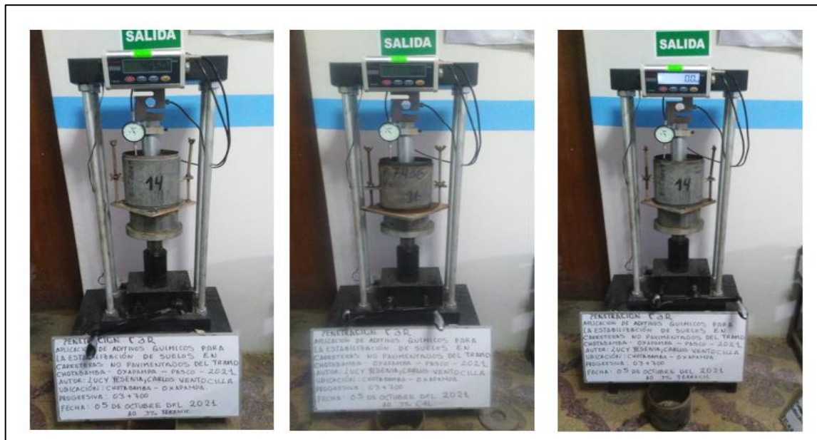
Figura 12: ensayo de la muestra M-1 realizado en Laboratorio con la adición de aditivos químicos
