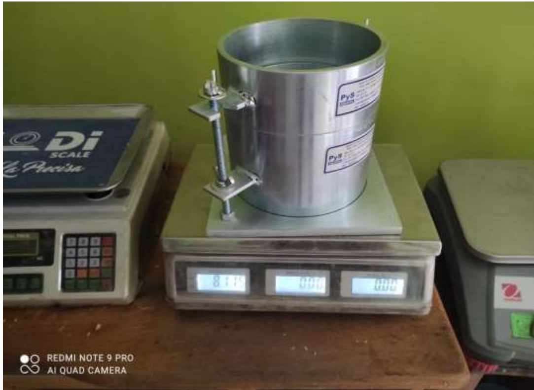
Figura 14. Molde para compactación – Proctor Modificado
