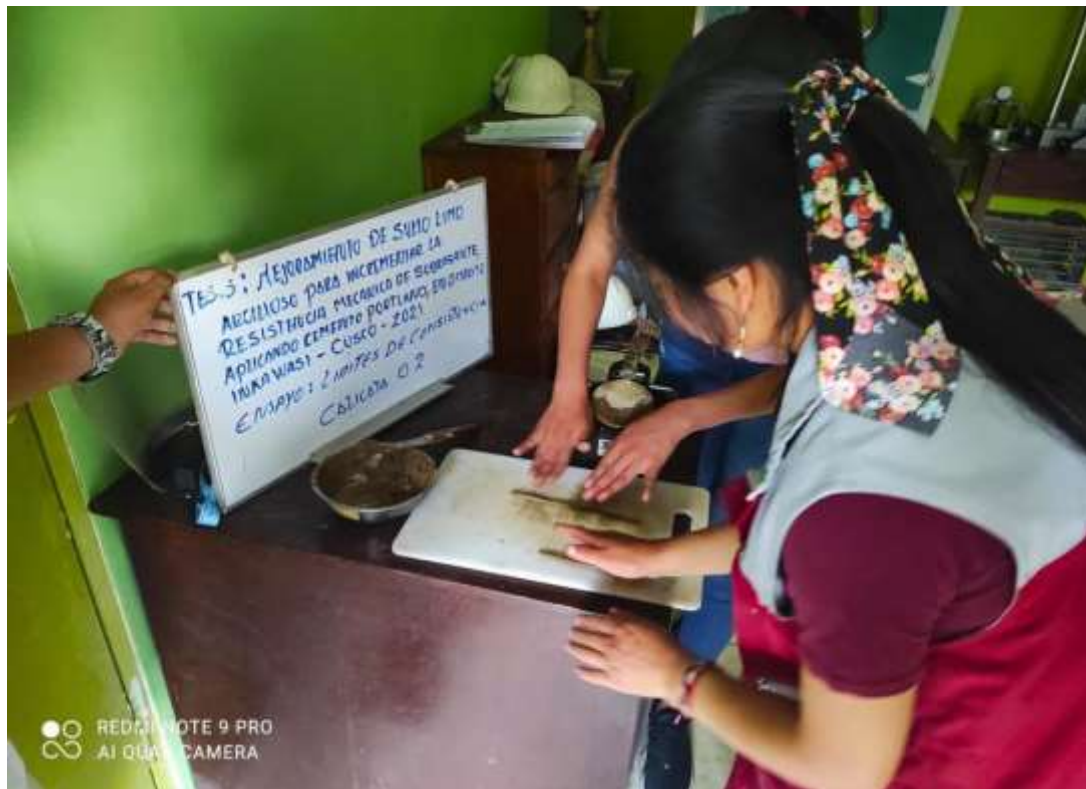
Figura 12. Ensayo para determinación del límite plástico
