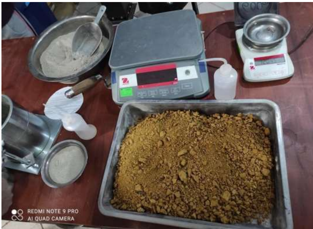
Figura 15. Dosificación de cemento portland tipo I
