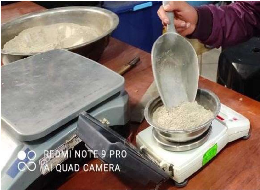
Figura 18. Adición de cemento portland
