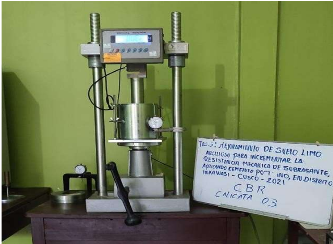
Figura 16. Ensayo de CBR
