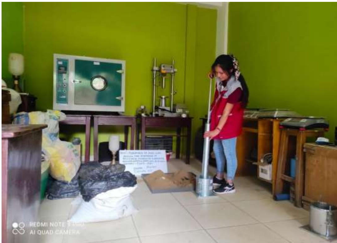
Figura 13. Realizando los golpes de compactación para el ensayo proctor
