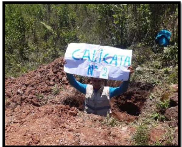
Fotografía N° 04. Excavación y extracción de muestras de calicatas para sus respectivos ensayos.
