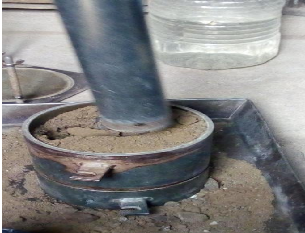
Figura 56: Compactación de la muestra con 56 golpes dados por el pisón Fuente: Elaboración propia
