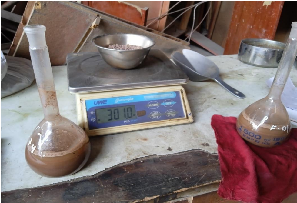
Figura 27: Gravedad específica y absorción de arcilla ASTM D-854. Fuente: Elaboración propia
