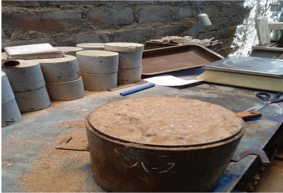
Figura 52: Preparación del CBR Fuente: Elaboración propia
