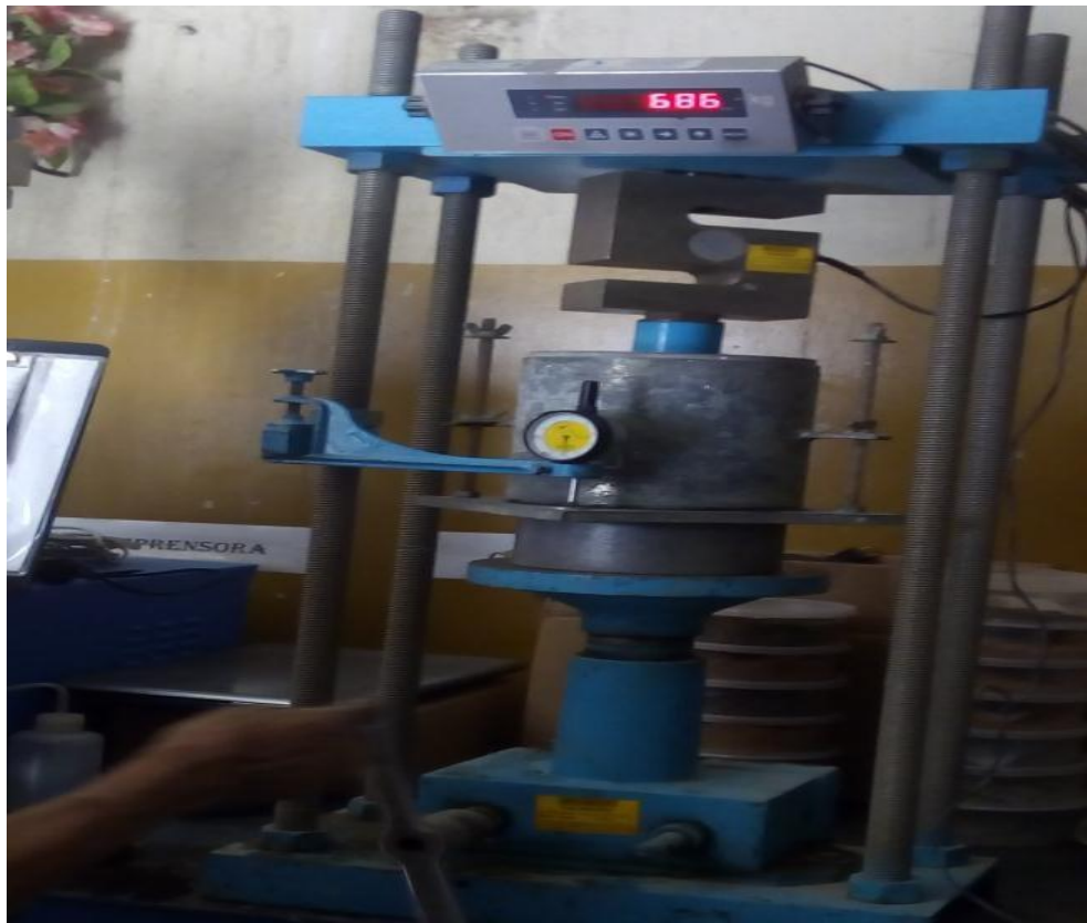
Figura 62: Muestra en la prensa hidráulica para ser penetradas Fuente: Elaboración propia
