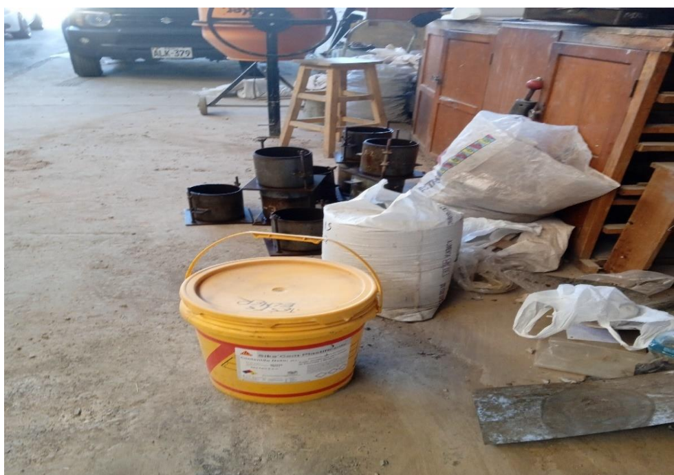
Figura 49: EL POLÍMERO SSPMB, para su aplicación según porcentajes de aplicación de 3, 6 y 9 para el incremento del CBR. Fuente: Elaboración propia
