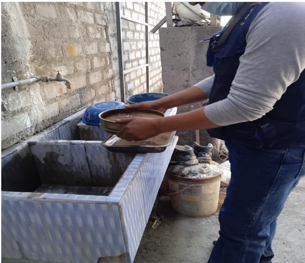
Figura 53: Lavar las muestras hasta que se hayan retirado todos los finos y limos Fuente: Elaboración propia
