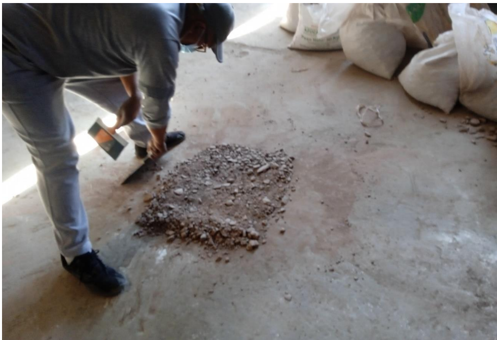
Figura 14: Figura 18: Realizando el muestreo en el Lab. de suelos RCFS.RL de Arequipa en donde se realizó el ensayo de las muestras extraídas de las calicatas en el C.P. San Antonio - Moquegua Fuente: Elaboración propia
