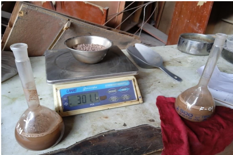
Figura 50: Ensayo de sales solubles MTC E219 Fuente: Elaboración propia
