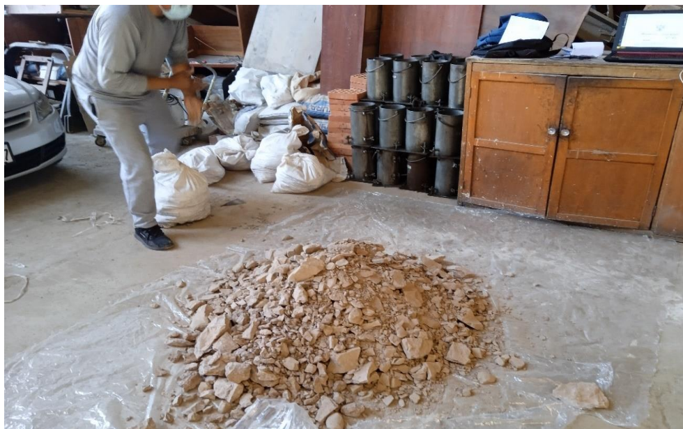
Figura 15: preparando el material para realizar el cuarteo en el Laboratorio de suelos RCFS.RL de Arequipa en donde se realizó la investigación de las muestras extraídas de las calicatas en el C.P. San Antonio -Moquegua Fuente: Elaboración propia
