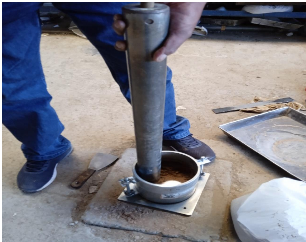
Figura 55: Preparación de la muestra alterada para ensayo Proctor modificado Fuente: Elaboración propia
