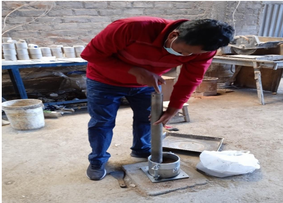
Figura 29: Ensayo de Proctor estándar MTC E 116 Fuente: Elaboración propia
