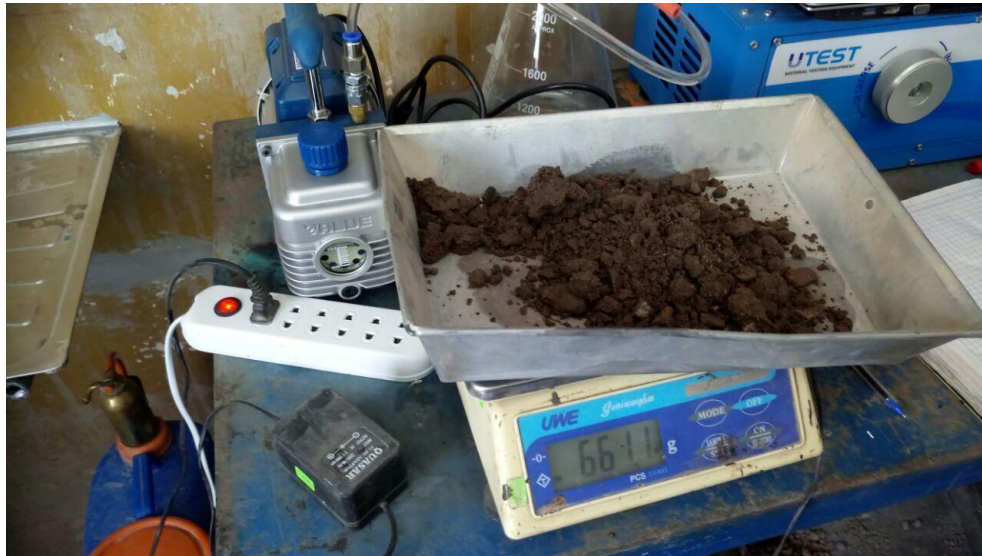
Figura 64: Pesar las muestras húmedas sacadas del corazón Fuente: Elaboración propia
