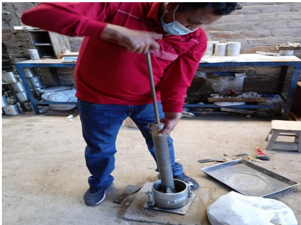
Figura 30: Ensayo de CBR natural D1883-91 Fuente: Elaboración propia
