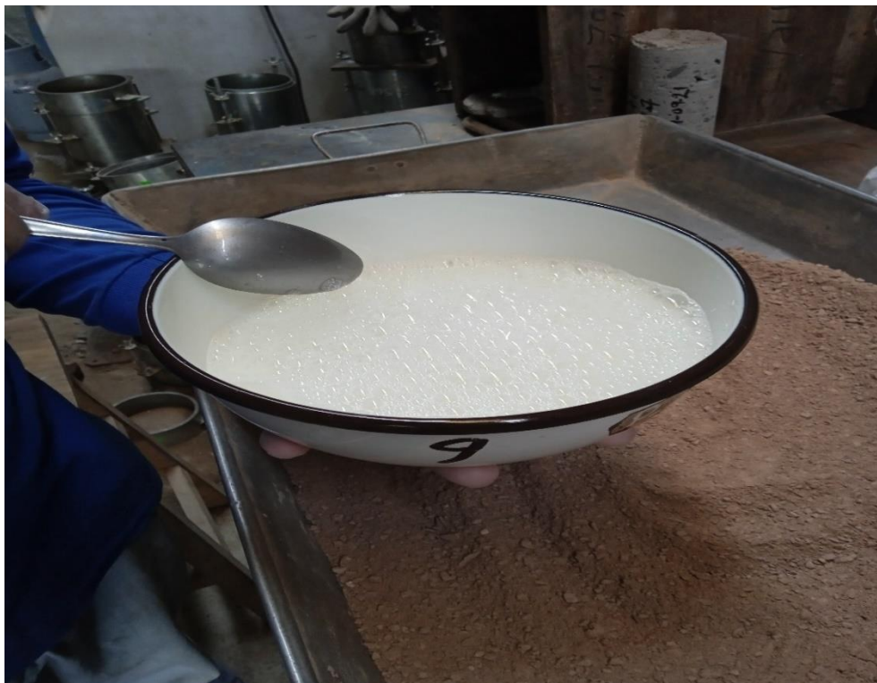
Figura 34: Polímero SSPMB, solución acuosa para ensayo de CBR por sustitución de agua Fuente: Elaboración propia
