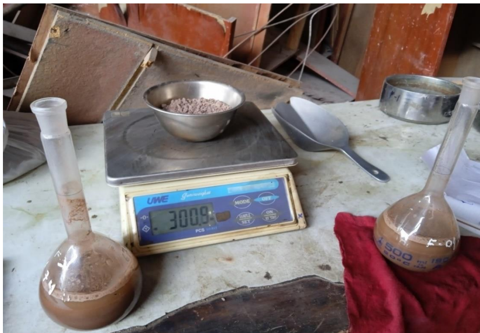
Figura 45: Visualización del contenido de arcilla por gravedad Fuente: Elaboración propia
