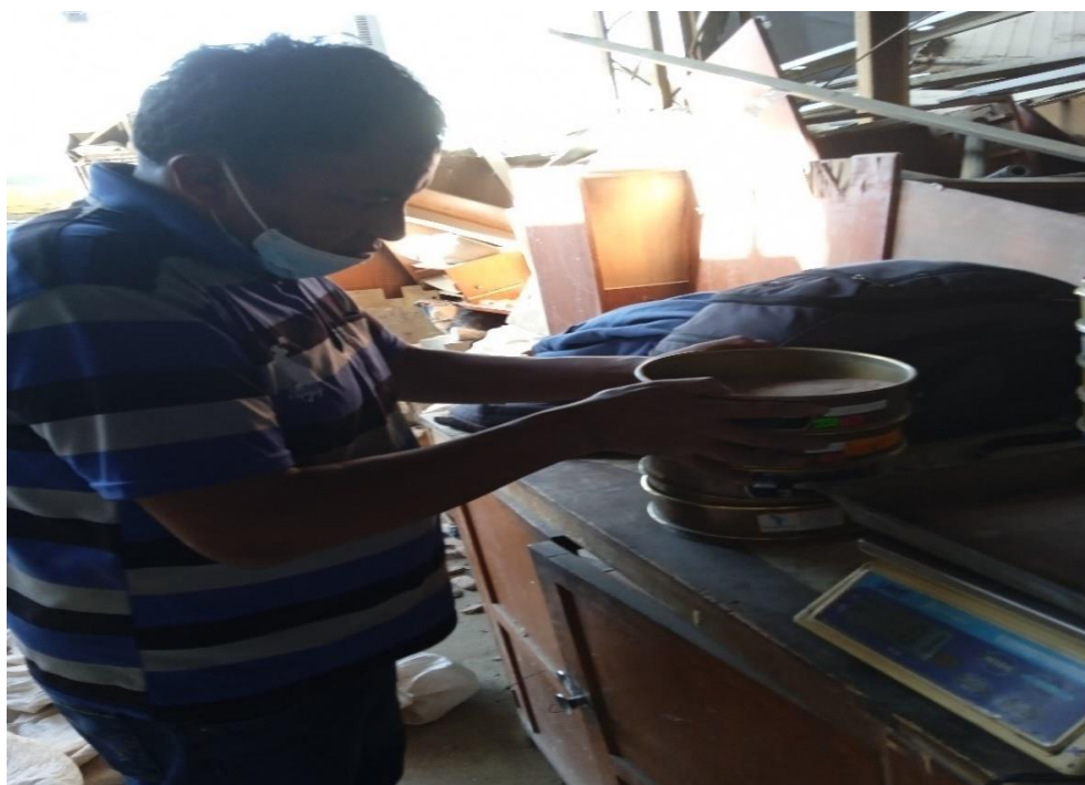
Figura 46: Separación de la arcilla por los tamices de 1", 3/4", 1/2" y 3/8" para ensayo de abrasión Fuente: Elaboración propia
