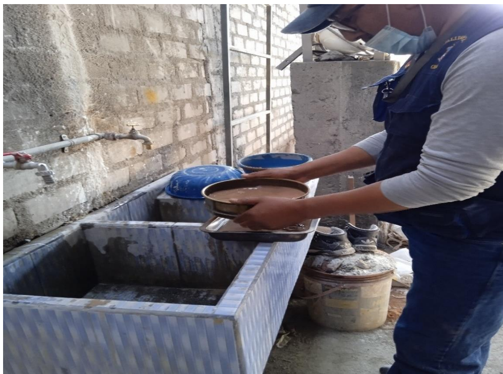
Figura 25: Ensayo de constantes físicas ASTM D-4318 Límite líquido Fuente: Elaboración propia
