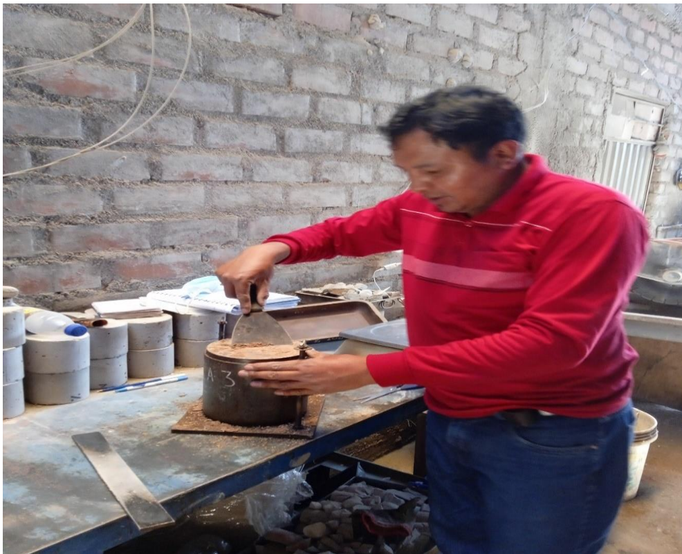
Figura 36: Muestras de diferentes dosificaciones para ensayos de CBR listos para ser curados Fuente: Elaboración propia
