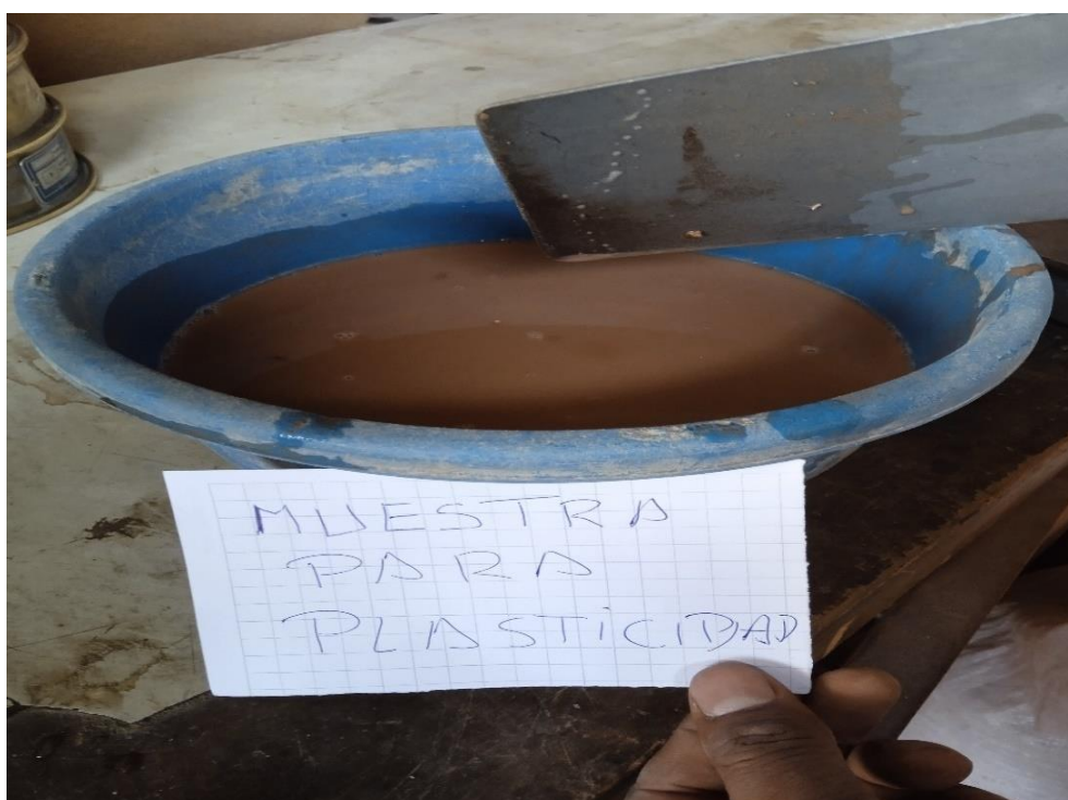
Figura 26: Ensayo de constantes físicas ASTM D-4318 Límite plástico Fuente: Elaboración propia
