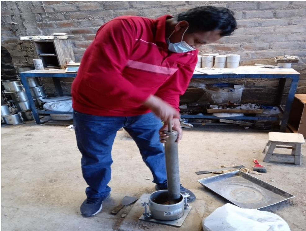
Figura 32: Compactación de la muestra con un pisón normado, para Proctor Fuente: Elaboración propia
