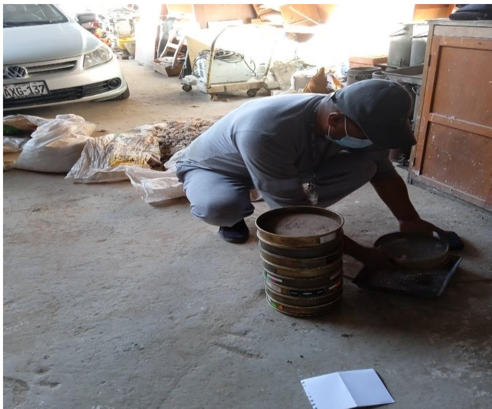
Figura 48: Ensayo de partículas fracturadas ASTM D5821 Fuente: Elaboración propia
