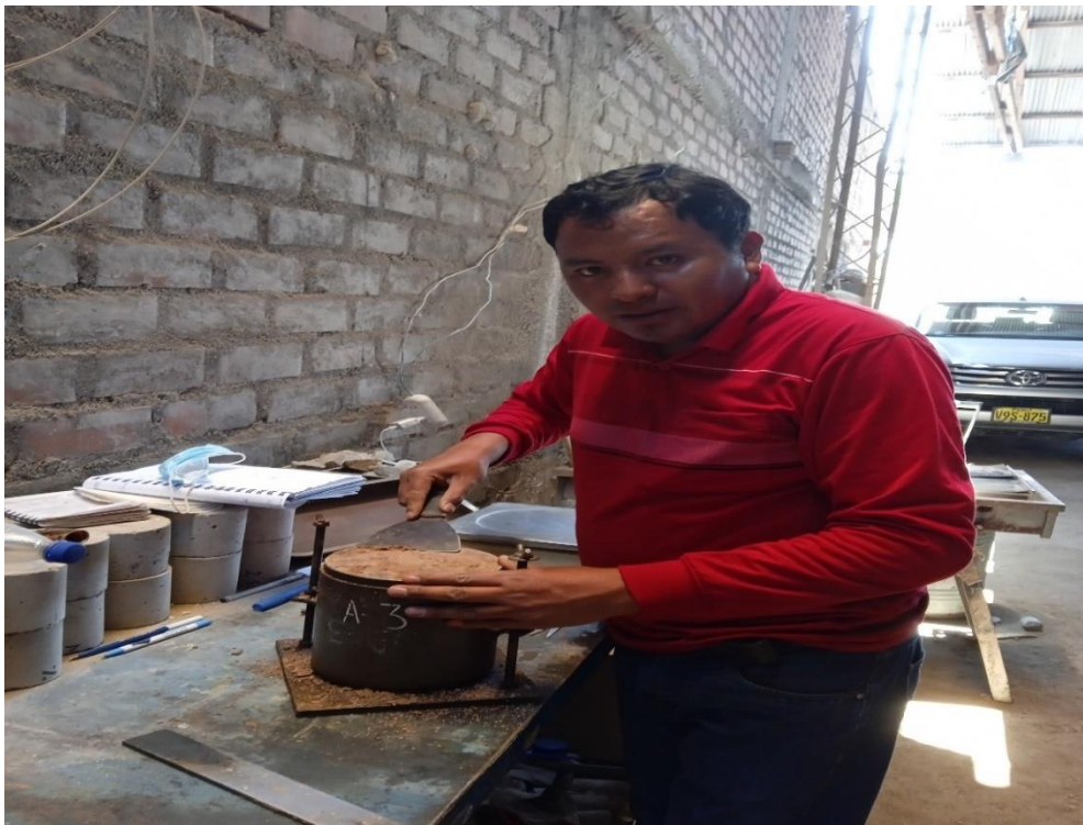
Figura 51: En el ensayo de Proctor y preparación Fuente: Elaboración propia
