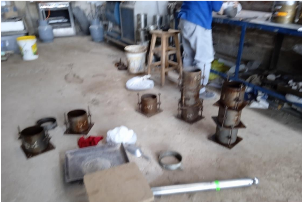
Figura 35: Muestras de diferentes dosificaciones para ensayos de CBR siendo compactadas Fuente: Elaboración propia
