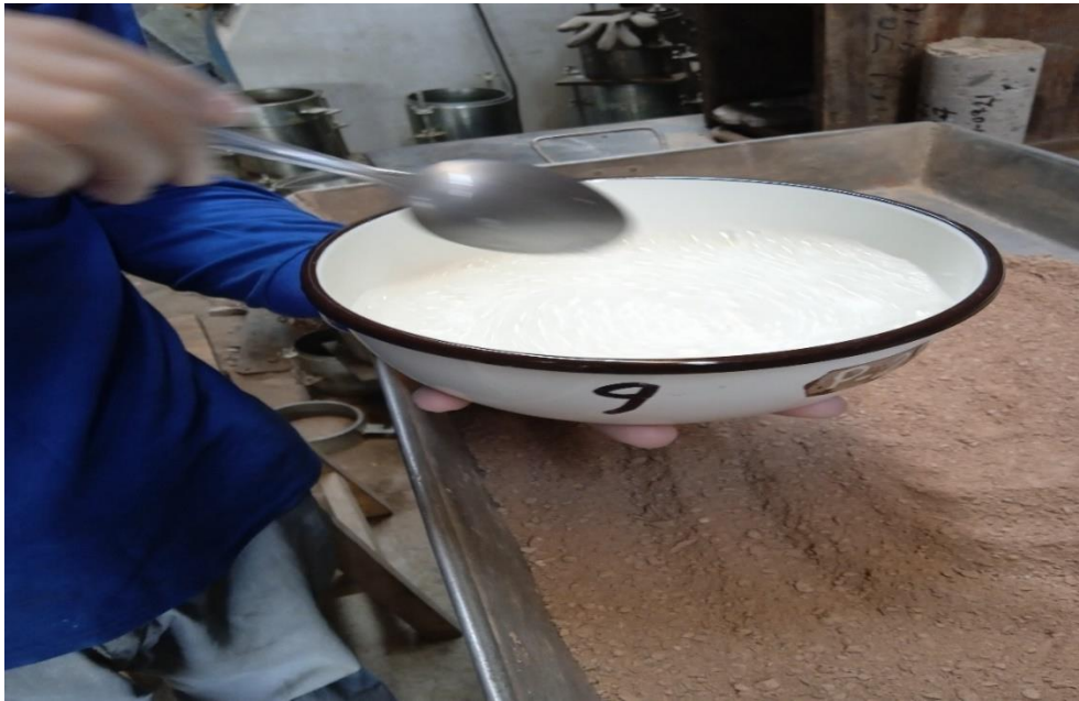
Figura 33: Preparación de las cantidades de agua y polímero a diferentes dosificaciones Fuente: Elaboración propia
