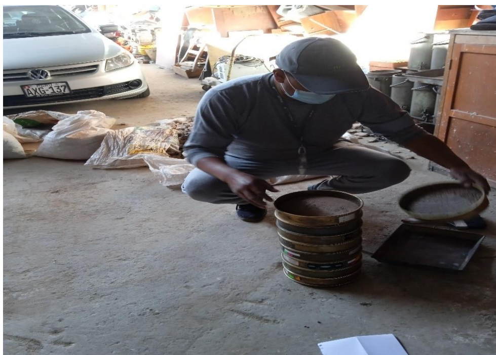
Figura 40: Ensayo de análisis granulométrico para la muestra alterada Fuente: Elaboración propia
