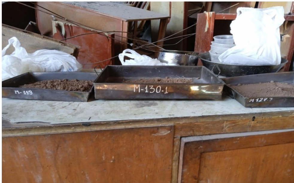
Figura 42: Ensayo de arcilla ASTM D4791 Fuente: Elaboración propia
