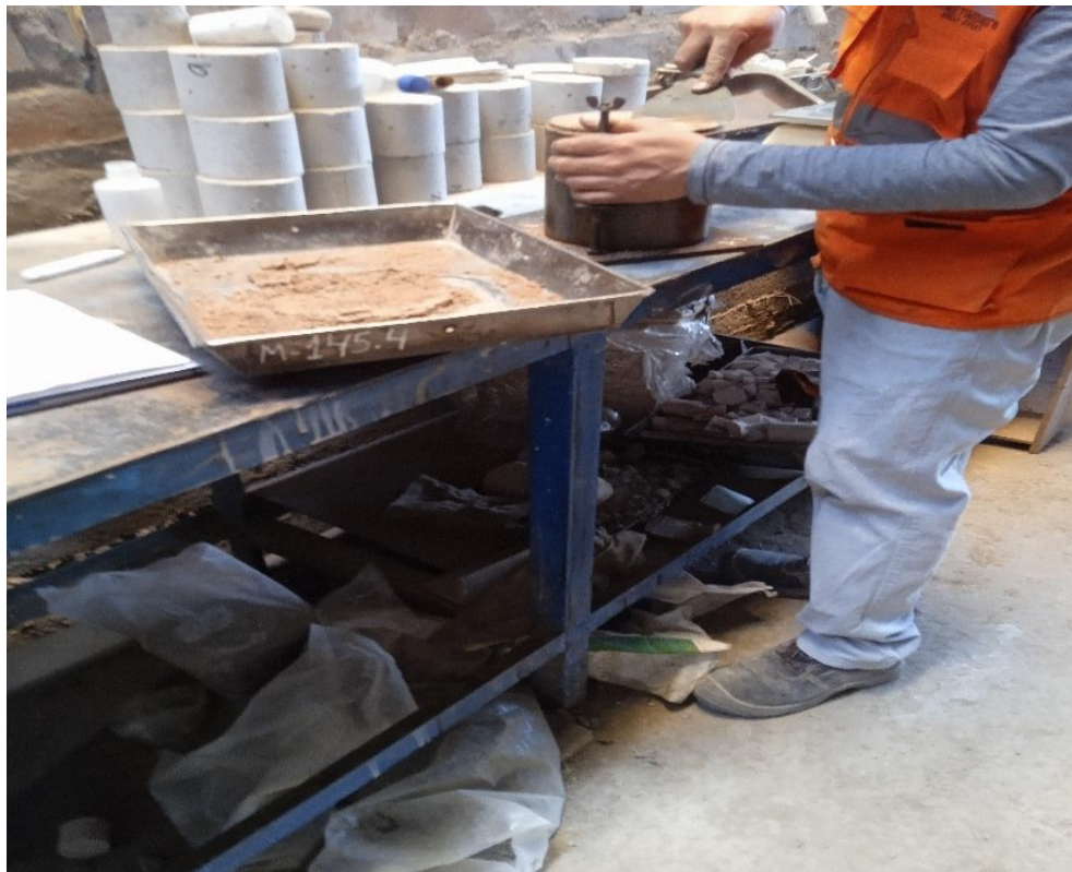
Figura 44: Ensayo de equivalente de arcilla ASTM D2419 Fuente: Elaboración propia
