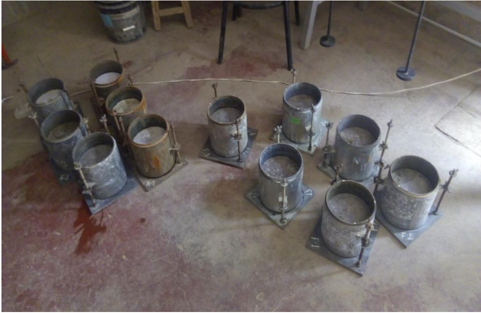
Figura 60: Diferentes muestras de las dosificaciones CBR natural, 1-3, 1-6 y 1-9 Fuente: Elaboración propia
