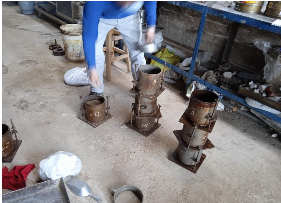
Figura 37: Muestras de CBR tomando las expansiones a través del dial Fuente: Elaboración propia
