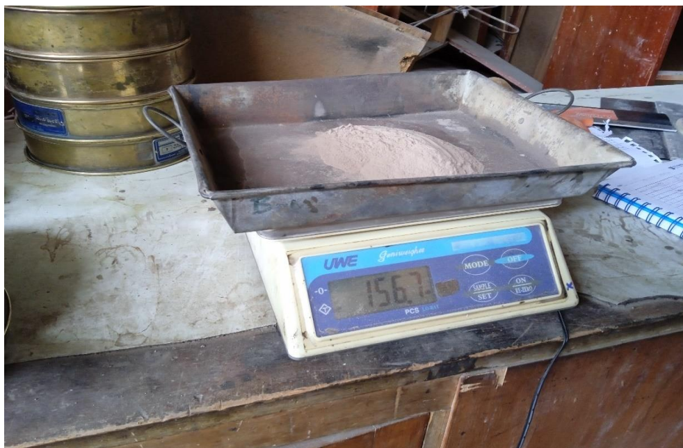
Figura 43: Ensayo de equivalente de arcilla ASTM D2419 Fuente: Elaboración propia
