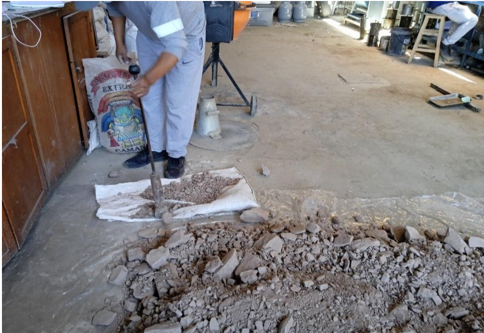
Figura 31: Preparación de las muestras para Proctor modificado Fuente: Elaboración propia
