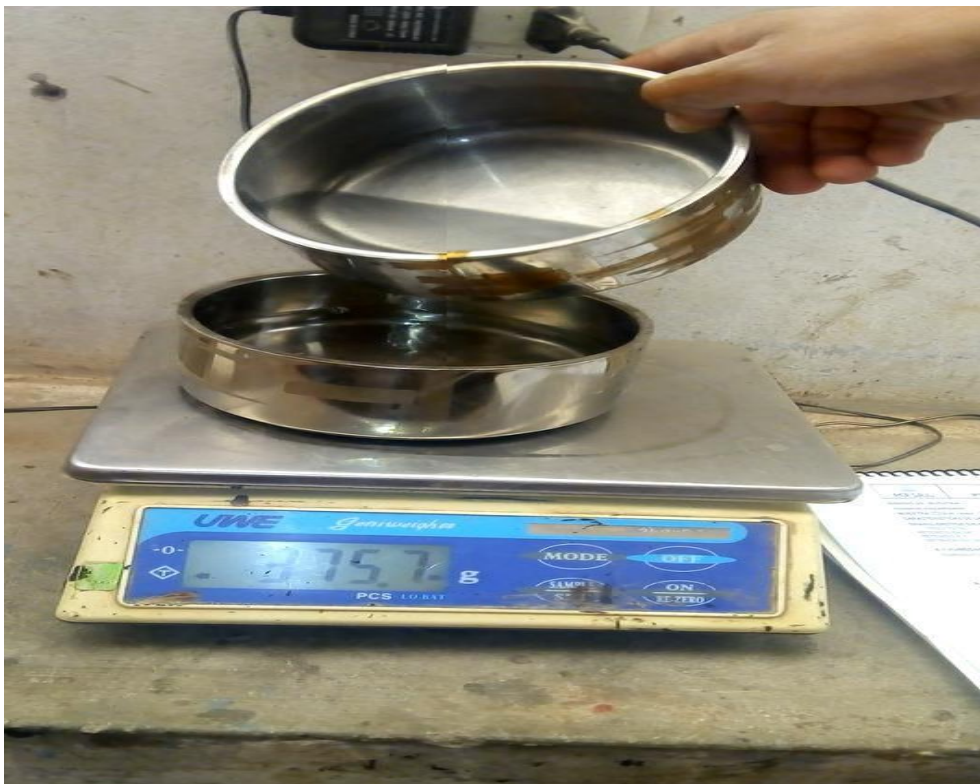
Figura 57: Preparación del polímero para ensayo de CBR Fuente: Elaboración propia
