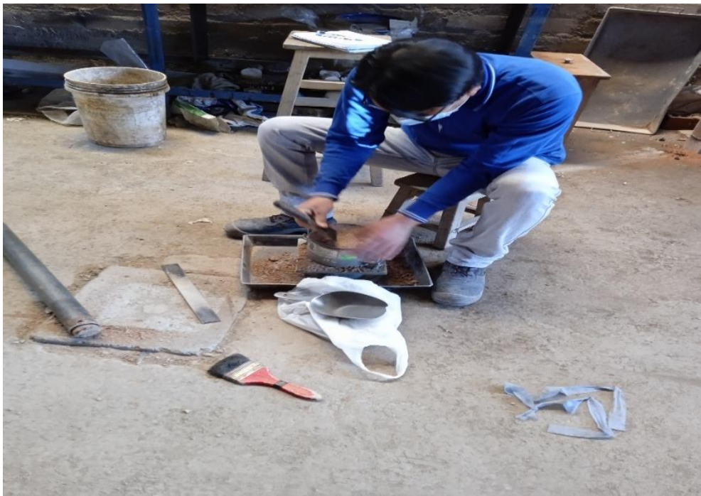
Figura 59: Preparación de la muestra alterada con el polímero, mezclado Fuente: Elaboración propia
