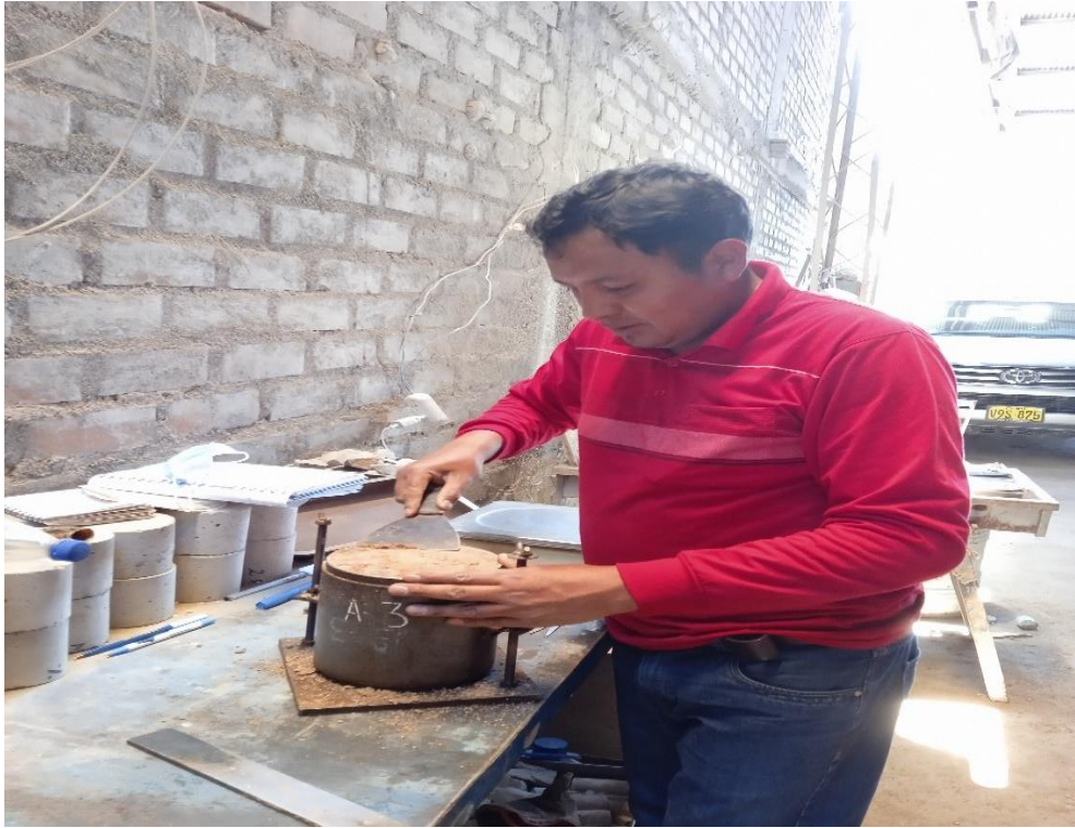
Figura 58: Muestra alterada con adición del polímero al 3% Fuente: Elaboración propia
