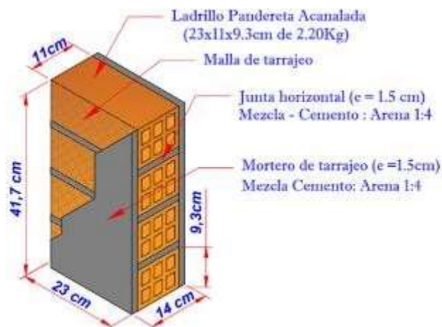
Figura 26. Pilas con malla de tarrajeo
