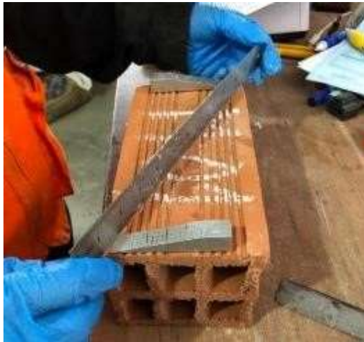
Figura 21. Alabeo de unidades de albañilería tubular.
