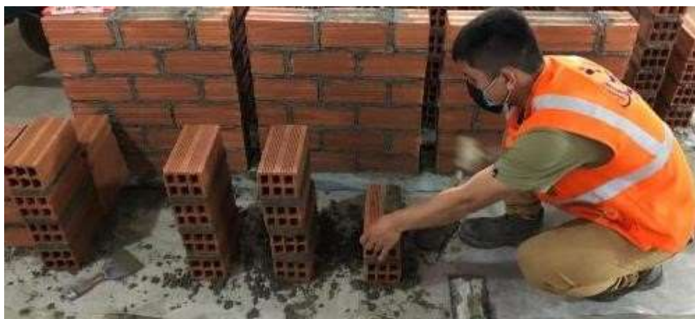
Figura 15.Procedimiento de pilas tradicional
