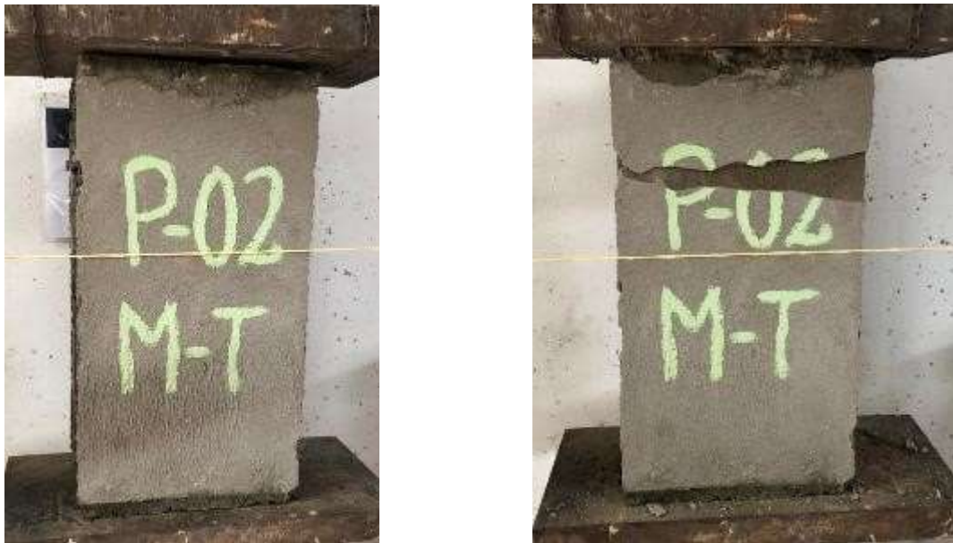
Figura 30. Pilas de malla de tarrajeo antes y después
