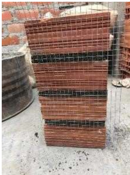
Figura 18. Procedimiento de pilas con alambre galvanizado
