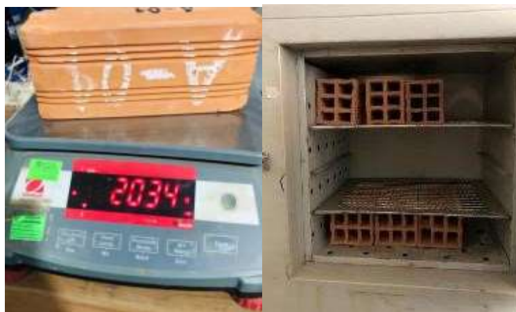
Figura 22. Absorción de unidades de albañilería tubular
