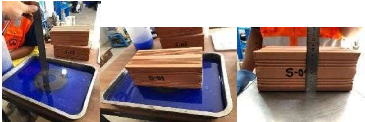
Figura 23. Ensayo de succión en unidades tubulares
