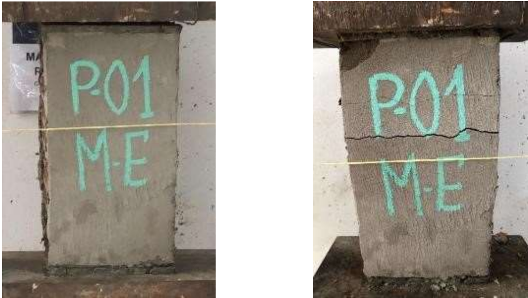
Figura 29. Pilas de malla electrosoldada antes y después
