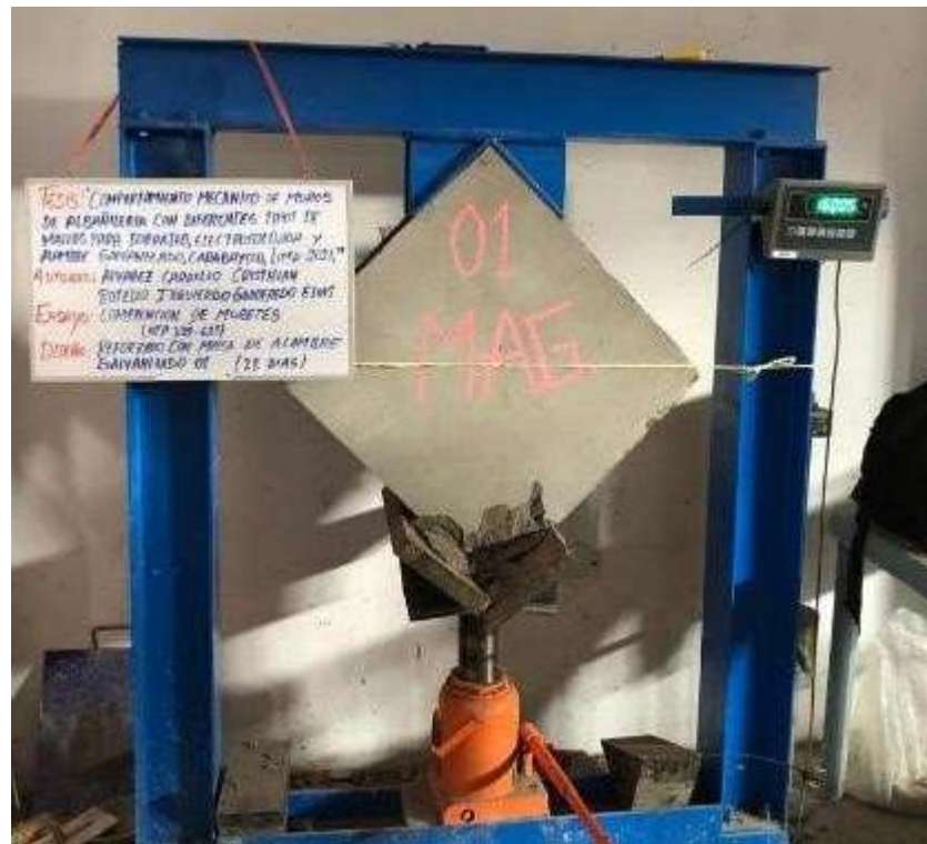
Figura 43. Murete de malla de alambre galvanizado después
