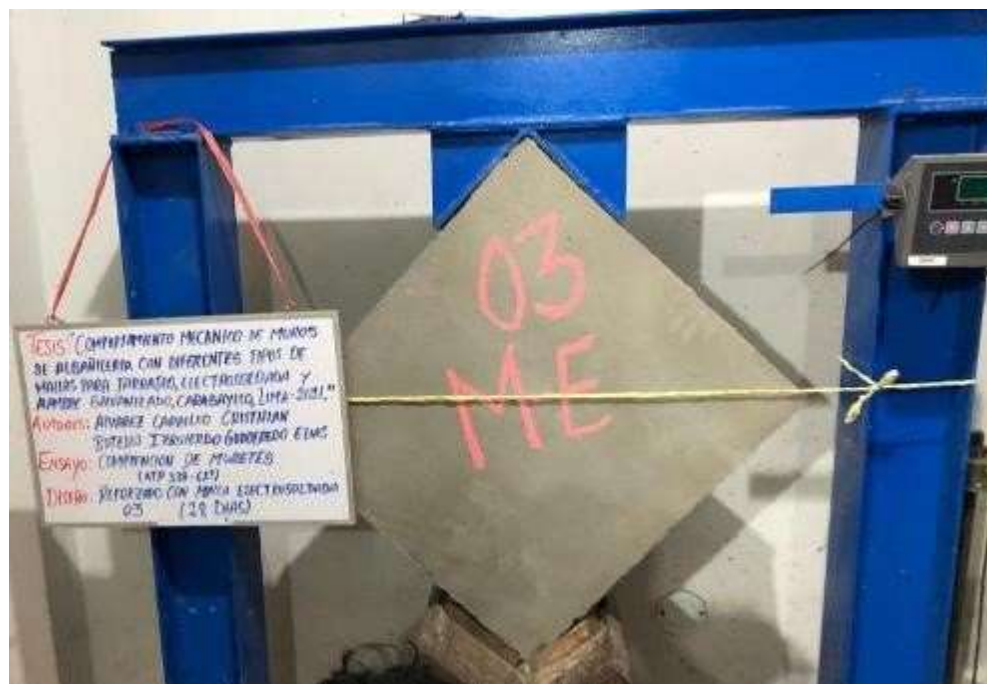
Figura 38. Murete de malla electrosoldada antes
