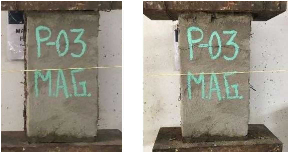
Figura 31. Pilas de malla de alambre galvanizado antes y después
