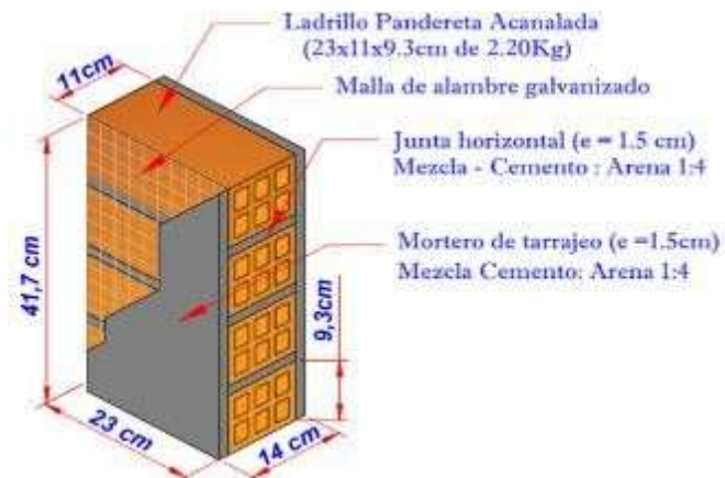
Figura 27. Pilas con malla de alambre galvanizado
