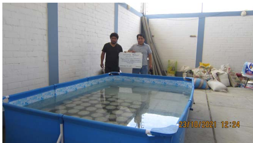
Figura 29. Curado de concreto de briquetas y vigas.
