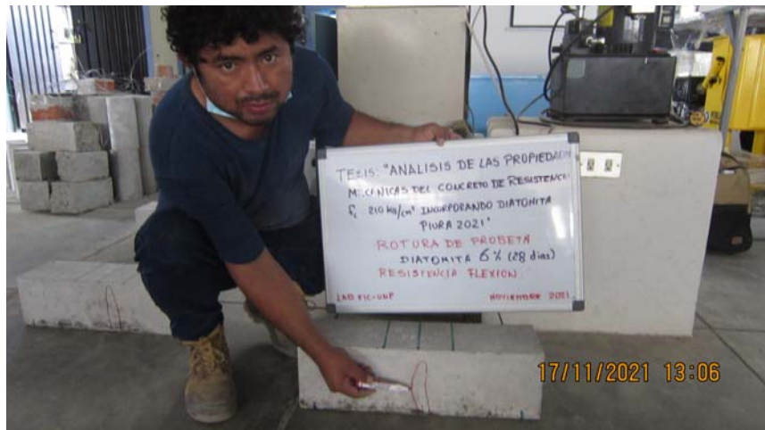
Figura 34. Falla en el tercio central de la viga - Resistencia a la flexión.
