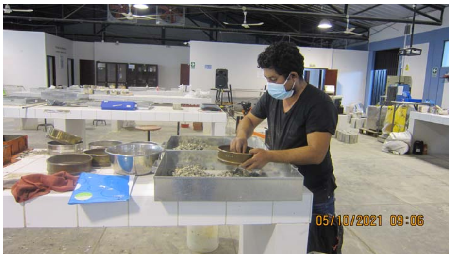
Figura 22. Proceso para determinar la granulometría de los agregados. Fuente: Elaboración propia para la tesis.
