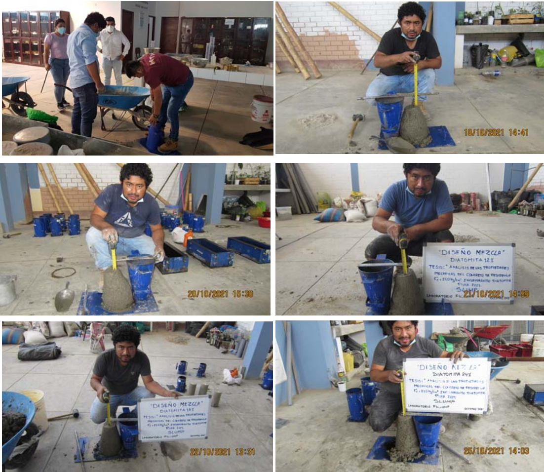
Figura 25. Asentamiento de concreto con adición de diatomita.
