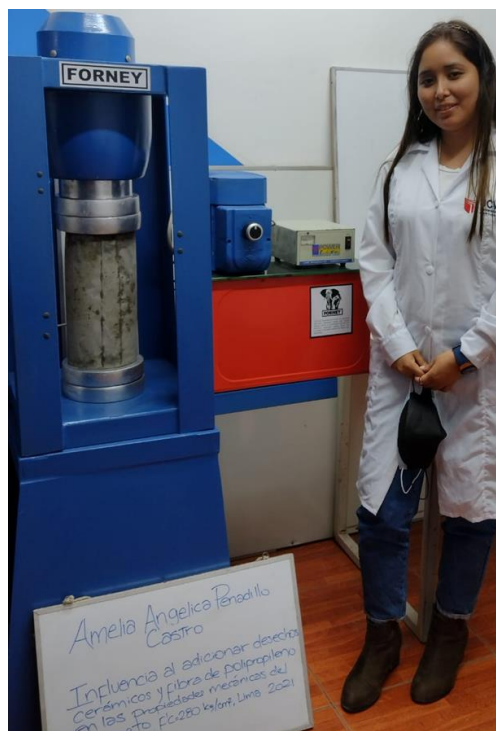
Figura 14: Ruptura de probetas cilíndricas
