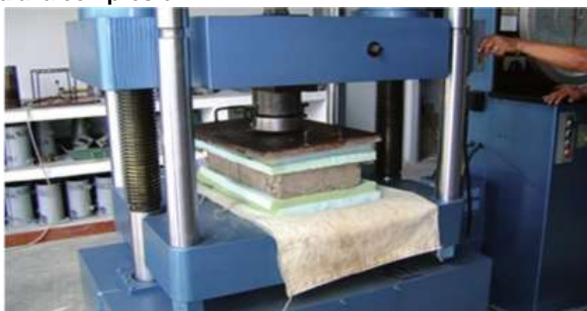
Figura 3. Ensayo a la compresión
