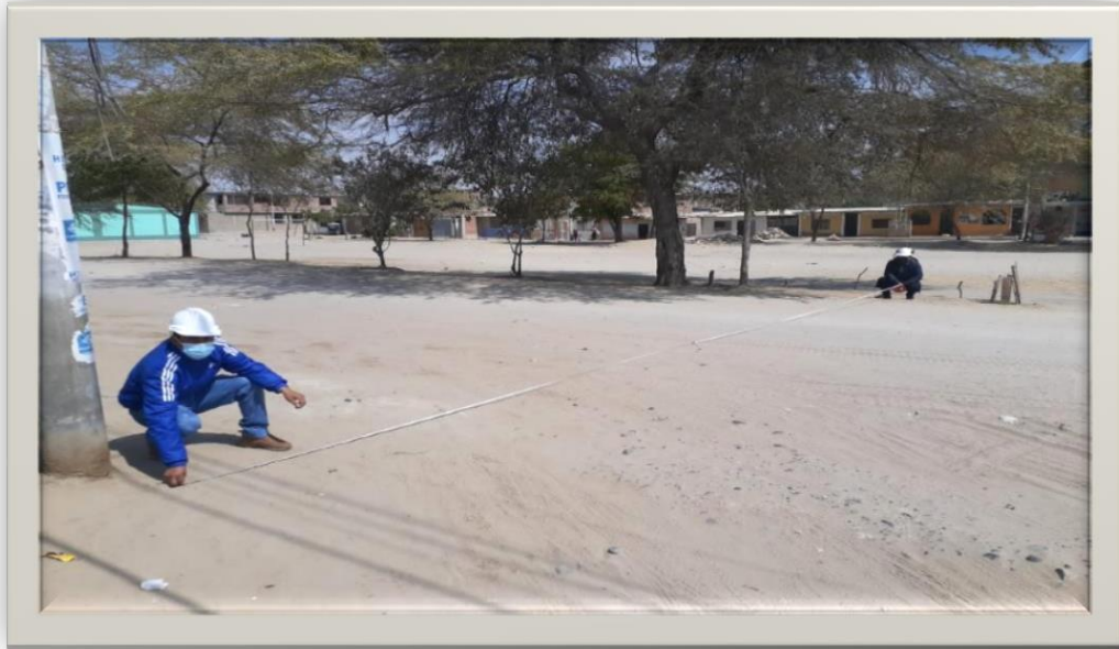
Foto 10: Se aprecia a los estudiantes midiendo el ancho de la calzada en la Av. "D" del AA.HH los Algarrobos.
