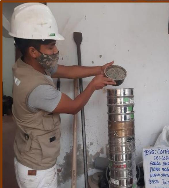
Figura N°06: Se realizó el ensayo de granulometría a las muestras.
