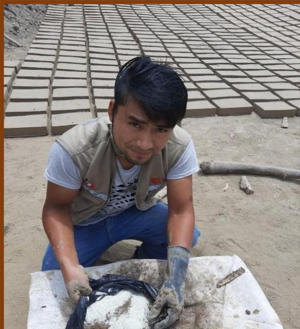
Figura N°03: Se realizó la adición del vidrio molido para proceder a hacer los ladrillos.
