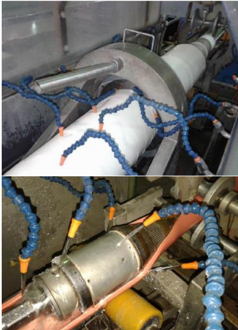
Figura N° 15 Unidad de Orientación Molecular Biaxial
