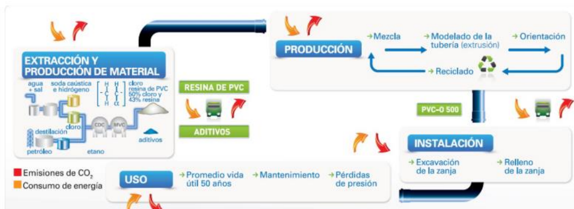
Figura N° 6 Ciclo de vida de las tuberías de PVC-O
