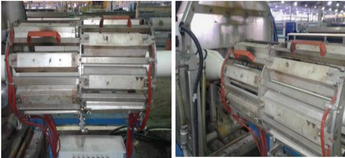
Figura N° 13 Unidad de control térmico para precalentamiento
