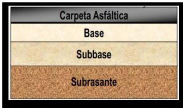
*Figura 3.* Estructura del pavimento flexible. Tomada de «Cartilla-Guía ilustrativa del proceso constructivo de un pavimento flexible para bajos volúmenes de tránsito», por Garzon y Hernandez. 2018, p. 5.
