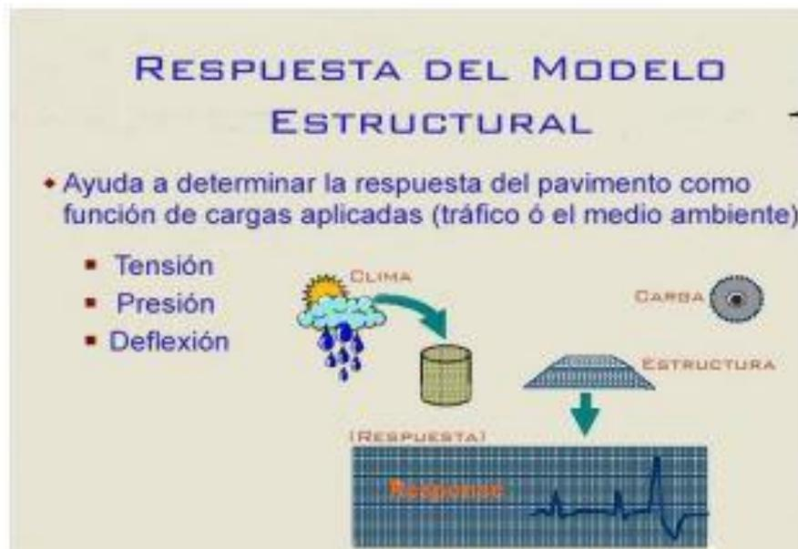
*Figura 18* Datos de entrada para respuesta de la modelo estructural. Tomada de «Análisis comparativo para diseño de pavimentos flexibles mediante las alternativas: IMT-PAVE y CR-ME del método mecanicista empirico, con el método AASHTO 93.», por García, Gutiérrez y Hernández, 2014, p. 19.
