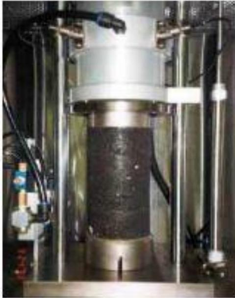
*Figura 19* Ensayo de módulo dinámico. Tomada de «Análisis comparativo para diseño de pavimentos flexibles mediante las alternativas: IMT-PAVE y CR-ME del método mecanicista empirico, con el método AASHTO 93.», por García, Gutiérrez y Hernández, 2014, p. 24.
