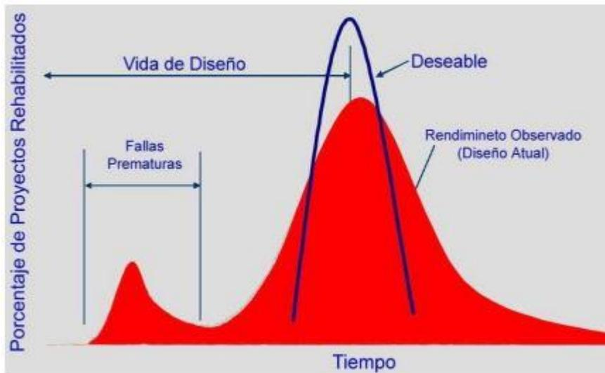
Figura 17 Desempeño de la Vía y su predicción. Tomada de «Análisis comparativo para diseño de pavimentos flexibles mediante las alternativas: IMT-PAVE y CR-ME del método mecanicista empírico, con el método AASHTO 93», por García, Gutiérrez y Hernández, 2014, p. 17.
