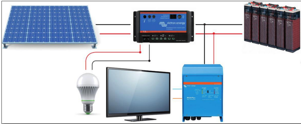
Figura 4. Instalaciones solares fotovoltaicas.
