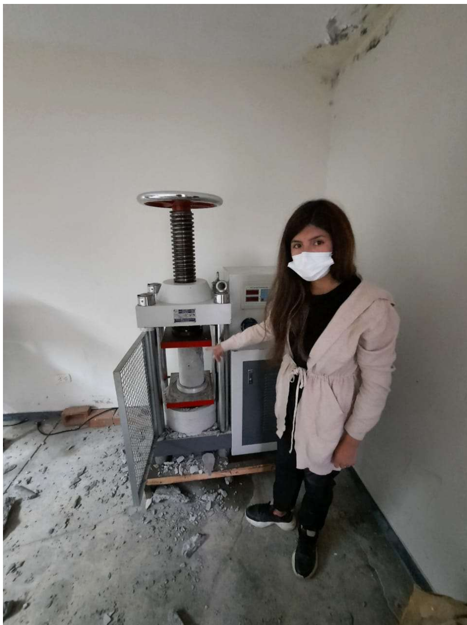
Figura° 015. Rotura de briqueta del concreto Fuente: Elaboración propia
