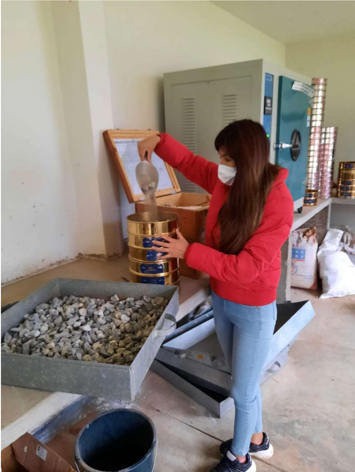
Figura° 012. Tamizado de agregado grueso Fuente: Elaboración propia
