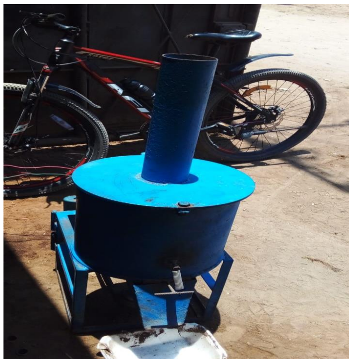
Maquina adaptada para pulverizar vidrio.
