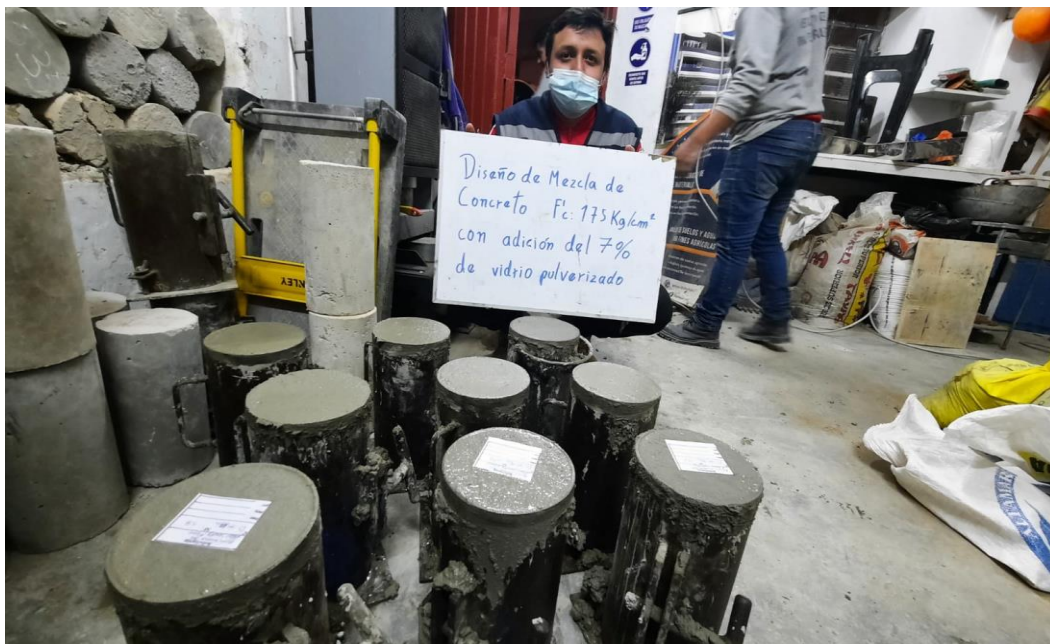
Probetas con adición del 7% de vidrio pulverizado.
