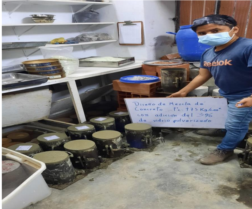
Probetas con adición del 3% de vidrio pulverizado.
