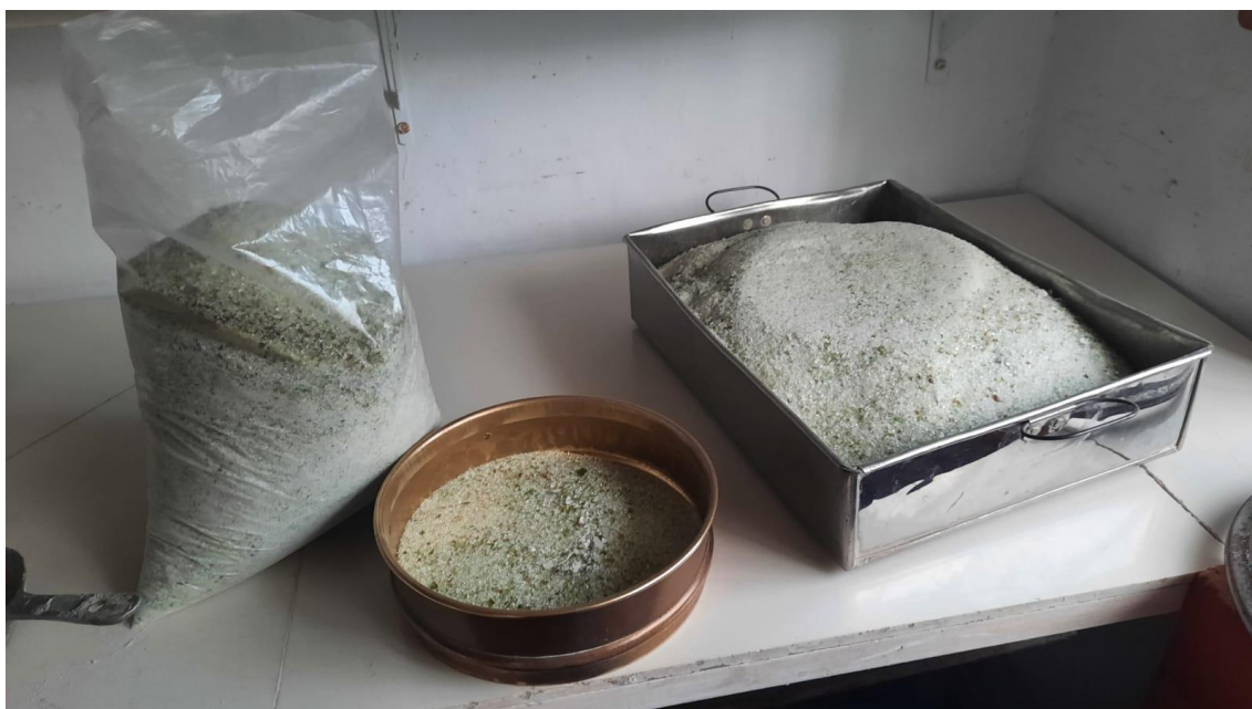
Vidrio pulverizado y tamizado en laboratorio.
