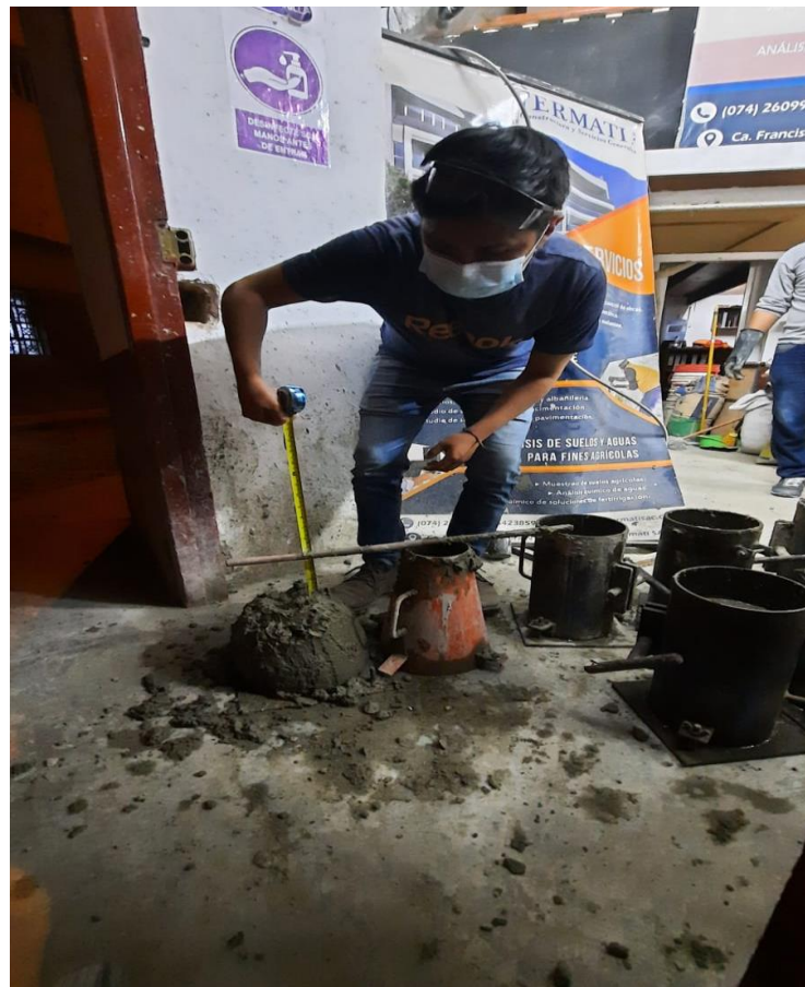
Prueba del slump.
