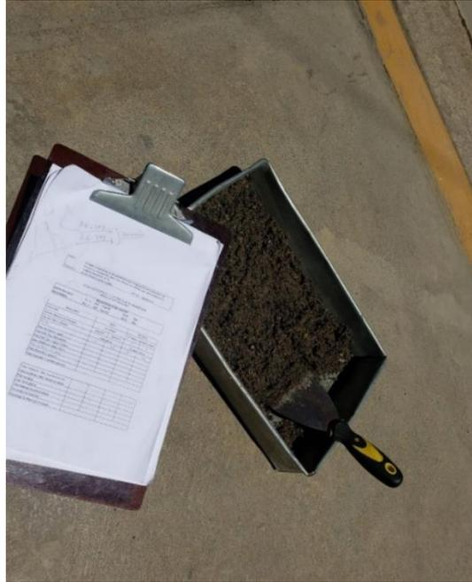
*Fotografía 5: Secado al aire libre del agregado fino para hallar el porcentaje de Absorción.*
