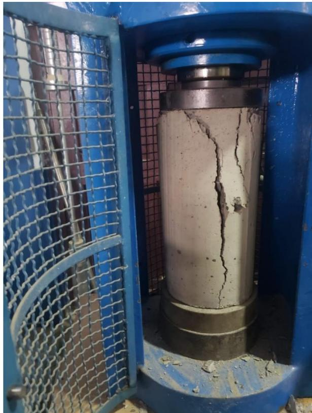
*Fotografía 13: Rotura de probeta 10% (fisuras verticales).*
