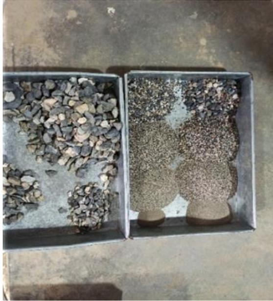
*Fotografía 3: Resultado del tamizado de los agregados Fino y Grueso.*
