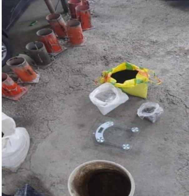
*Fotografía 9: Materias les usados para la elaboración de las probetas de concreto.*
