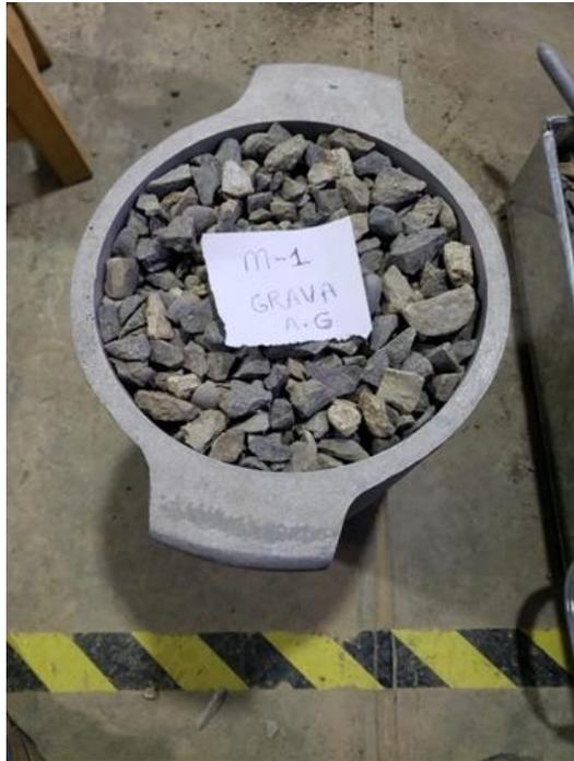
*Fotografía 4: Muestra de agregado Grueso para calcular el peso unitario suelto y compactado.*
