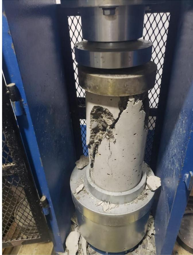
*Fotografía 14: Rotura de probeta 15% (fisuras verticales).*
