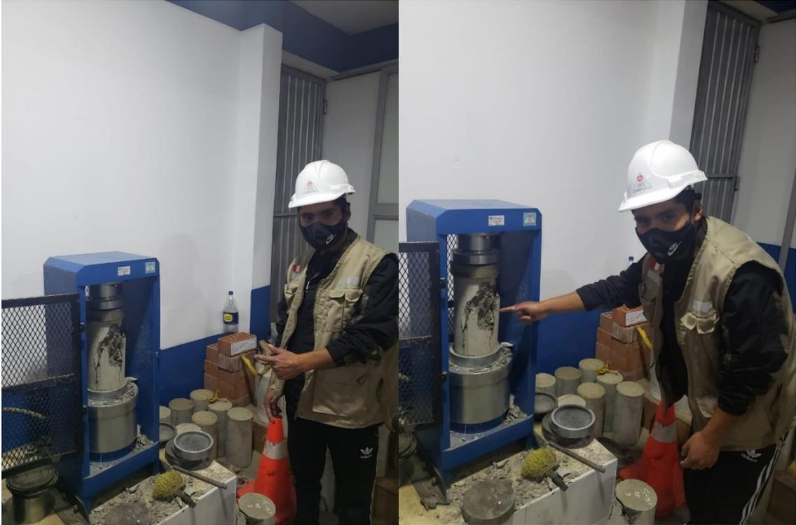
*Fotografía 12: Rotura de probetas de concreto patrón y sustituyendo el cemento.*
