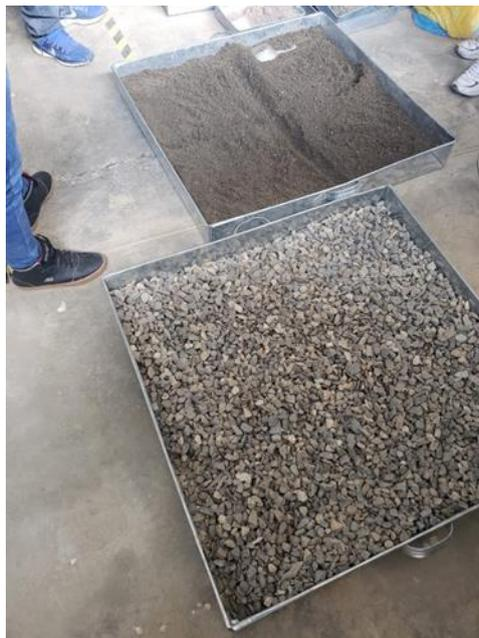
**Fotografía 2: Cuarteo del Agregado Fino y Grueso para realizar el ensayo de contenido de humedad.**
