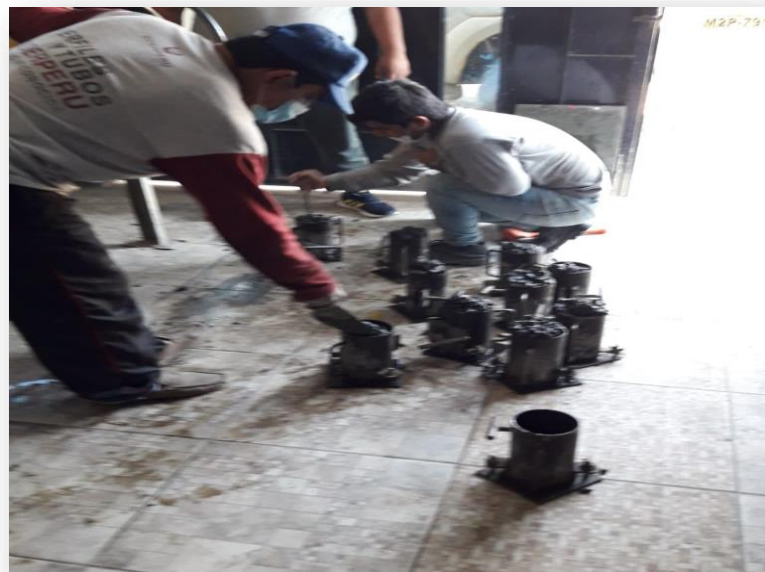
Foto 4: Colocación de probetas del ensayo patrón
