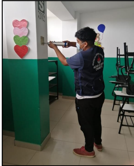
Figura 19: Ensayo de esclerometría en columna
