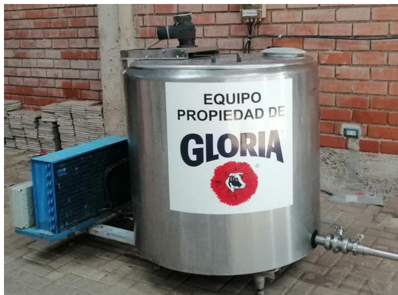
Figura 16. Tanque de enfriamiento de leche.
