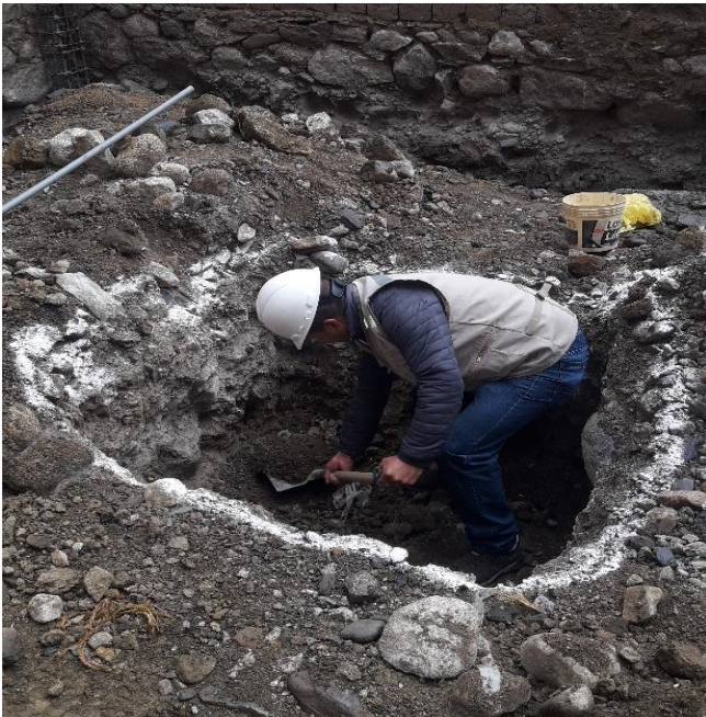
Fotografía 6. Calicata N°02 para la obtención de muestras para análisis y estudios en laboratorio.
