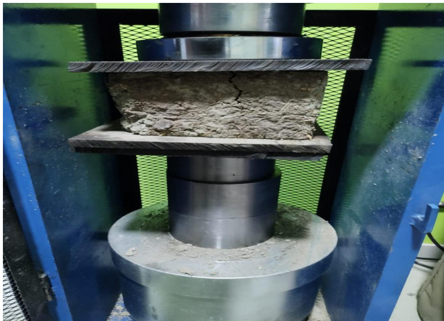
Fotografía 11. Ensayos de resistencia a la compresión de unidades de adobe.
