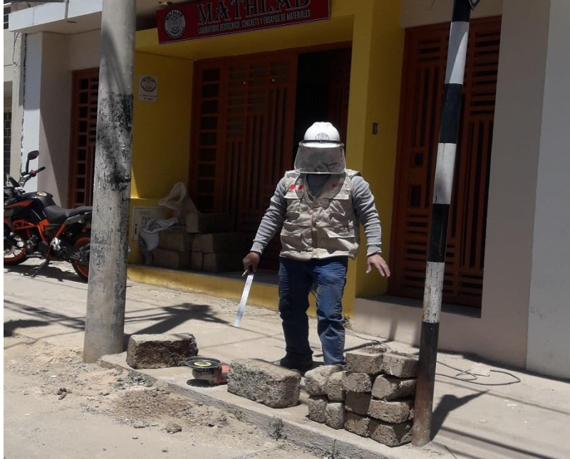
Fotografía 9. Tomar medida de unidades de adobe para ensayos de resistencia a la compresión.
