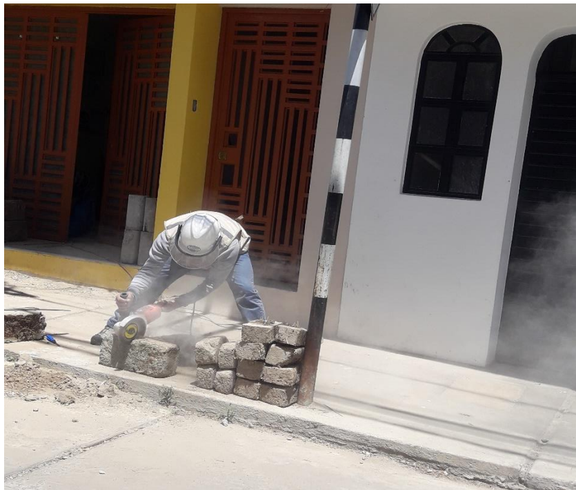
Fotografía 10. Corte de unidades de adobe para ensayos de resistencia a la compresión.
