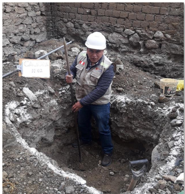
Fotografía 6. Calicata N°02 para la obtención de muestras para análisis y estudios en laboratorio.
