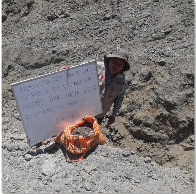
Fotografía 5. Calicata N°01 para obtención de muestras para análisis y estudios en laboratorio.
