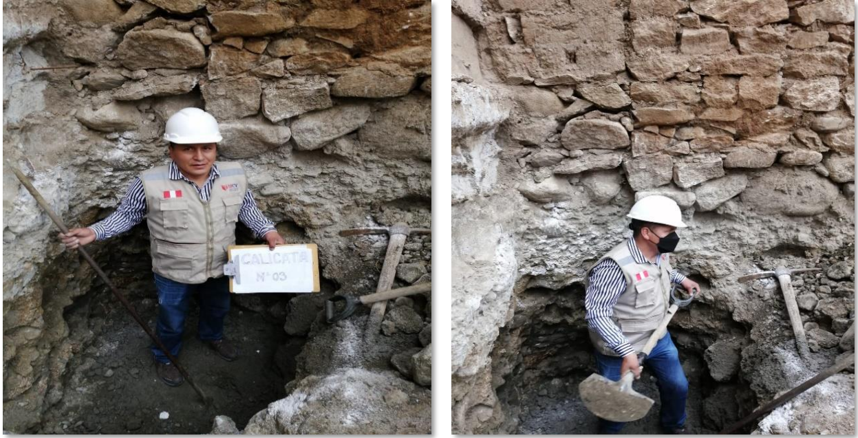
Fotografía 7. Calicata N°03 para la obtención de muestras para análisis y estudios en laboratorio.
