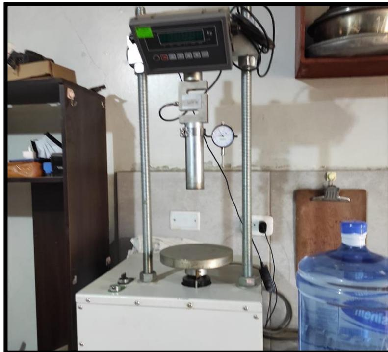
Foto 20: Equipo de penetración para realización de Ensayo de CBR
