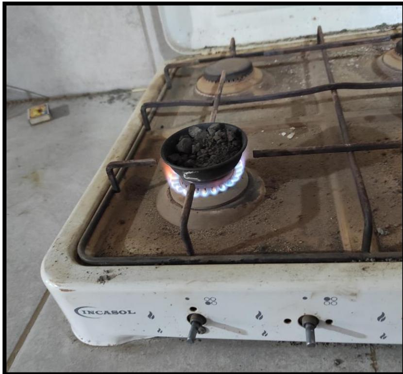
Foto 06: Secando muestra- Ensayo de Contenido de Humedad
