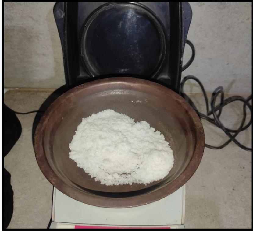
Foto 17: Pesaje del Cloruro de Sodio para la adición a la muestra
