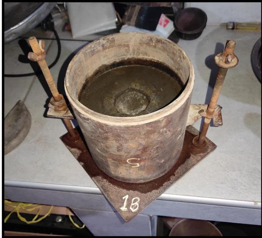
Foto 23: Vista de muestra después de realizarse el Ensayo de CBR
