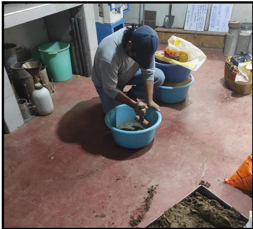
Foto 10: Preparando muestra para Ensayo de Proctor
