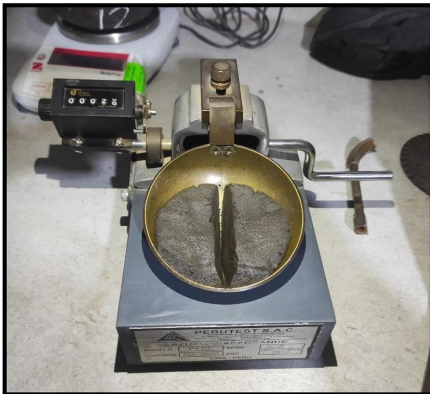
Foto 08: Muestra en la cuchara de Casagrande – Ensayo de Limite de Atterberg
