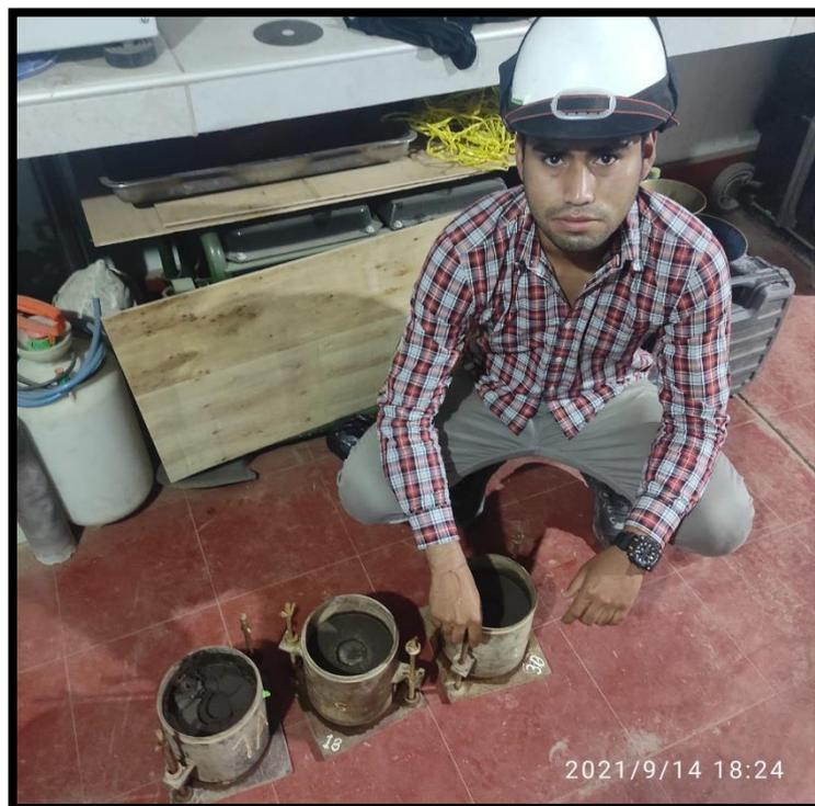
Foto 24: Vista de muestras después de realizarse el Ensayo de CBR
