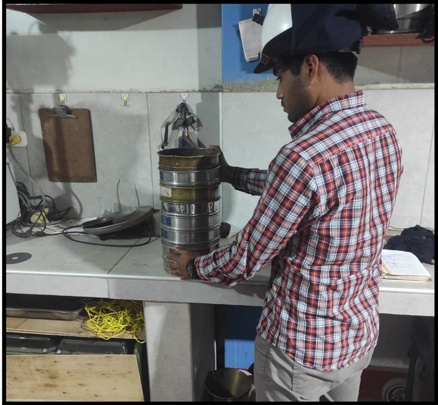
Foto 05: Pasando muestra por tamices- Ensayo de Análisis Granulométrico
