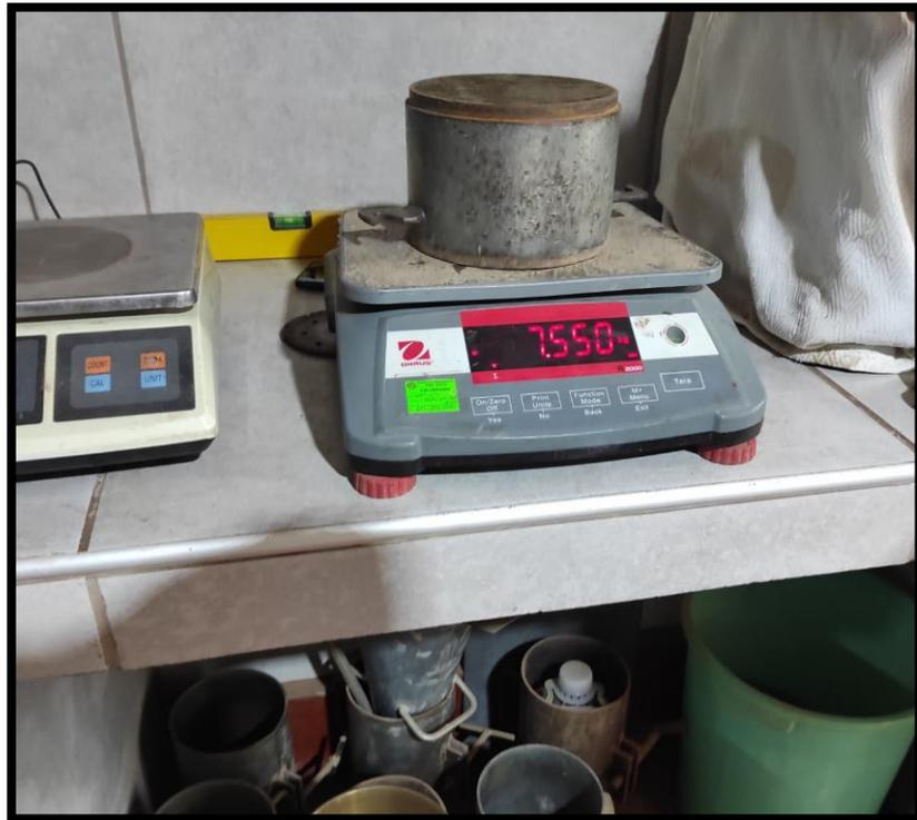
Foto 15: Pesaje de la muestra compactada con molde
