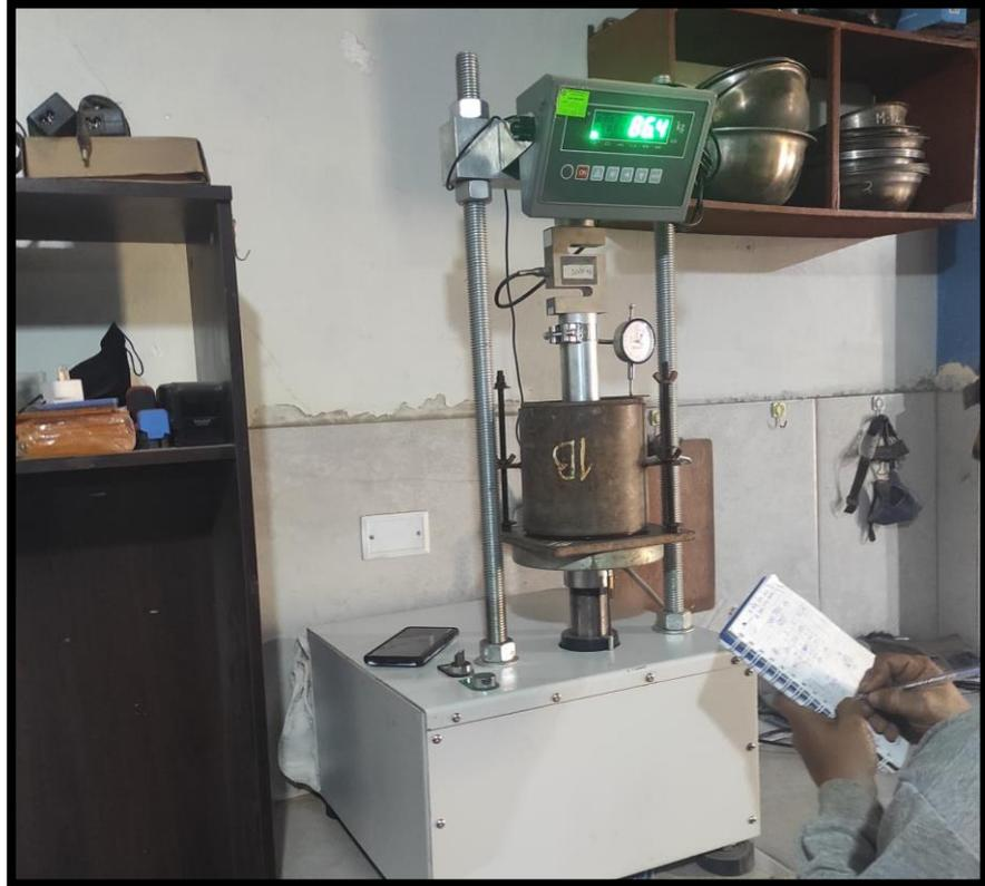
Foto 21: Equipo de penetración con muestra para ensayo de CBR
