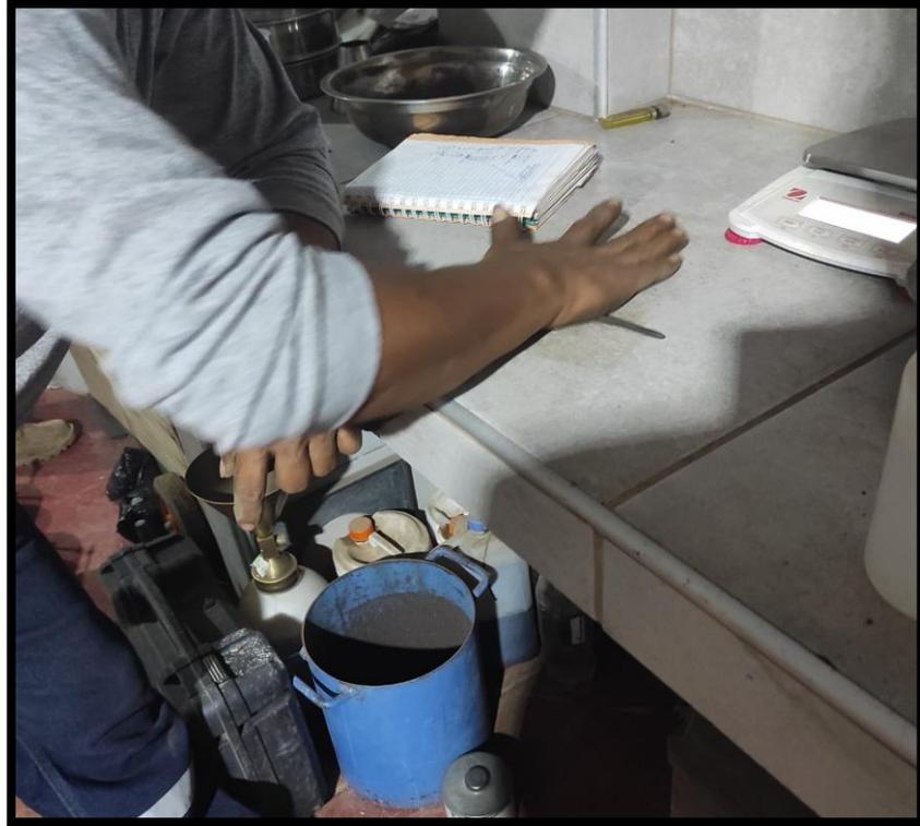
Foto 09: Limite Plástico - Ensayo de Limite de Atterberg
