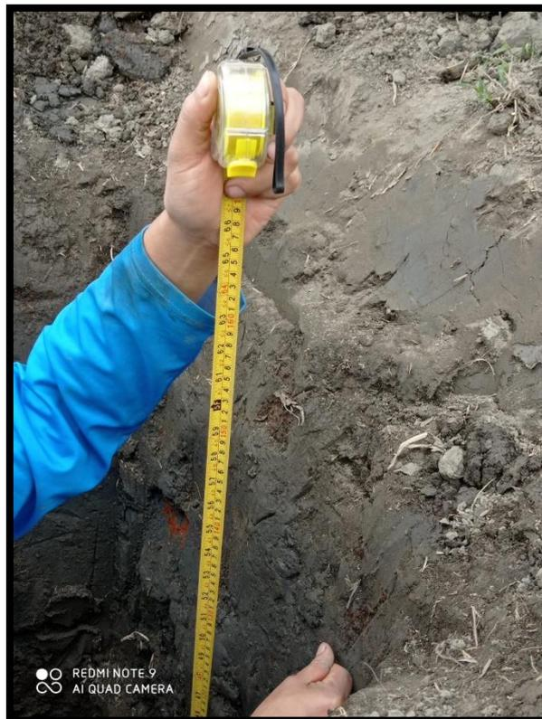
Foto 04: Medición de altura de calicatas  $h=1.50\text{m}$
