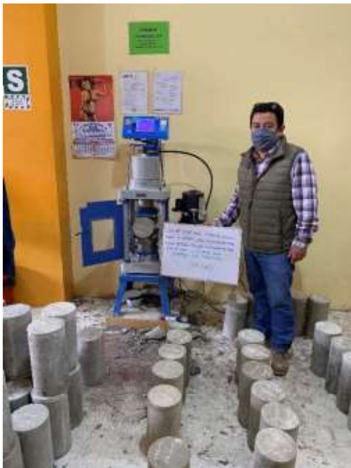
Ensayo de resistencia a la tracción del concreto f'c = 175 \text{ kg/cm}^2 y f'c = 210 \text{ kg/cm}^2 a los 28 días
