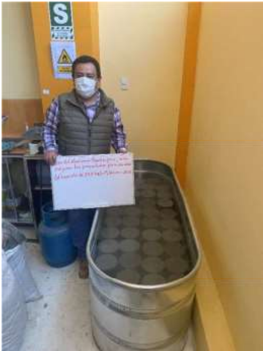
Curado de probetas de concreto desde su desmoldeo hasta la realización del ensayo de resistencia a la compresión y/o resistencia a la tracción
