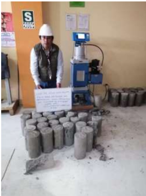
Ensayo de resistencia a la compresión del concreto f'_c = 245 \text{ kg/cm}^2 a los 14 días
