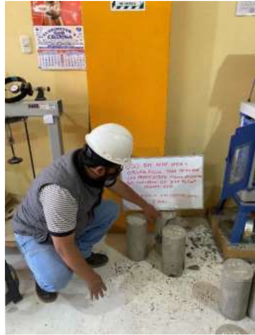
Ensayo de resistencia a la compresión del concreto f'_c = 245 \text{ kg/cm}^2 a los 7 días
