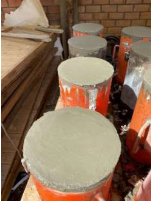
Moldeo, codificación y desmoldeo de probetas de concreto según dosificaciones pre-establecidas
