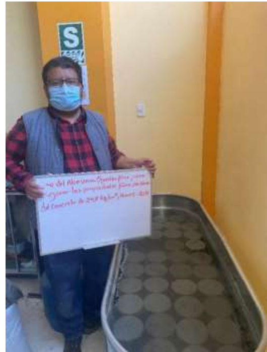
Curado de probetas de concreto desde su desmoldeo hasta la realización del ensayo de resistencia a la compresión y/o resistencia a la tracción
