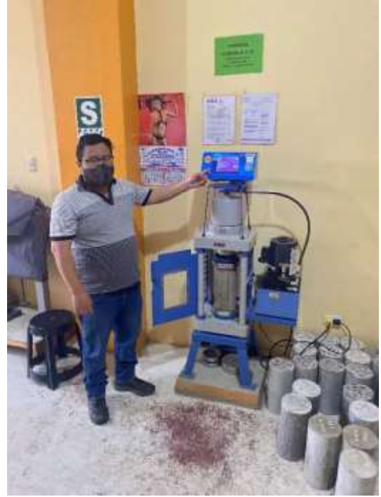
Ensayo de resistencia a la compresión del concreto f'_c = 245 \text{ kg/cm}^2 a los 28 días
