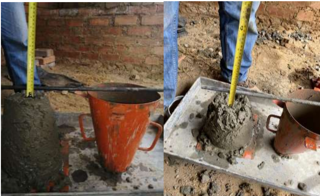
Figura 10. Prueba de asentamiento del concreto o slump
