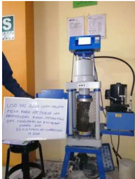
Ensayo de resistencia a la compresión del concreto f'_c = 245 \text{ kg/cm}^2 a los 14 días
