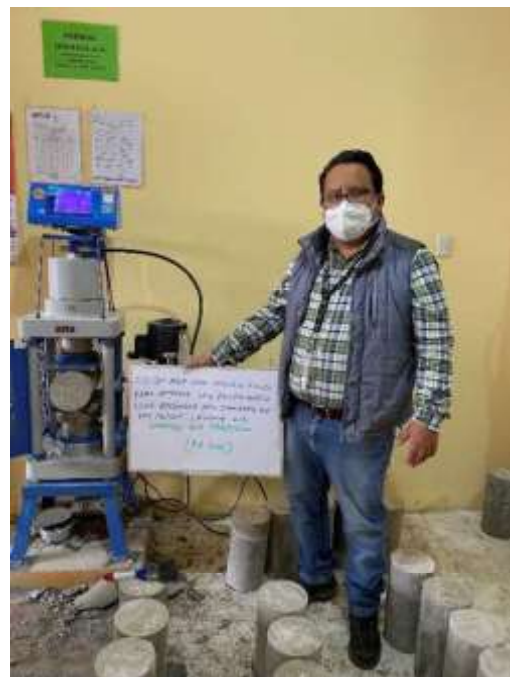
Ensayo de resistencia a la tracción del concreto f'c = 175 \text{ kg/cm}^2 y f'c = 210 \text{ kg/cm}^2 a los 28 días
