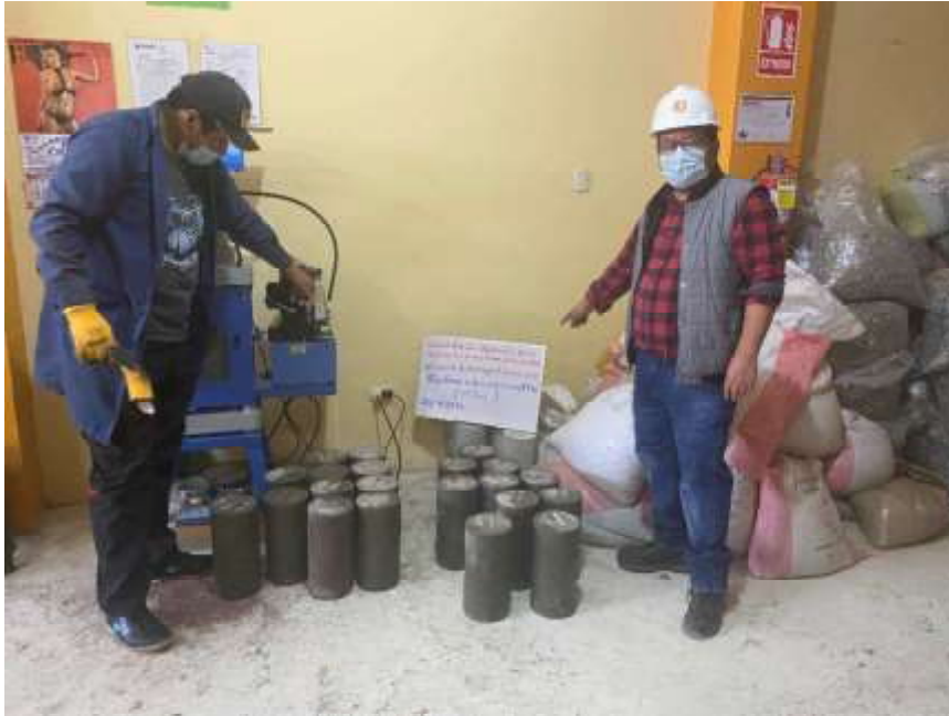
Ensayo de resistencia a la compresión del concreto f'c = 175 \text{ kg/cm}^2 a los 14 días
