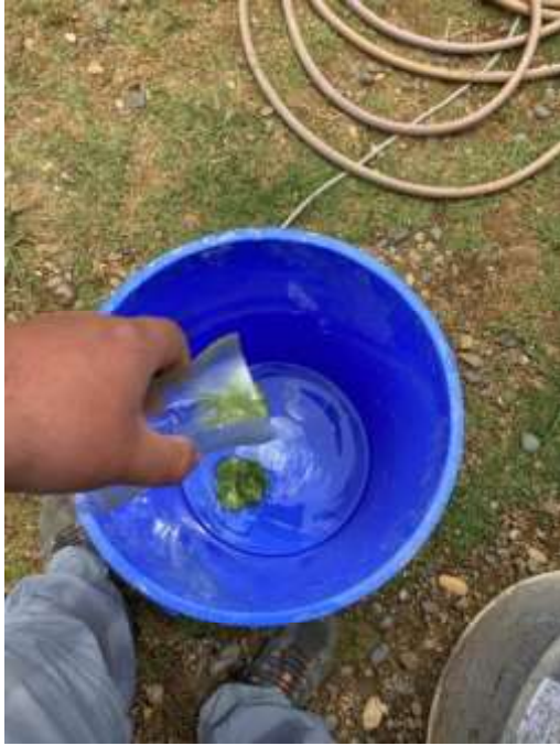
Preparación del agua para el concreto con la adición del extracto de Opuntia ficus y mucílago de Aloe vera
