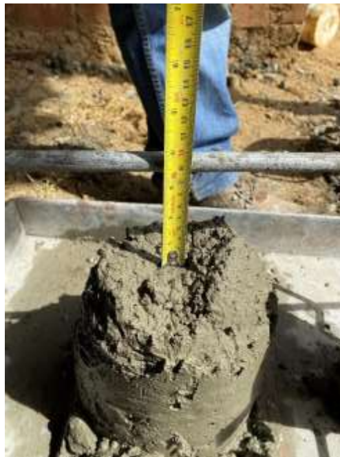
Figura 19. Medición del asentamiento de concreto
