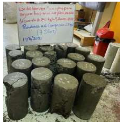
Ensayo de resistencia a la compresión del concreto f'c = 210 \text{ kg/cm}^2 a los 7 días
