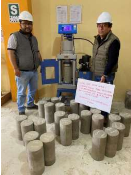
Ensayo de resistencia a la compresión del concreto f'_c = 245 \text{ kg/cm}^2 a los 7 días
