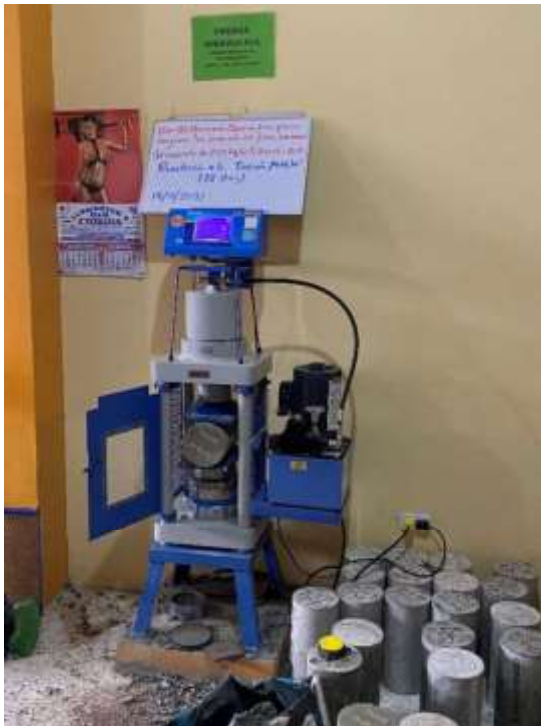
Ensayo de resistencia a la tracción del concreto f'_c = 245 \text{ kg/cm}^2 a los 28 días
