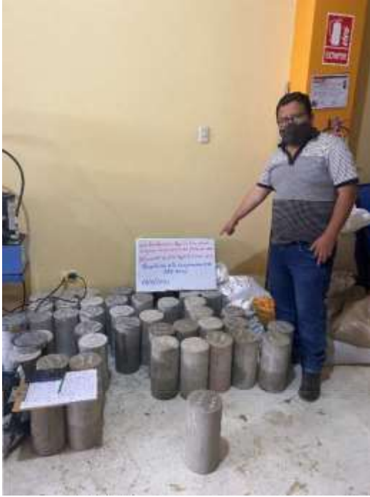
Ensayo de resistencia a la compresión del concreto f'_c = 245 \text{ kg/cm}^2 a los 28 días
