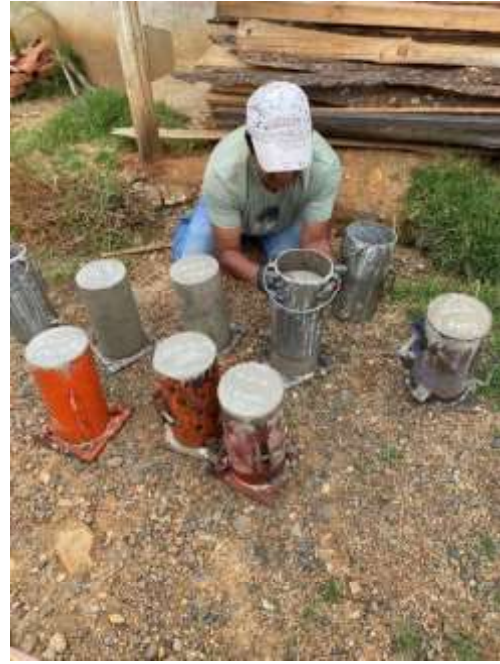
Moldeo, codificación y desmoldeo de probetas de concreto según dosificaciones pre-establecidas
