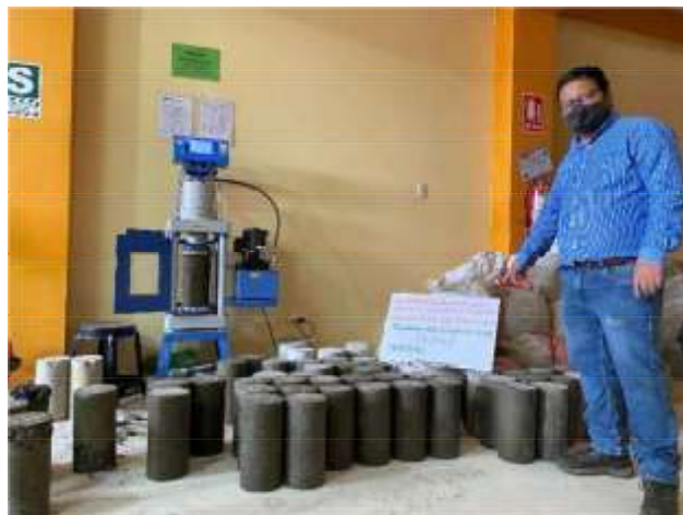
Ensayo de resistencia a la compresión del concreto f'c = 210 \text{ kg/cm}^2 a los 7 días
