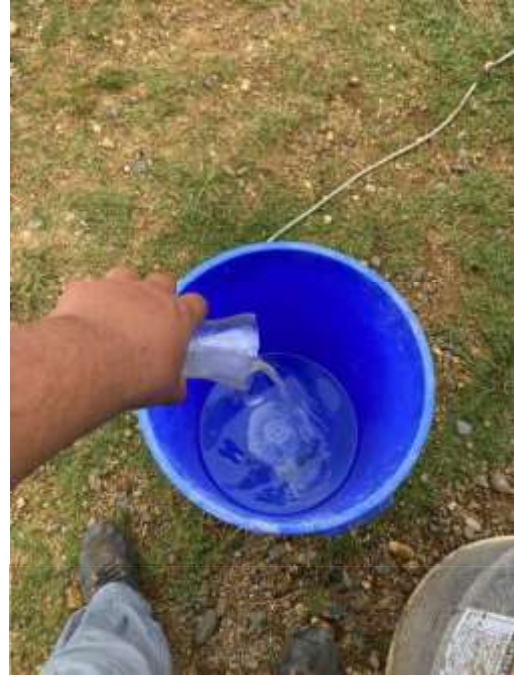
Preparación del agua para el concreto con la adición del extracto de Opuntia ficus y mucílago de Aloe vera
