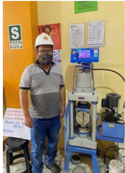
Ensayo de resistencia a la tracción del concreto f'_c = 245 \text{ kg/cm}^2 a los 28 días
