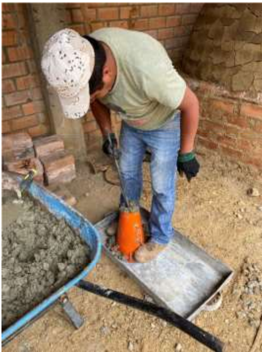
Ensayo de asentamiento del concreto con la adición de extracto de Opuntia ficus y mucílago de Aloe vera
