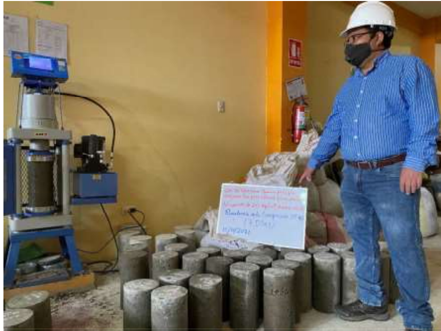
Ensayo de resistencia a la compresión del concreto f'c = 175 \text{ kg/cm}^2 a los 7 días
