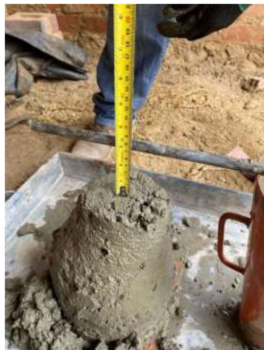
Ensayo de asentamiento del concreto con la adición de extracto de Opuntia ficus y mucílago de Aloe vera
