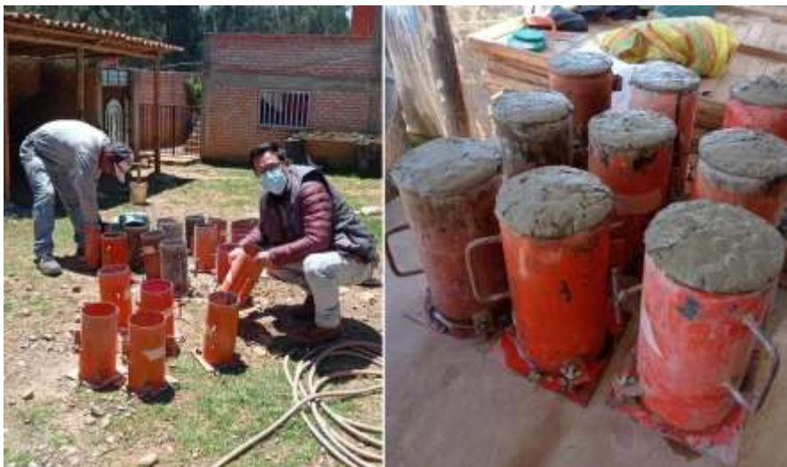
Figura 17. Vaciado de concreto en briquetas de medidas 0.15m x 0.30m. Fuente: Elaboración propia.
